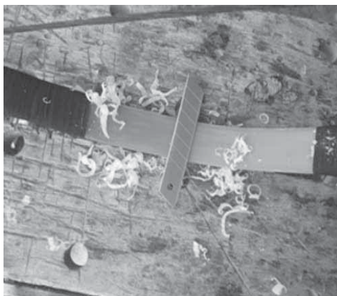
52. kép: Tillerezés során, a szaruréteg vékonyításával gyengítjük az erősebb oldal karját
