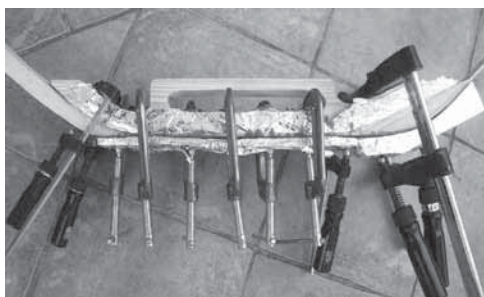
47. kép: Szarulemez felragasztása az íjmagra (vékonymagos, sablonos módszer)
