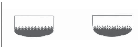
45. kép: Illeszkedő (matching grooves) és nem illeszkedő (non-matching grooves) fésülés 32
