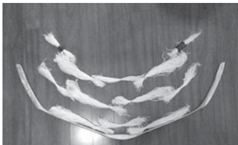
48. kép: Ínrétegek elvi felépítése (három rétegben, átfedéssel)
