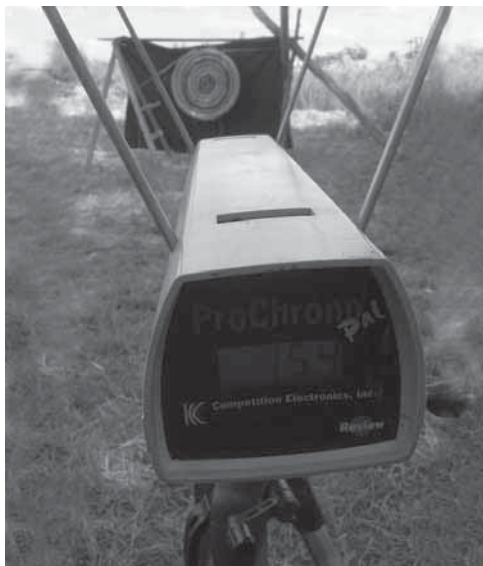
57. kép: Sebességmérő (ProChrono Pal Digital Chronograph)
