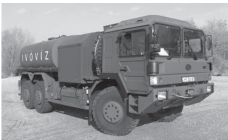
4. sz. kép RÁBA H-25 ivóvíz-szállító terepjáró tehergépkocsi 8 m 3 -es szállítóképesség 9
