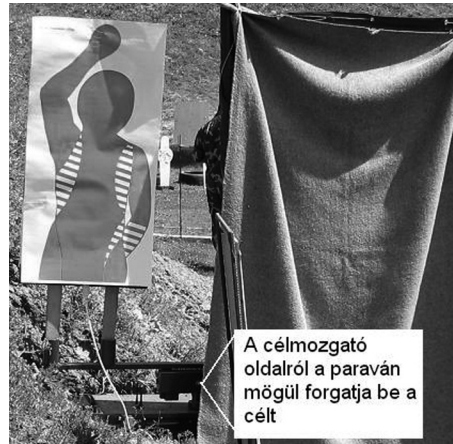
24. ábra A célmozgató, balra buktató jobbra forgató üzemmódban
