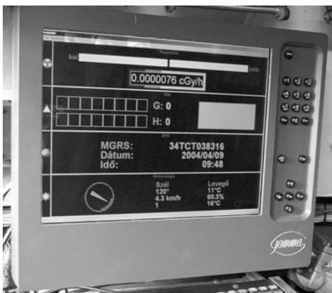
2. kép: IH-99L harcjármű fedélzeti adatgyűjtő (a felső sorban az IH-99, alatta a GID-3, a harmadik sorban a GPS, az alsó sorban a TVS-3 által mért adatok láthatók)
