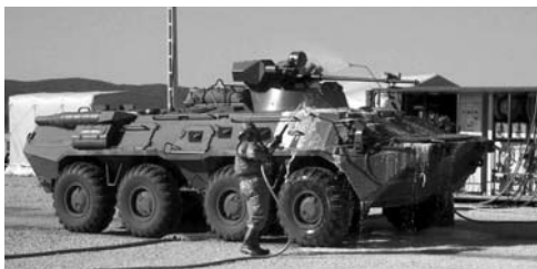
3. kép: BTR-80A harcjármű mentesítése DECOCONTAIN-3000 ELS mentesítő konténerrel (a mentesítő anyagot folyékony szappan helyettesíti!)
