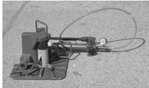
9. ábra. Kézi konténeremelő
