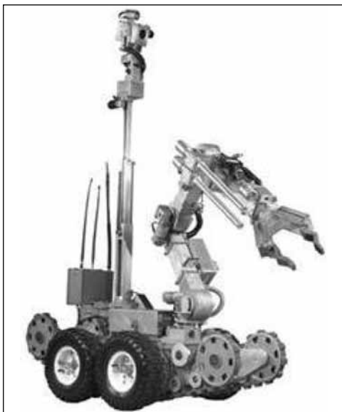
1. ábra. Az ANDROS F-6A nehéz tűzszerész robot 9
