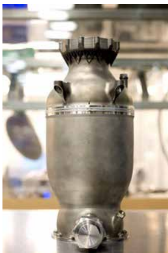
2. ábra. 3D nyomtatással készített folyékony oxigén beáramlását szabályozó szelep [8]
