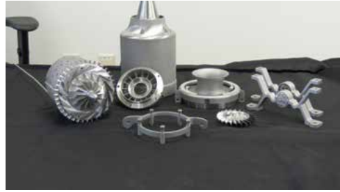
6. ábra. GE nyomtatott mini hajtómű alkatrészei [12]
