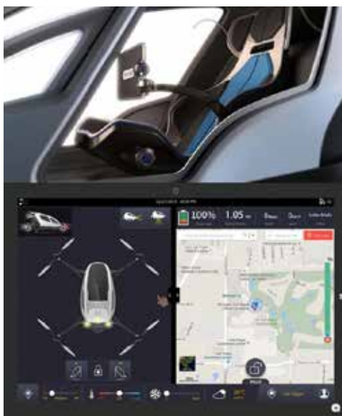
13. ábra. China Ehang184 személyszállító drón utasfülkéje és kijelzője [17]
