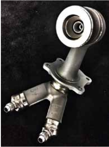
4. ábra. GE 3D nyomtatással készült üzemanyag-fűvóka a következő generációs LEAP hajtóműhöz [10]
