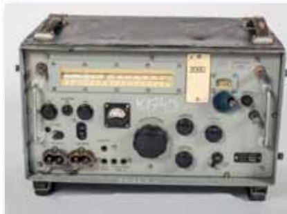
NV-1B I. osztályú, nehéz egységes vevő. A Standard Telefongyár gyártotta 1950 és 1954 között
