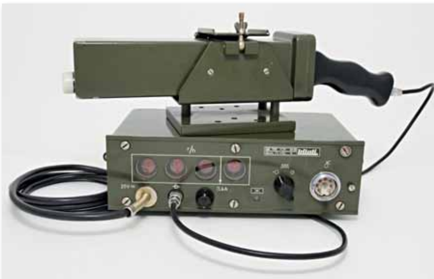
IH-31 járműfedélzeti sugárszintmérő műszer. 1962 és 1967 között 935 készlet készült belőle a Gamma Műveknél
