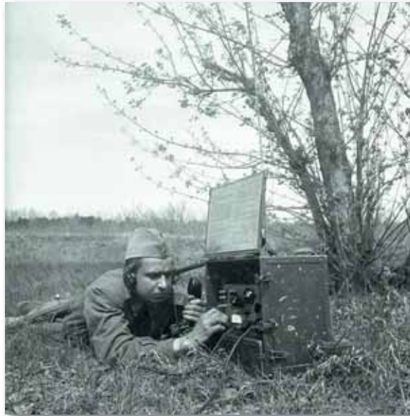
Katoná az 1950-es években az R-10-es URH rádió adó-vevő készülék egy módosított változatával. Az R-10-est a Standard Telefongyár gyártotta 1948 és 1952 között
