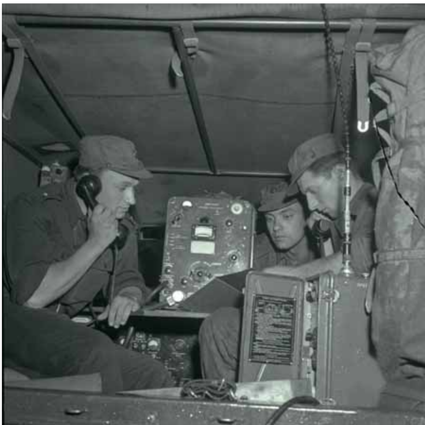
R-104 gépkocsi rádióállomás, a jobb oldalon R-105D URH rádió. Mindkettőt a Vadásztölténygyár gyártotta
