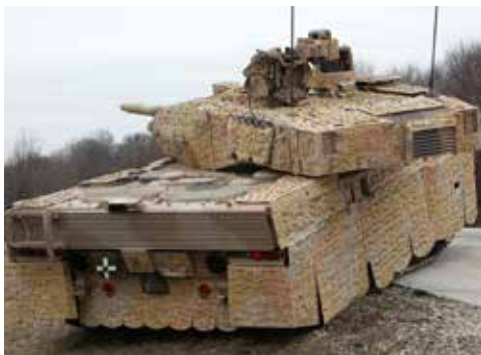
12., 13. ábra. Harcjárműre és gépjárműre telepített aktív álcázási rendszer
