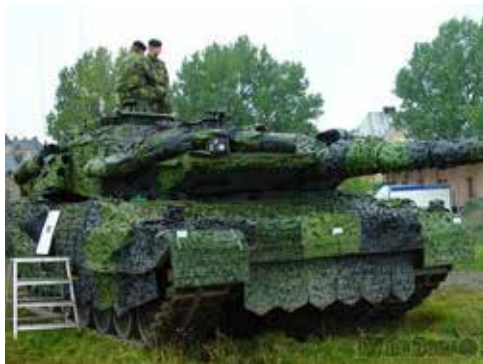
14., 15. ábra. A baloldalon a könnyen rögzíthető álcázó rendszer része látható, amelyet a svéd SAAB cég gyárt BARRACUDA néven, míg a jobb oldalon egy teljesen előkészített harcjárműről készült a kép https://defence.pk/pdf/threads/armata-russias-top-secret-battle-tank-captured-on-video.366780/page-2 (Letöltés: 2017.10.13.)
