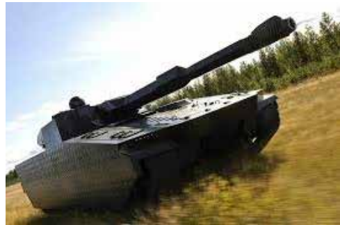
19., 20. ábra. A brit védelmi technológiai BAE Systems által gyártott, harcjárműre szerelhető adaptív (E-ink) eljárást alkalmazó „lopakodó-Stealth” álcázó rendszer https://hu.pinterest.com/pin/452400725038946340/ , (Letöltés: 2017.10.13.)
