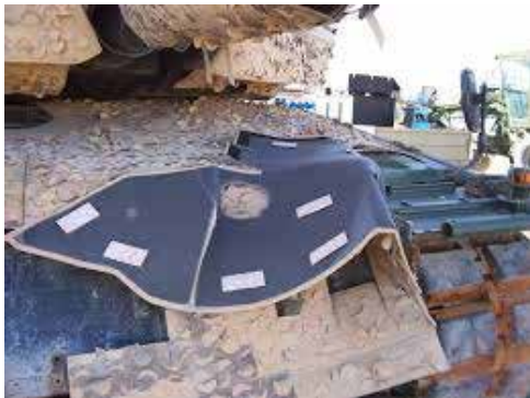
14., 15. ábra. A baloldalon a könnyen rögzíthető álcázó rendszer része látható, amelyet a svéd SAAB cég gyárt BARRACUDA néven, míg a jobb oldalon egy teljesen előkészített harcjárműről készült a kép https://defence.pk/pdf/threads/armata-russias-top-secret-battle-tank-captured-on-video.366780/page-2 (Letöltés: 2017.10.13.)
