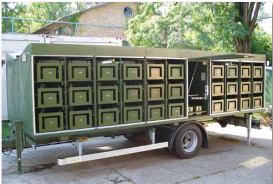
Mobil autonóm lőtéri készlet (MALK), egy 8 tonna teherbírású alvázon elhelyezett „hor-do-zható” lőtér (előre kiépített lőtéri infrastruktúrát nem igényel)
