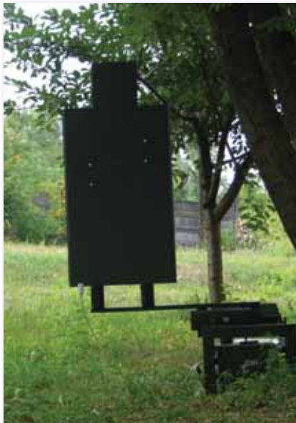
CBFR-08 mozgató- és buktatómotor, a MALK „lelke”. A bal oldali felvételen buktató (le és fel), míg a jobb oldalin célfordító üzemmódra van telepítve az eszköz
