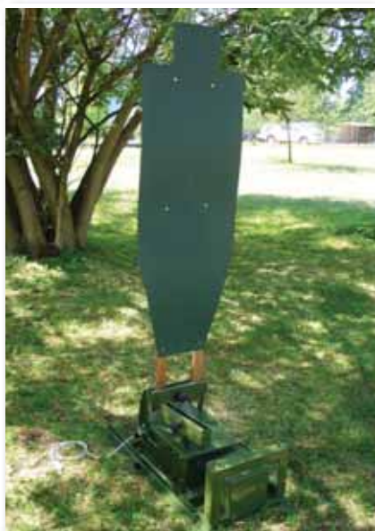
CBFR-08 mozgató- és buktatómotor, a MALK „lelke”. A bal oldali felvételen buktató (le és fel), míg a jobb oldalin célfordító üzemmódra van telepítve az eszköz
