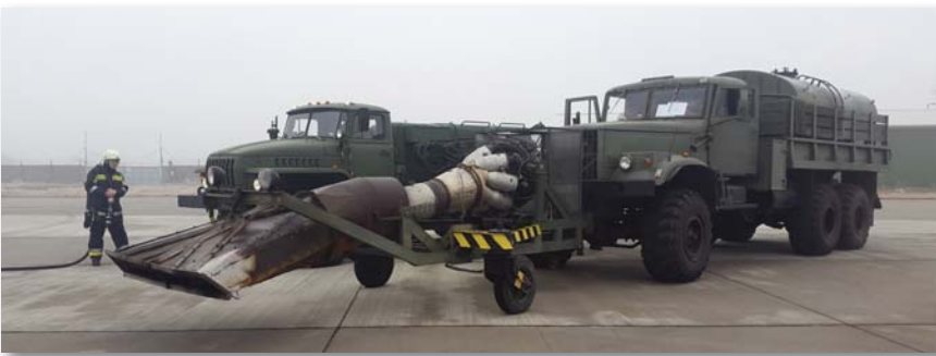
Reptéri jégolvasztó berendezés
