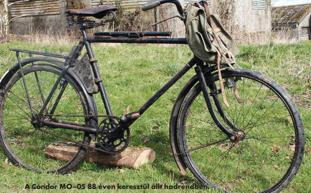
Az MO-05 hátsó kerékagya a Fichtel & Sachs gyártmánya.
