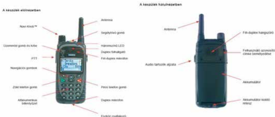
2. ábra. Az SRH3800 Sepura terminál elől-, illetve hátulnézeti képe (Forrás: TETRA kézi és mobil gateway terminálok használati útmutatója; MOD-06-376)
