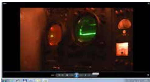
15. kép. Zavar SA-6 SzN 25 lokátor kutató és távolsági (kilométer) indikátorain
