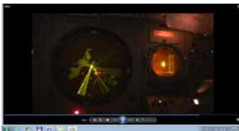
17. kép Szinkron zavar SA-6, SzRC lokátor IKO és ITC indikátorain
