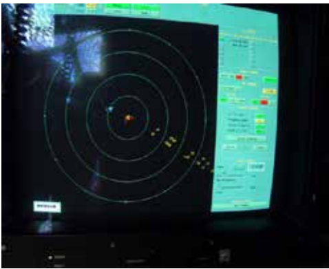
21. kép. MCP 118°-on szinkronzavar, célsorozatot eredményez
