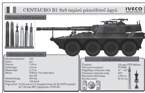
10. ábra. Az olasz IVECO cég által kifejlesztett CENTAURO B1 önjáró páncéltörő ágyú.
