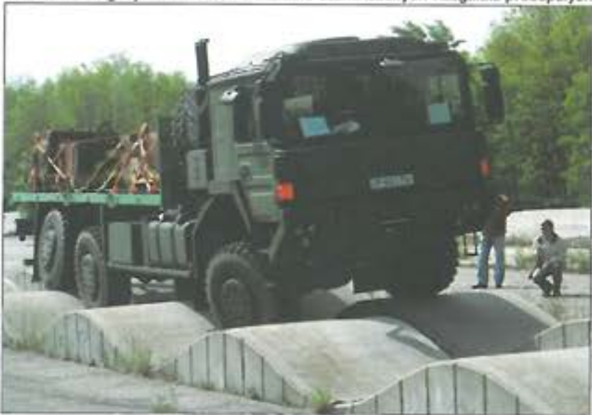
5. ábra. Valós igénybevétel során előforduló üzemviszonyok vizsgálata próbapályán
