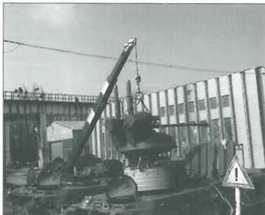
6. ábra. BTR-80A torony kiemelése a BTR-80MVJ emelődarujával
