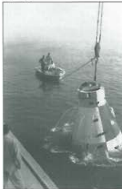
33. ábra. A Gemini űrhajó modelljével végrehajtott vízre szállási kísérlet
