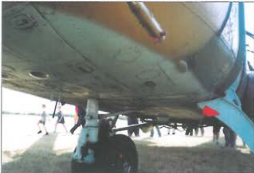
13. ábra. Szereőnyílások és IFF antenna a pilótafülke alatt (6220, Budaörs, 2003.07.06.)
