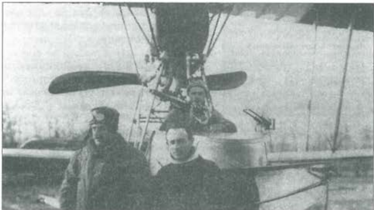
12. ábra. Olasz Machi L repülőcsónak és személyzete. A vízi repülőgép fegyverzete egy 25 mm-es FIAT ágyú és egy Villar-Perosa géppisztoly állványon a fedélzet bal oldalán
