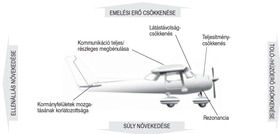
1. ábra A jegesedés repülőgépre gyakorolt hatásai
