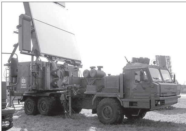
A 64L6 Gamma-Sz1 típusú felderítő rádiólokátor
