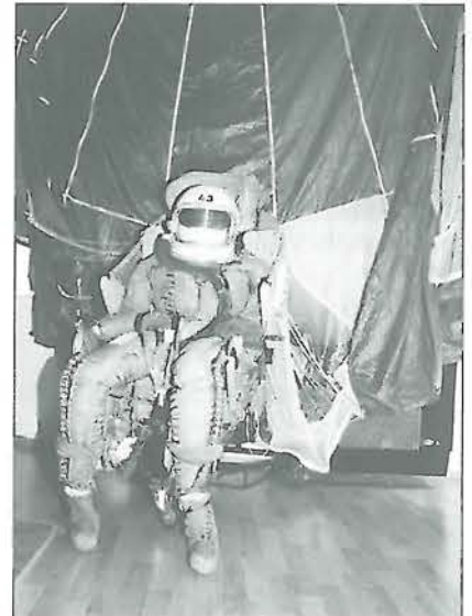
3. ábra. Az L-39 Albatrosz repülőgép katapultülésében egy magassági ruha GS-1-es sisakkal
