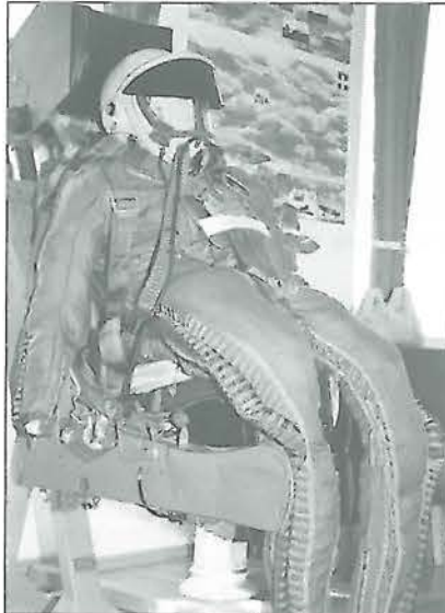
2. ábra. MiG-21UM típusú repülőgép katapultülése, VKK-1 típusú magassági ruha és GS-6 típusú hermetikus sisak
