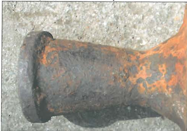
5. ábra. A hajtómű kiserelt főfűvókája
