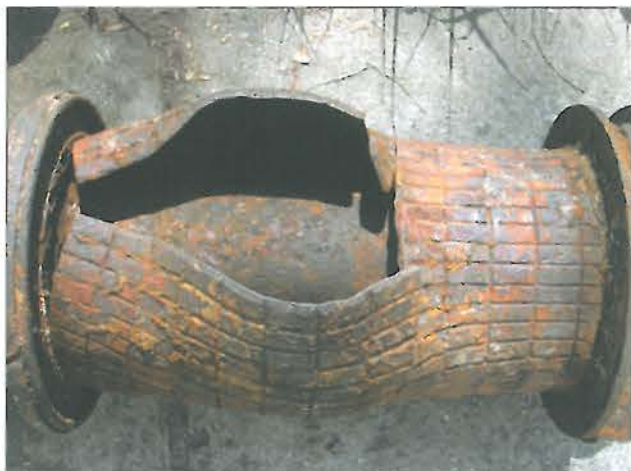
2. ábra. A robbanóanyag égése következtében belülről felhasadt repesztékű burkolat
