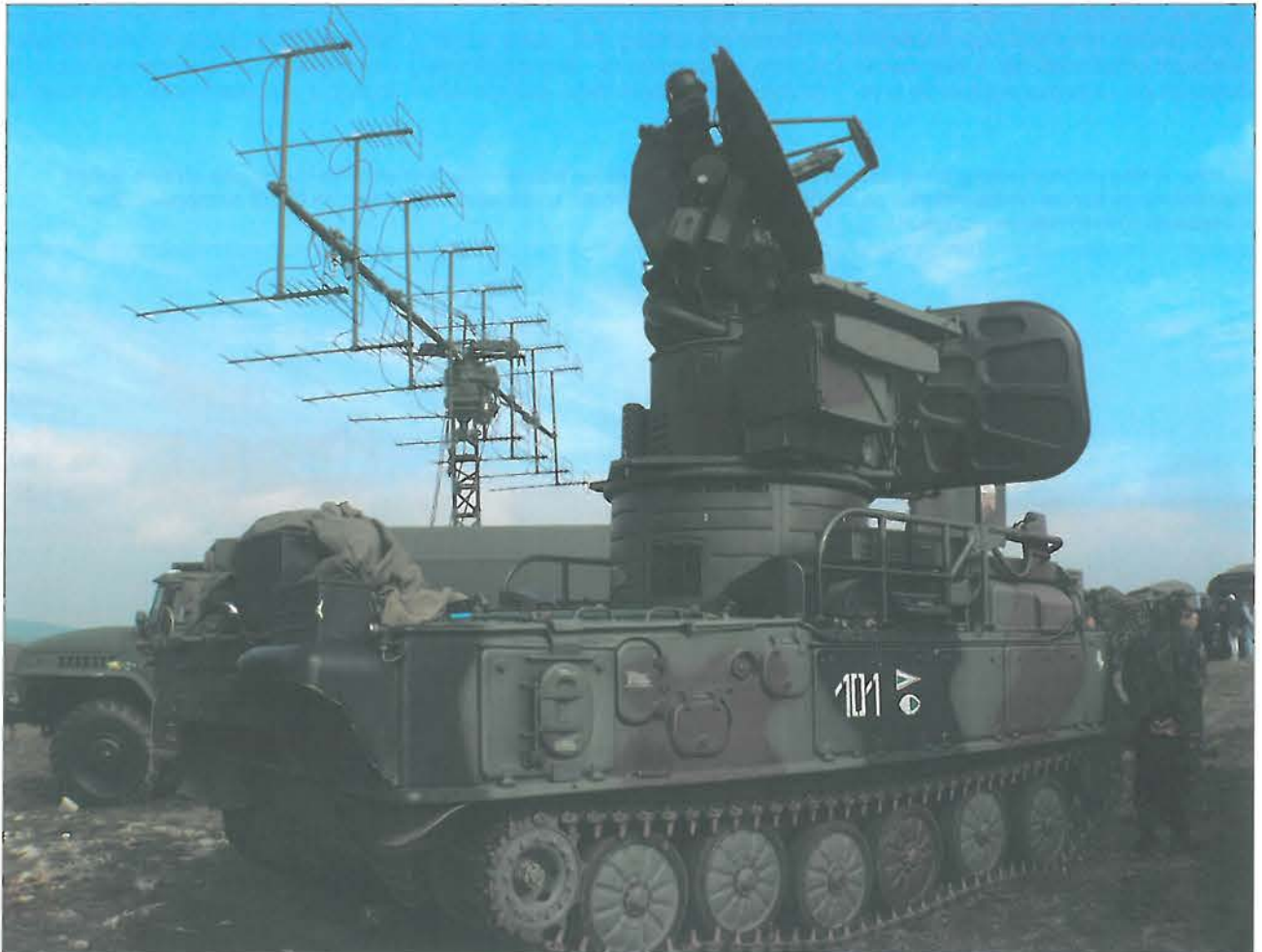
7. ábra. Az 1SZ91 önjáró felderítő és rávezető állomás háttérben egy P-18-as rádiólokátorral
