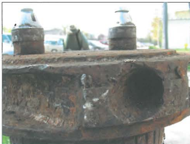
4. ábra. A fejtárcsa egyik forgató fűvőkája. Jól látszanak a süveget rögzítő csavarok
