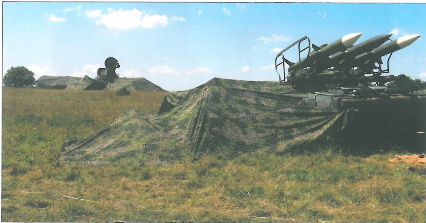
6. ábra. A Magyar Honvédség SA-6 Gainful (2K 12E Kub) légvédelmi rakétarendszerének 2P25 lánctalpas alvázra épített indítóállványa három rakétamakkal és az 1SZ91 radar és infravörös komplexuma 2008-ban az ELITE hadgyakorlaton a heubergi lőtérén Németországban
