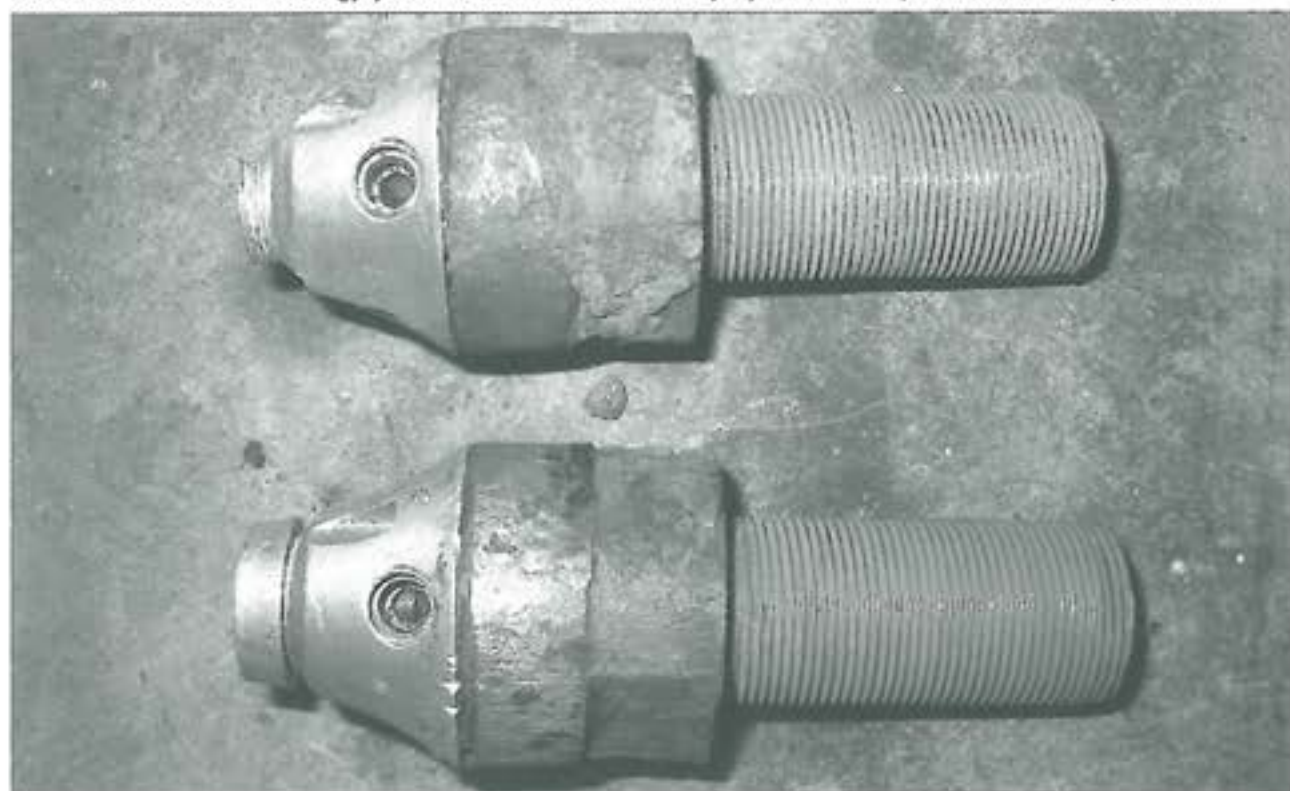
1. ábra. Kiszerezelt 36/81M Lidérc gyújtószerkezetek. Az oldalfuratok alján jól látszanak a pillanatműködés csapódótestei
