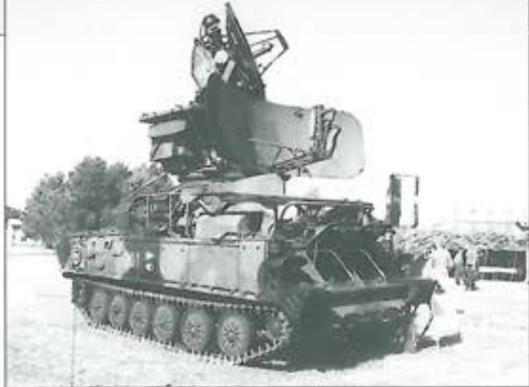
4. ábra. 1SZ 91 M1 Szurn típusú célfelderítő és -ravezető állomás (MH 12. Arrabona Légvédelmi Rakétaezred, Győr)
