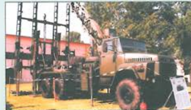
USZM-2 típusú cölöpverő hidépítő készletgépkocsi (MH 37. Műszaki Zászlóalj)
