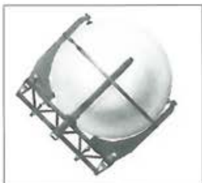
32. ábra. Tájfun-1Ju típusú radarkalibrációs hold (Kozmosz-1148)
