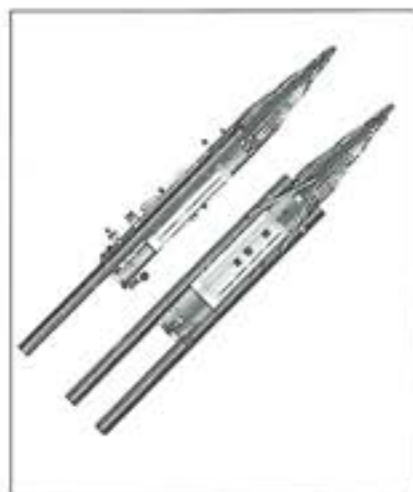
46. ábra. Rajz az amerikai haditengerészeti erők pozíciójának felderítésére alkalmas felderítő műholdról (USz-A, Kosmosz-102)
