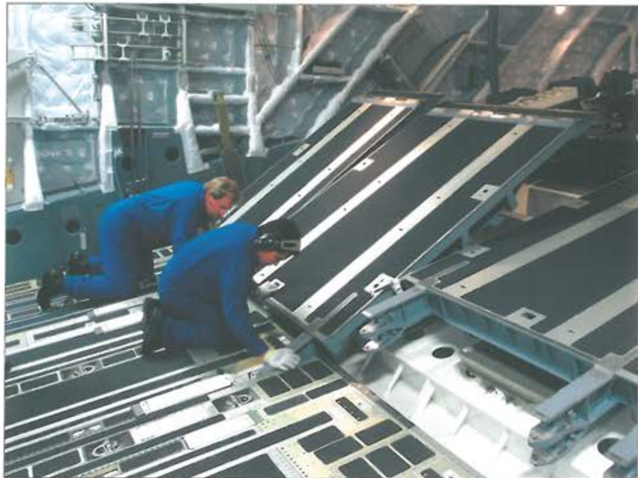
2. ábra. A far rakodórampa szerelése belülről
