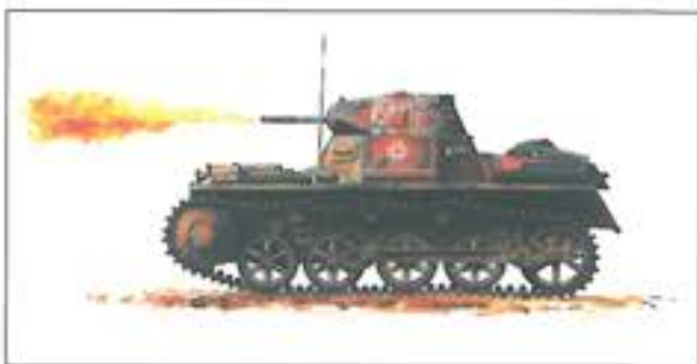
17. ábra. Panzer I Ausf. A lángszórós harckocsivá átépített változata, Afrika Hadtest, 5. harckocsiezred, Tobruk, 1941.
