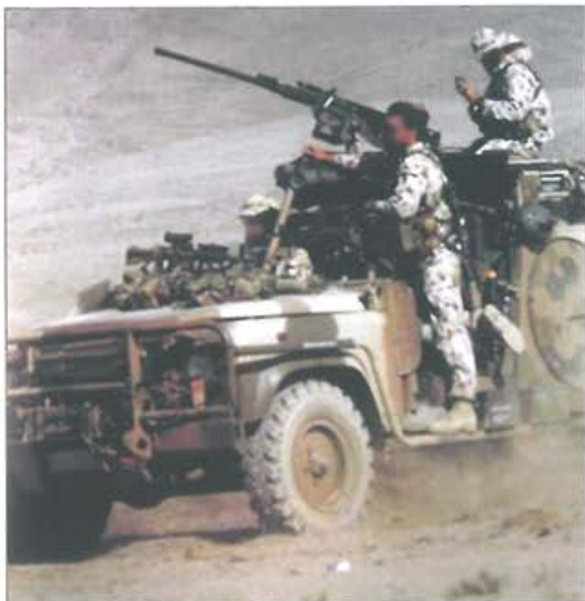
4. ábra. Ausztrál 6×6-os LRPV típusú harcjármű 12,7 és 7,6 mm-es géppuskával
