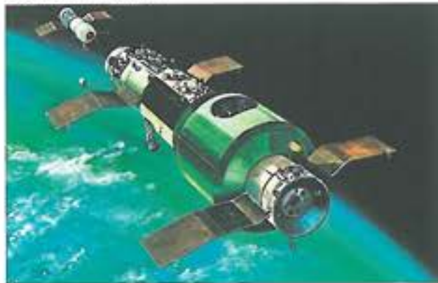
4. ábra. Szozuz űrhajó közeledik a Szaljut-1 űrállomáshoz. Az űrállomás hátsó részén a műszaki hajtóműegység helyezkedik el. (APN)
