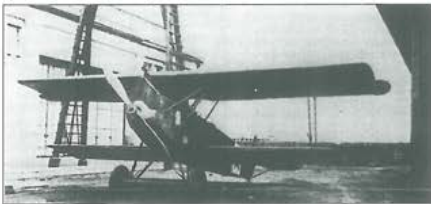
10. ábra. Bár a MÁG-gyártású gépeket a kései Fokker-gyártású D.VII-es alkatrészekből szerelték össze, különböztek is tőlük. A Daimler motor részére kialakított felső motorburkoló lemez és a szögletes alakú hűtőlevegő-beömlő nyílás volt a MÁG-repülők egyik ismérve
