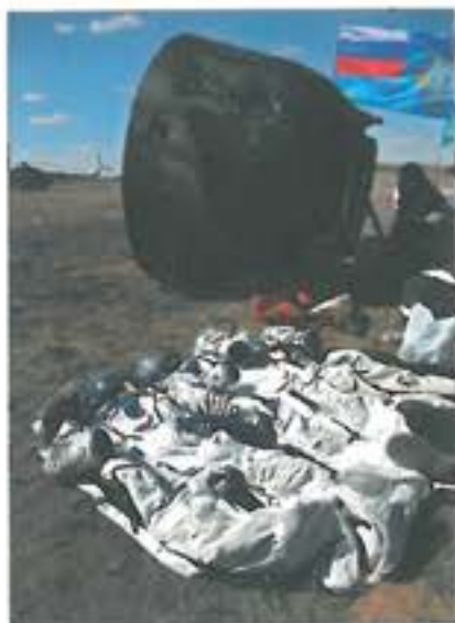
3. ábra. A Szozuz TMA típusoknál a leszállás után eldöntik az űrkabint, hogy a személyzetet könnyebben kijuttassák (NASA)
