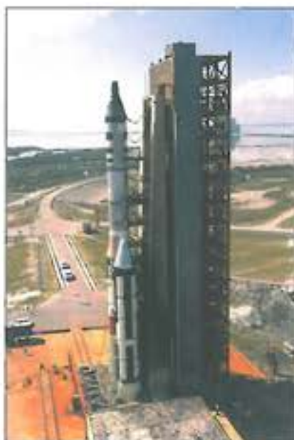
8. ábra. A MOL-űrállomás makettje a Titan-III C rakéta tetején. A Gemini űrkabin szuborbitális pályán visszatért, a többi rész OV 4-1 összefoglaló kódnéven keringett a Föld körül. (USAF)
