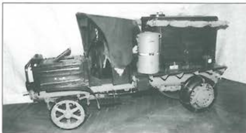
2. ábra. A Büssing vízszállító teherautó modellje hóolvasztóval is felszerelve a Monarchia hadseregében az első világháború alatt
