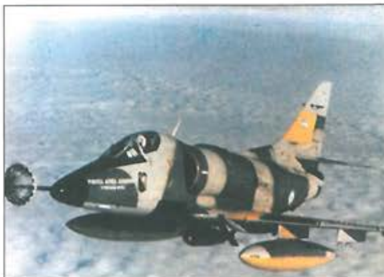
14. ábra. Egy 1000 fontos Mk.17 bombát hordozó A-4C repülőgép légi utántöltés közben (AL)
