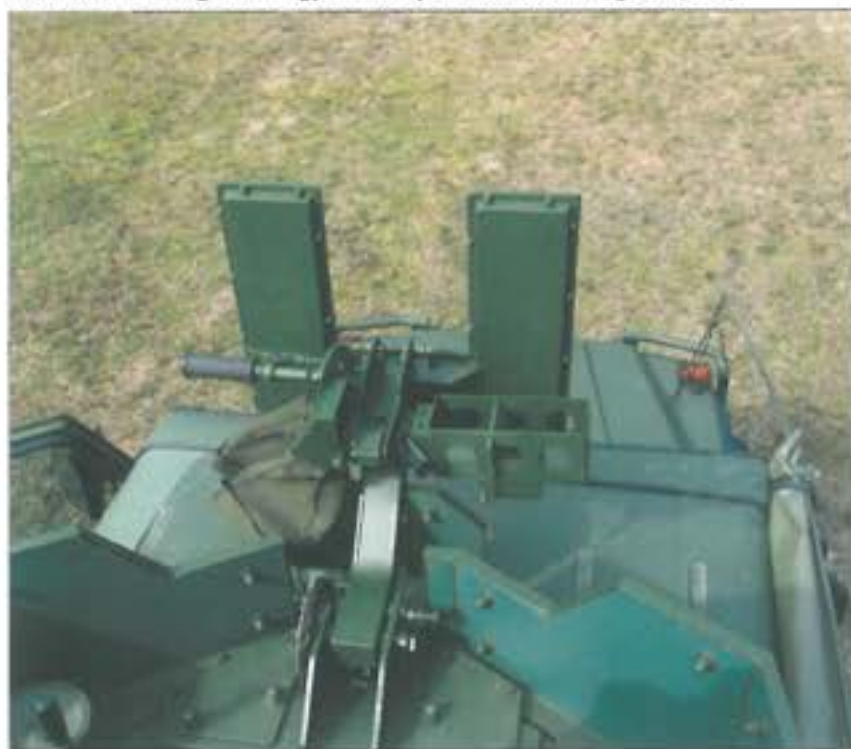
4. ábra. UMF-2 forgatható fegyverállvány a lövész szemszögéből (H. F.)
