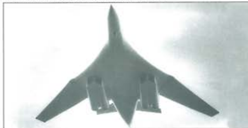
34. ábra. Jól megfigyelhető a hajtóművek elhelyezése
