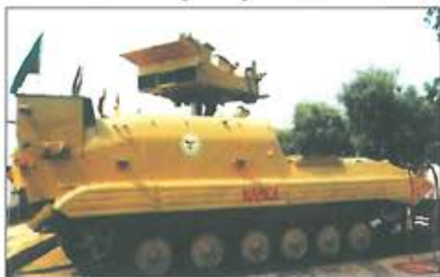
16. ábra. Ezen az indiai változatú BMP-2-esen jól látható a felépítményből kiemelt NAG páncéltörő rakéta indítóállvány a cél felderítését és befogását végző berendezésekkel
