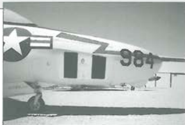
4. ábra. A Cougar felderítő változatának oldalra néző kamerái
