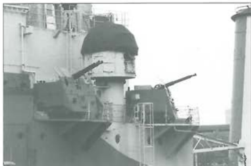
7. ábra. Kétfőtös 4 cm-es ikercsővű légvédelmi gépágyú
