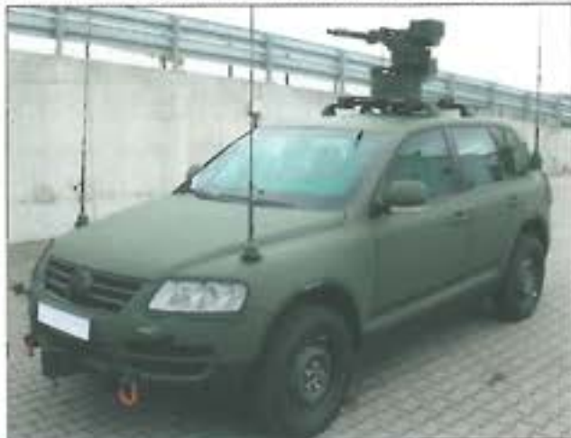
3. ábra. A Touareg-Military változat távirányított géppuskával
