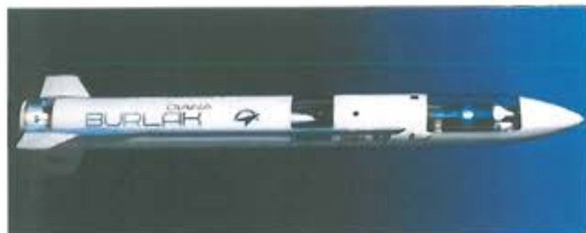
26. ábra. Demonstrációs példány, orr-résznél a plexire cserélt burkolat alatt látható a „teherter”: itt helyezték volna el a kis tömegű műholdat
