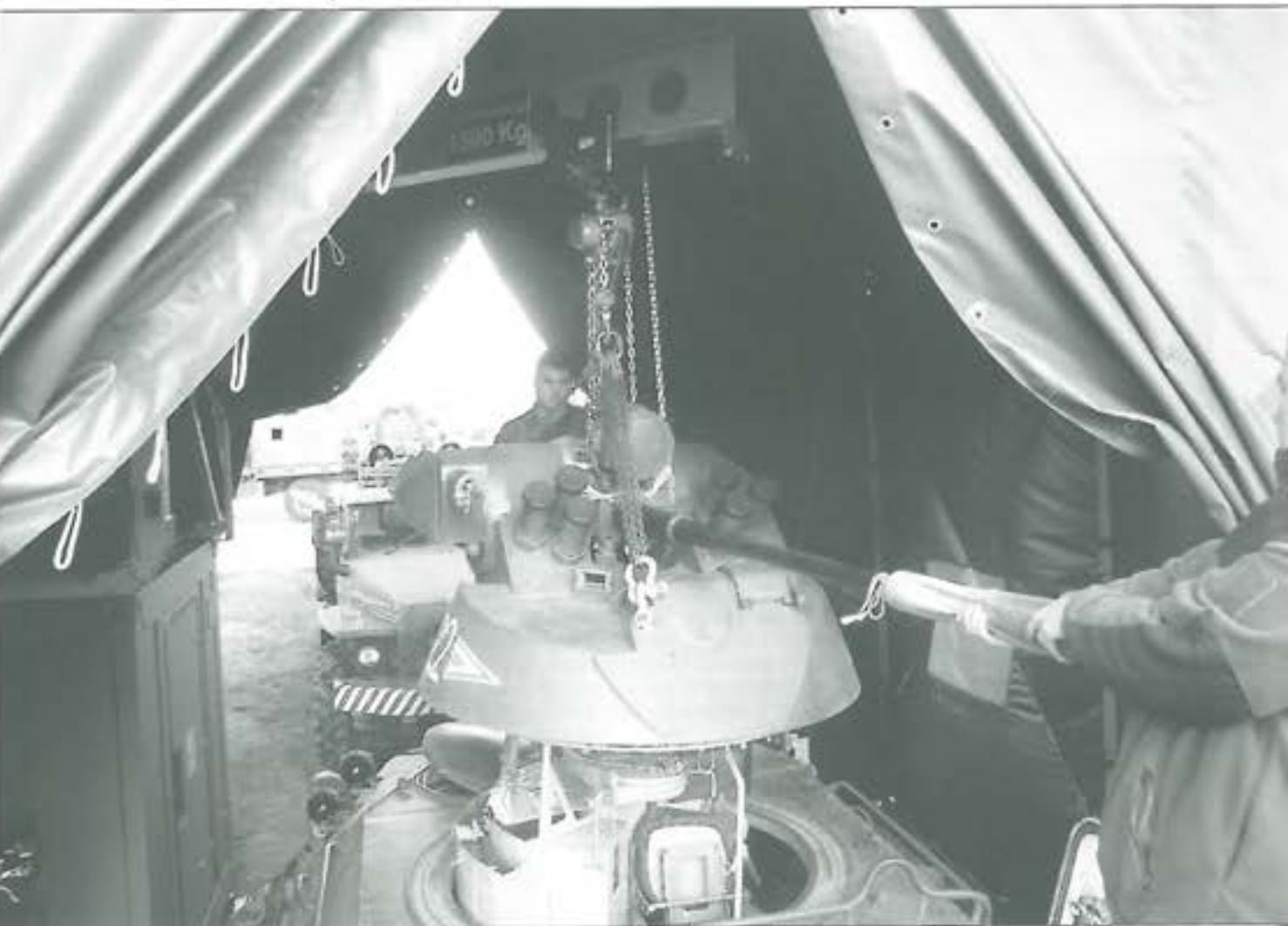
10. ábra. A BTR-80A torony beemelése 1,5 t teherbírású emelődarúval
