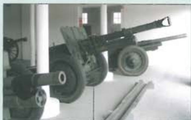
20. ábra. Szovjet M.37 105 mm-es vontatott tarack, finn változatban M/61 típusú
