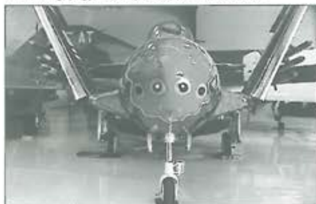
7. ábra. A gépágyúk elhelyezése a Panther orrában
