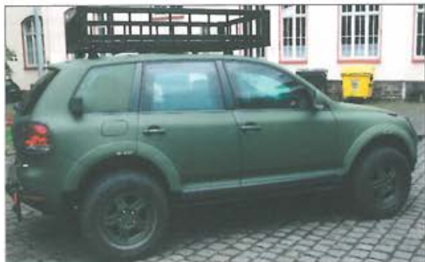
2. ábra. Az utólag felszerelt csomagtartó üzemanyagkannák szállítására is alkalmas
