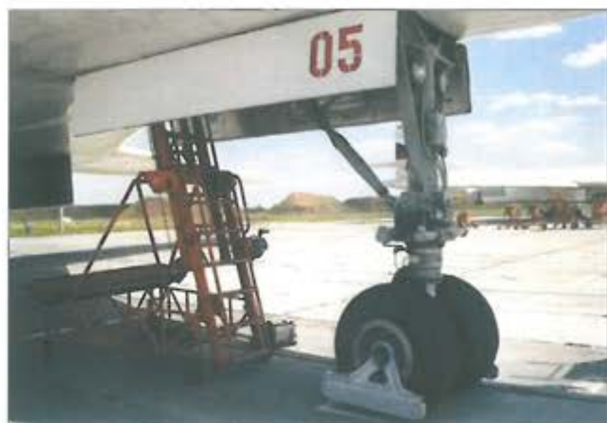
29. ábra. Az orrfutóakna a személyzet létrájával
