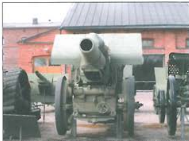
9. ábra. Régi német 210 mm-es tarack valószínűleg 1916-ból, L/14-es csővel
