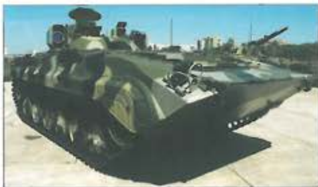
14. ábra. Ezen a kiállított tűzérségi felderítő változaton megfigyelhetők a nyitott fedélű optikai kereső- és felderítőberendezések, illetve a torony hátsó részéből kiemelt Tall Mike-felderítő radar
