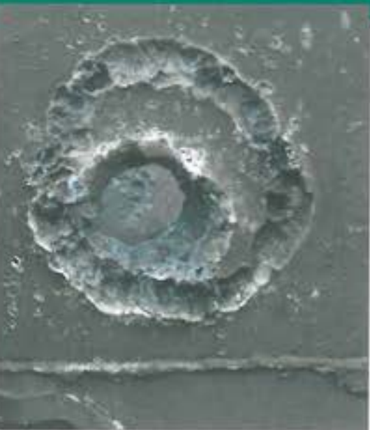
4. ábra. Az átütés bemeneti oldala a gyűrű alakú benyomódással
