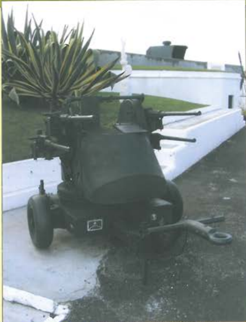
2. ábra. 12,7 mm-es Browning géppuskák felhasználásával kialakított M45 „Quadmount” légvédelmi komplexum. Az eszközről hiányoznak a löszertartó konténerek
