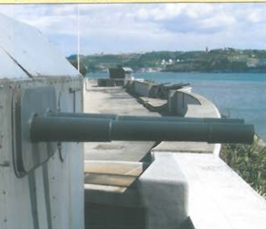
3. ábra. Ikercsövű, elektromos meghajtással forgatott, páncéltoronyba épített „unoka” a 20. század közepéből
