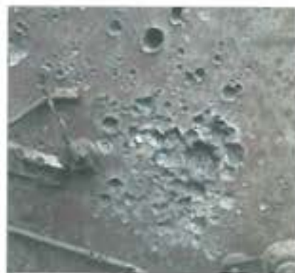
6. ábra. A harckocsiteknő szemközti felében keletkezett becsapódási kráterek
