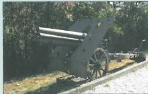
24. ábra. Osztrák-magyar 1916.M típusú 10 cm-es hegyi tarack előretolt csővel
