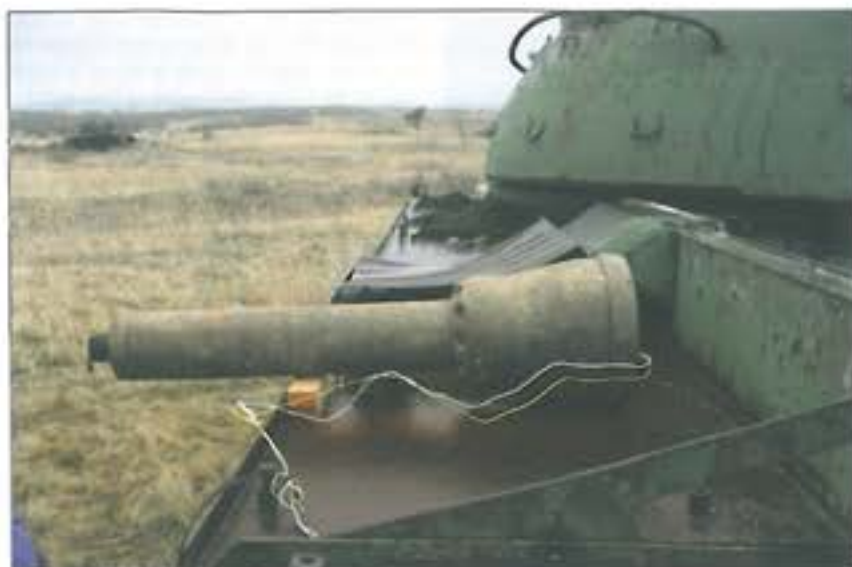
2. ábra. A robbantási próba a töltet eltartási távolságának megfelelően a céltárgyra merőleges helyzetben történt
