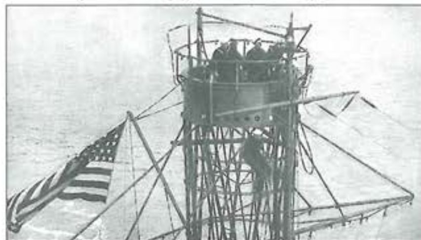
9. ábra. A korai amerikai csatahajókra jellemző rácsos („lattice”) árbocok és az azok tetején kialakított megfigyelő állások (USS UTAH)[18]
