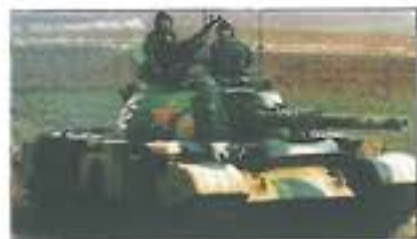
20. ábra. A Type 69-IIIB könnyen felismerhető a két antennáról
