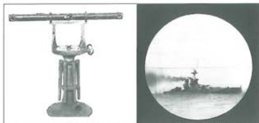
16. ábra. A haditengerészeti távmérő (Naval rangefinder) harmadik példánya, vízszintes és függőleges szögben mozgatható állványon, előlről nézve. Látható a két tükröt (pentaprizmát) védő üveglapok, valamint közepén a beállítótávcső objektívje. A jobb oldali ábra egy tipikus, a távmérőn keresztül látható képet kíván ábrázolni (történetesen az HMS Iron Duke csatacirkáló). Ez a kép valójában montázs, a távmérő okulárja nem volt alkalmas fényképek készítésére. 16
