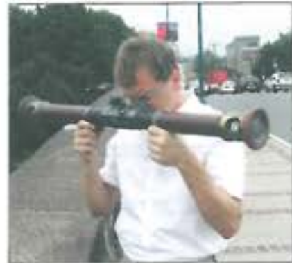
17. ábra. Néhány működőképes állapotban fennmaradt korai Barr & Stroud-táv mérő, és annak kézi használata. 19 A 45 fokba állított kétokuláras nézőke (lásd a jobb oldali képet) szintén BS-szabadalom, amely nagyban megnövelte a kényelmes kezelést. Ugyancsak BS-találmány maga az okulárokról helyezett, a külső fény hatását csökkentő gumiból (kaucsukból) készített szemkagyló is. 20
