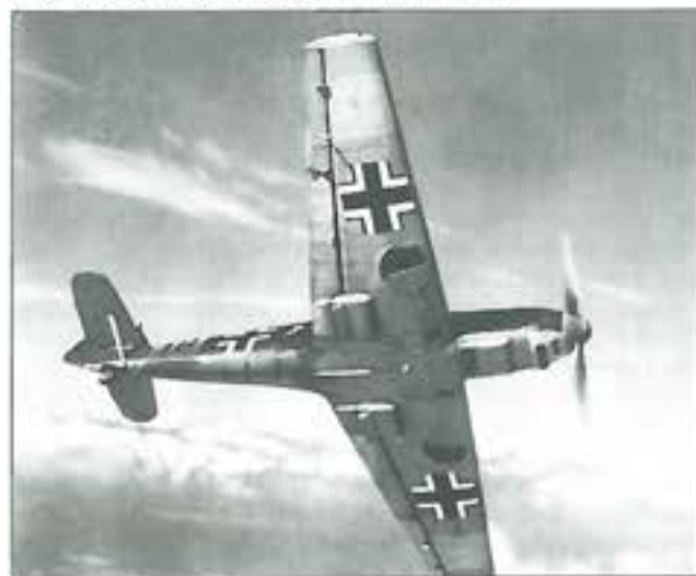
24. ábra. A Me 109 E hűtőzsaluja a szárny alatt
