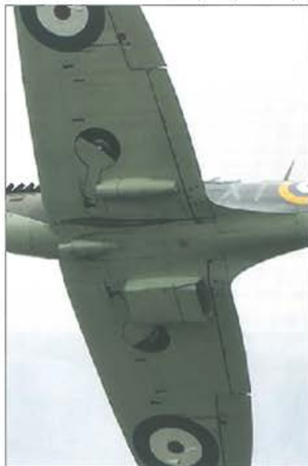
18. ábra. Réseletlen kisméretű leszállólélapok a Spitfire szárnyán
