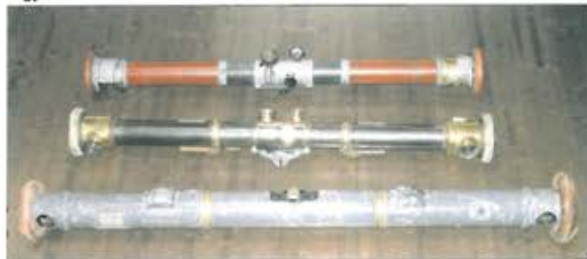
17. ábra. Néhány működőképes állapotban fennmaradt korai Barr & Stroud-táv mérő, és annak kézi használata. 19 A 45 fokba állított kétokuláras nézőke (lásd a jobb oldali képet) szintén BS-szabadalom, amely nagyban megnövelte a kényelmes kezelést. Ugyancsak BS-találmány maga az okulárokról helyezett, a külső fény hatását csökkentő gumiból (kaucsukból) készített szemkagyló is. 20
