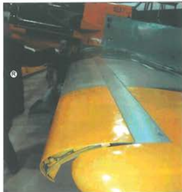
16. ábra. A Me 109 előszárnya kinyitott helyzetben
