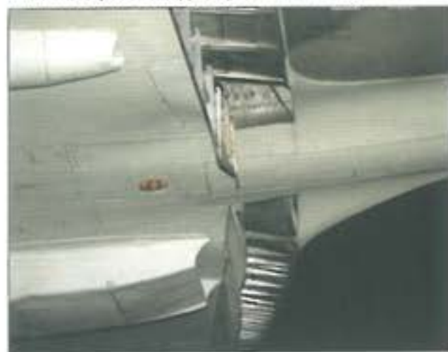
15. ábra. A Spitfire féklapjai teljesen kitérített helyzetben
