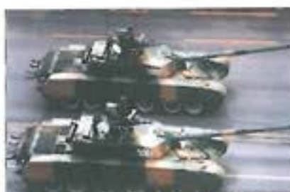
30. ábra. Type 96 harckocsik az 1999-es pekingi díszszemlén. Fentről jól látható a torony első részének moduláris felépítése
