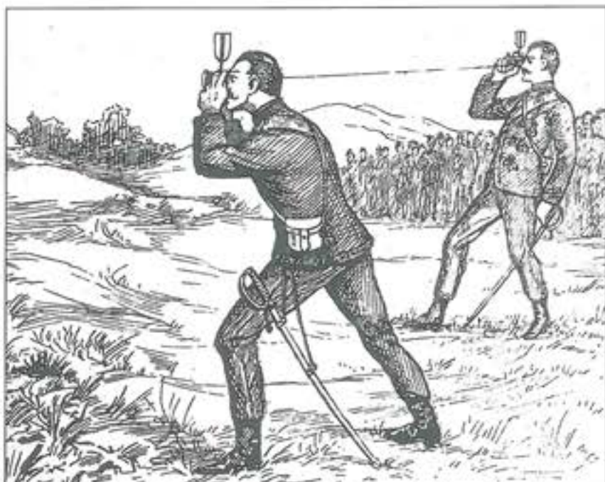
13. ábra. A mekométer működés közben', és a háromszögeléses mérés elve
