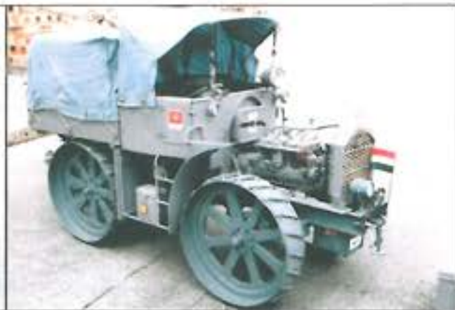
5–6. ábra. A győri gyártású 17.M vontató 100 LE-s motorral, amelyet Titannak neveztek
