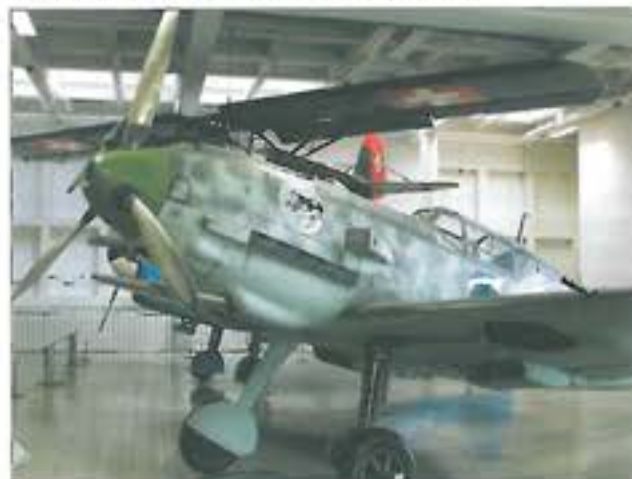
32. ábra. A Messerschmitt keskeny nyomtávja
