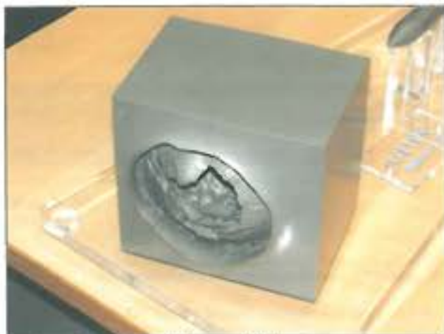
15. ábra. Az EFP lövedék becsapódási nyoma a lövedékcsapdában
