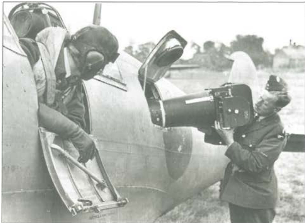
36. ábra. Kamera beszerelése egy PR-fotófelderítőbe
