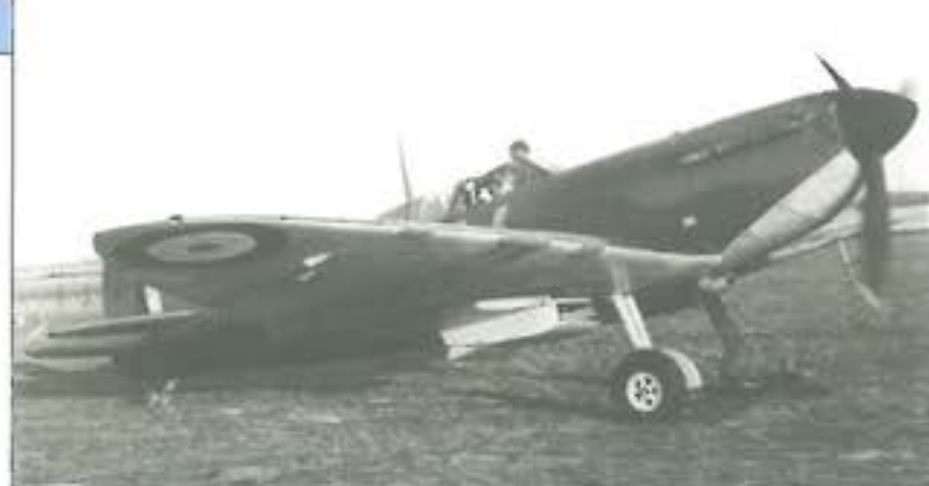
28. ábra. A Spitfire keskeny nyomtávja
