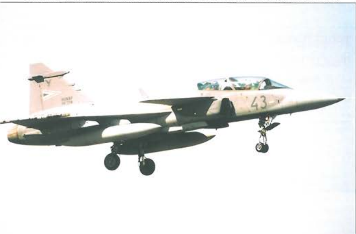
1. ábra. JAS-39 D (43) vadászgép 2 db 1275 literes póttartállyal, 1 db AIM-9 levegő-levegő rakétával (gyakorlati változat)
