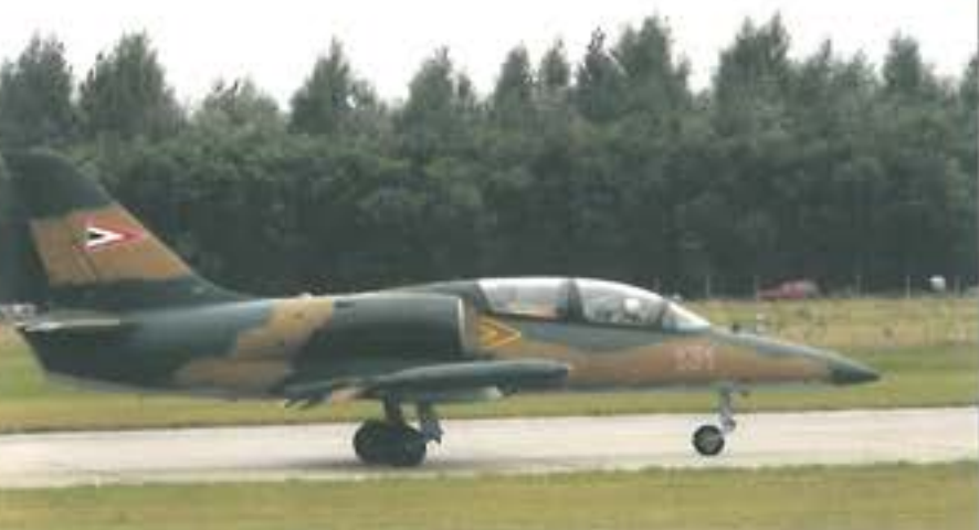
7. ábra. A 134-es oldalszámú L-39ZO Albatros nagyjavítás utáni terepfestéssel. A felfüggesztőpontokon már rakétafegyverzetet is lehetett hordozni
