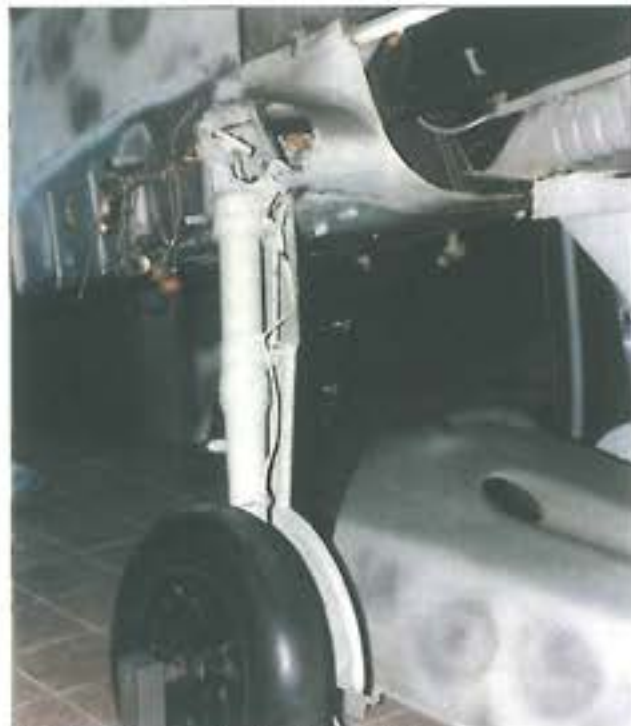
34. ábra. A Messerschmitt futóműbekötése
