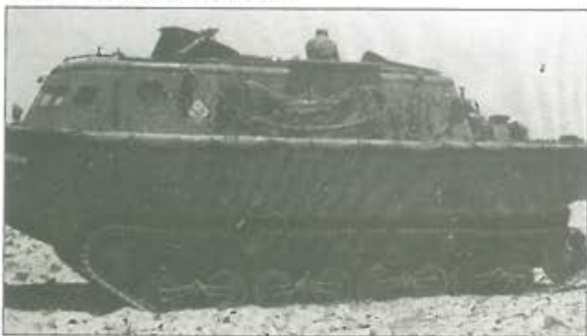
4. ábra. Az LWS egyik későbbi példánya kipróbálás közben. A zárt küzdőtérben utazók és a motor levegőellátásáért a jármű tetejére épített beömlőnyílás felelt. Az LWS oldalán elhelyezett szerszámok érzékeltetik, hogy ezt a járművet vontatásra és hidászfeladatokra szánták
