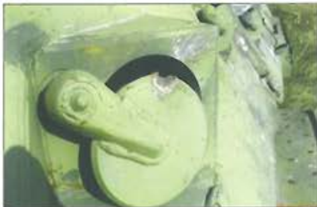
11. ábra. A BTR páncélszánán 20 mm-es páncéltörő lőszer becsapódásának nyoma. A célyagnak szánt kiselejtezt BTR-80 típusú gépjármű 800 méter távolságban volt kihelyezve
