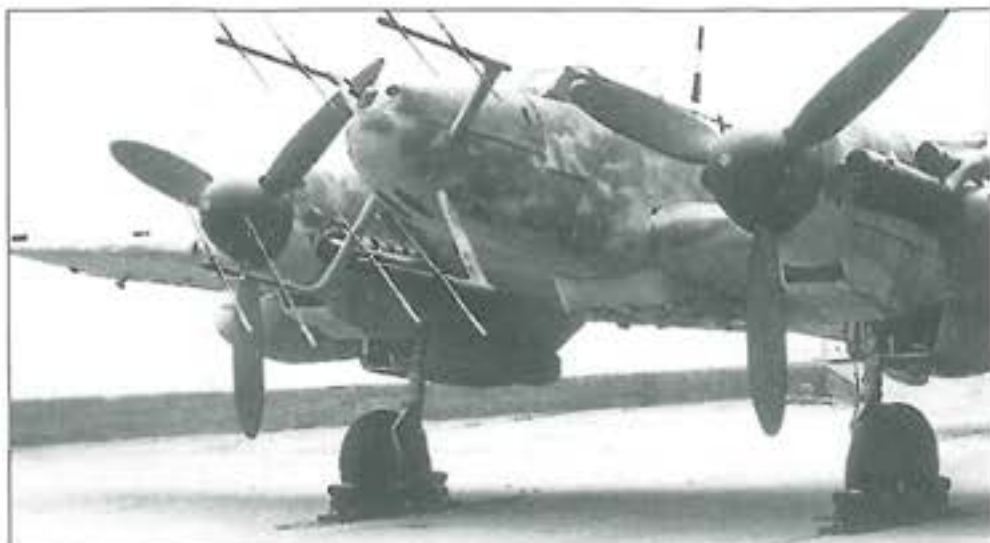
2. ábra. Messerschmitt Bf 110G6R-3 repülőgép, orrán a FuG 220 Lichtenstein SN-2 antennával
