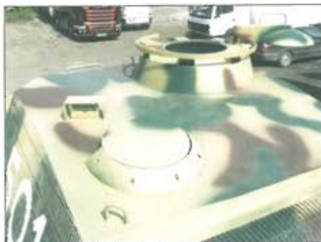
7. ábra. A torony felső „páncéllemeze” a szellőzés toronyon kívül, páncélozott részével, a töltőkezelő periszkópjával és a parancsnoki kupolával, azon a légvédelmi géppuska vezetősinjével
