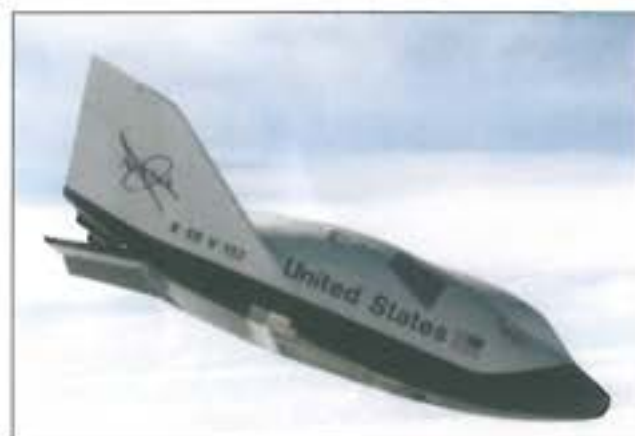
7. ábra. Az X-38-as CRV (személyzet-visszaszállító jármű) egyik sikeres próbája során. Habár az űreszköz szinte teljes egészében elkészült és kipróbálták, használatától a NASA mégis eltekintett
