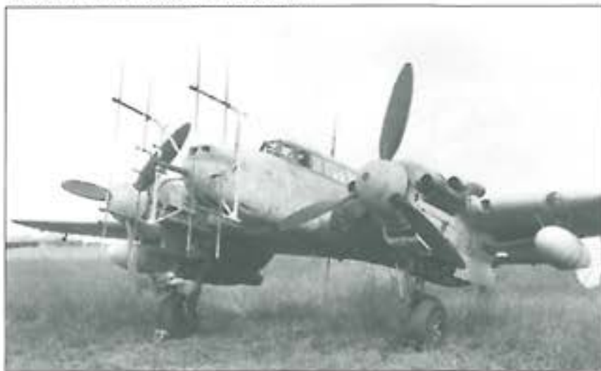
5. ábra. Messerschmitt Bf 110G4b FuG 212 Lichtenstein C-1 és FuG 220 Lichtenstein SN-2 lokátorokkal felszerelve
