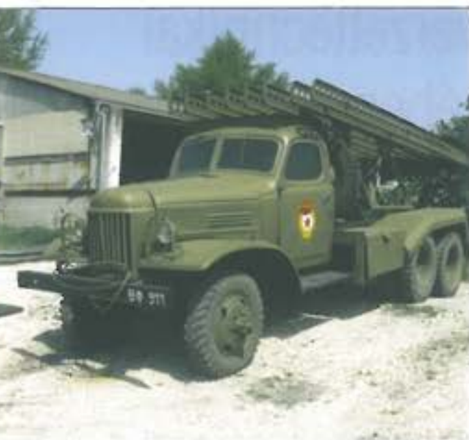
8. ábra. A szovjet gárdahadosztály jelvényével ellátott, ZIL 157 gépkocsialvázra szerelt Katyusa sorozatvető
