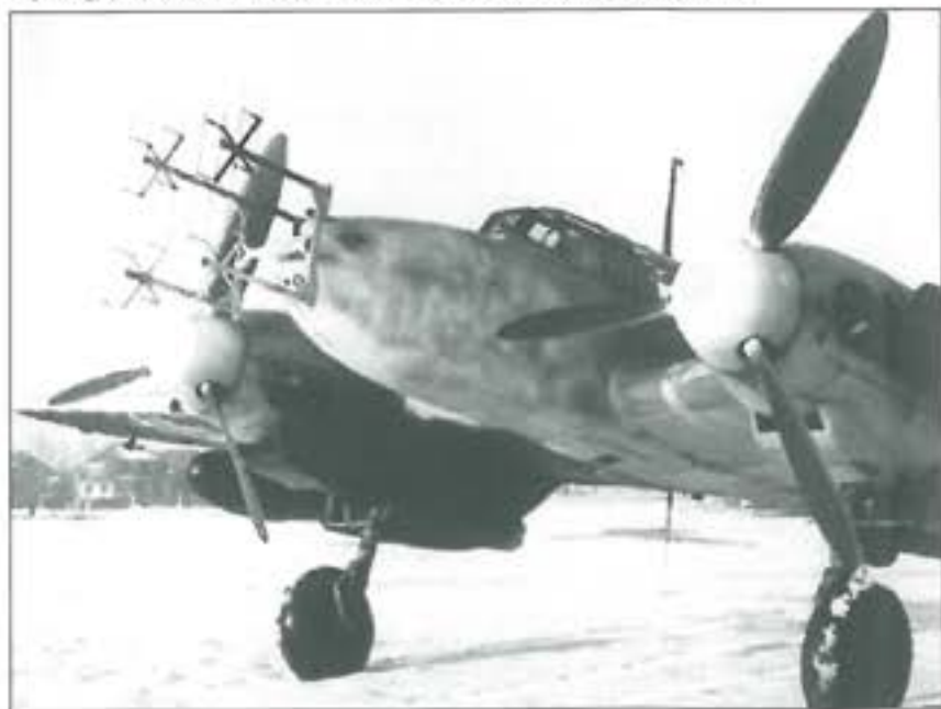
1. ábra: Az 1944. március 15-én Svájcban leszállt Messerschmitt Bf 110G repülőgép, az orrán a FuG 202 Lichtenstein BC lokátor antennával
