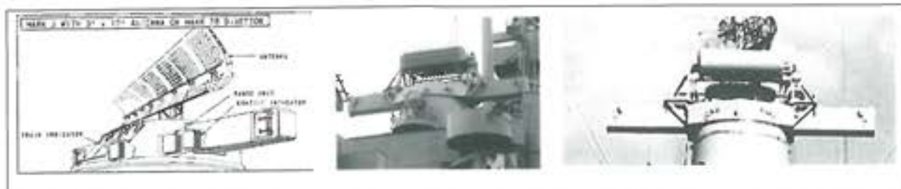
38. ábra. Az Mk 38-es irányzótorony Mark 3, Mark 8 (itt hátsó tűzvezető állásban) és Mark 13 Mod radarokkal kiegészítve.
