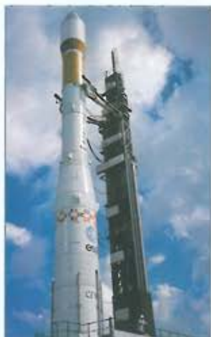
19. ábra. Az Ariane-MR méretarányos makettel végezték el a szükséges földi próbákat, méréseket (ESA)
