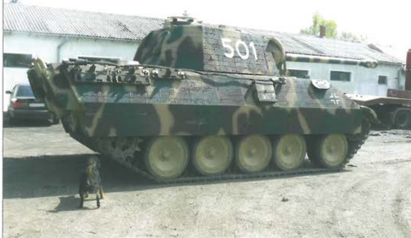
3. ábra. Az utánzat hátsó meghajtókereke és a kerékosztás a páncéleteknő szovjet eredetére utal, a VT-55 alvázra, melyeket – részben – jótékonyan rejt a kötényezés
