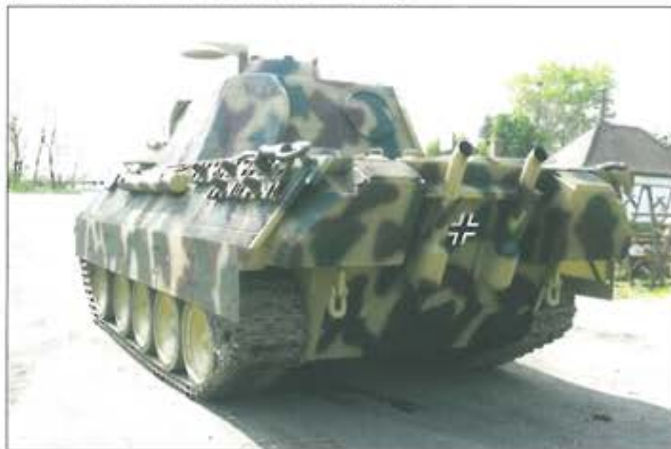
4. ábra. A kép a változatnak megfelelő elrendezésű, alul a teknőből kilépő nyílásoknál páncélozott kipufogókat, a csőtisztító bal oldalon elhelyezett tartóhengerét, valamint a „zimmerit” bevonattal ellátott szerelvényes ládákat mutatja
