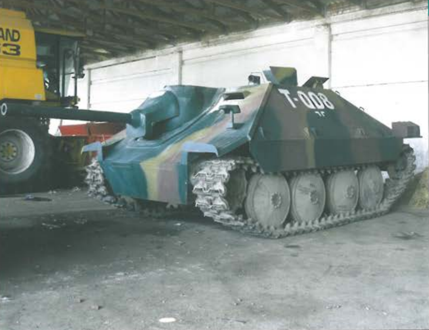
5. ábra. A most már arányos szélességű futóművel szerelt Hetzer
