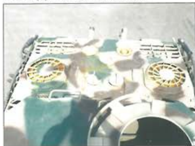
7. ábra. A torony felső „páncéllemeze” a szellőzés toronyon kívül, páncélozott részével, a töltőkezelő periszkópjával és a parancsnoki kupolával, azon a légvédelmi géppuska vezetősinjével
