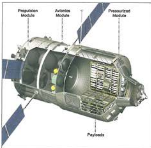
22. ábra. Az ATV röntgenrajza
