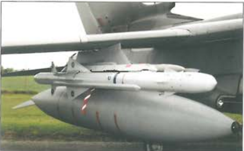
5. ábra. RAF Tornado GR.4 ZA472; ALARM rakétával (belül ASRAM AIM-132) és 1500 literes póttartállyal
