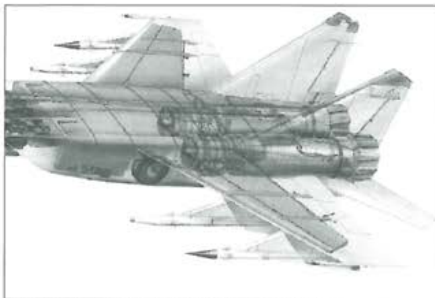
11. ábra. A sárkányszerkezetben kialakított keszontartályrendszer
