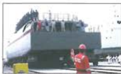
4. ábra. Az ARC TFEIM JUAN RICARDO OYOLA VERA (613) vízre bocsátásakor. A hajótól alatt jól látszik a két henger alakú SPJ, amelyek aktív kormányzást biztosítanak, így hagyományos kormánylapátja nincs a hajónak
