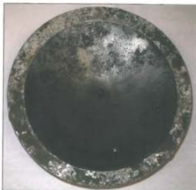
25. ábra. Az MH 1 HTHE gyűjteményében található 44M LÖTAK megmaradt fém töltetburkolata és az EFP-bélés
