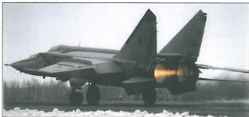
12. ábra. Utánégetéssel száll fel egy MiG-25 PDU, a fékszárny felszállási pozícióban látható
