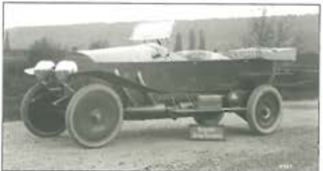
3. ábra. A Romfeli páncélcocsik alvázaként felhasznált, hátsó lánchajtású 37/90 LE-s Mercedes személygépkocsi
