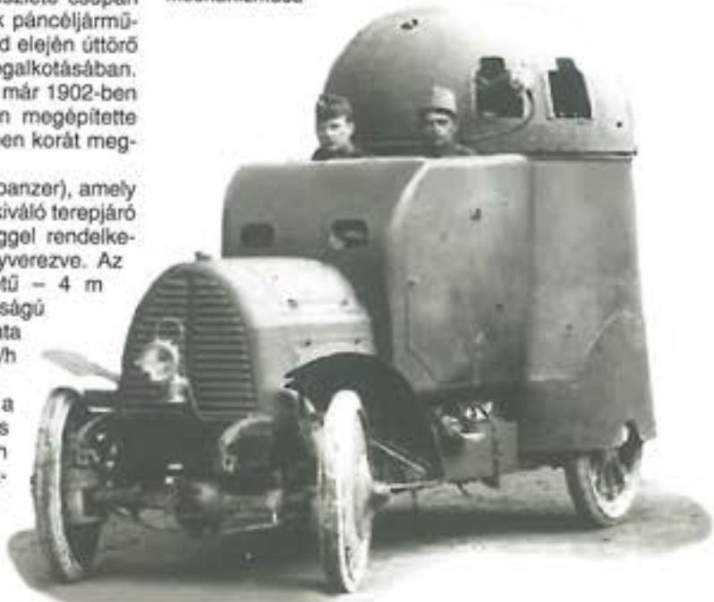
1. ábra. Az osztrák Austro-Daimler négykerék-meghajtású páncélgépkocsi. Jól látszik az elsőkerék-meghajtás mechanizmusa
