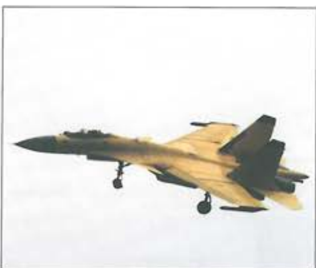
12. ábra. A J-11K tengerészeti gép berepülése még sárga gyári alapszínben. Jól látszik a kacsaszárny és a fékezőhorog
