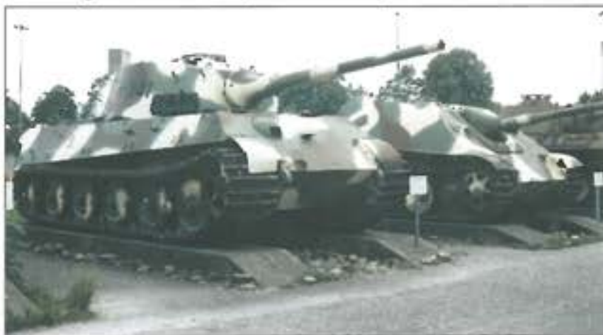
16. ábra. Tiger II nehézharckocsi, felrobbant csőszájfékkal
