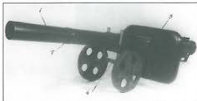
28. ábra. A 94 mm-es páncéltörő rakétavetőn jól látszik a pajzsba épített plexilírányzék
