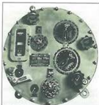
61–63. ábra. A toronyirányzó (balra) és egy lövegirányzó állása a lövegtoronyban (középen) a BALTIMORE osztálynál modernebb SALEM osztályú nehézcirkálók lövegtornyáiban. A célzótváncső okulárjai a bal oldali és a középső kép közepén láthatók. Ebben a változatban az irányzékbéállító az ültő oldalirányzó mögött állt, és onnan kezelte a bal oldali kép felső részén látható korrekcióbeállítót. Ezen a képen alul jól kivehető a két kézzel forgatható és elsütőgombbal ellátott irányzókerék. A SALEM osztályú cirkálók esetében a célzóteleszkópok tárgylencséi a torony külső oldalába helyezett védőburokban lettek elhelyezve. A jobb oldali ábrán egy irányzék (teleszkóp) toronyon kívüre helyezett vége látható, annak a kezelő által lezárható védőzárjával együtt. 177
