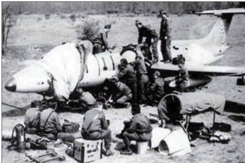
36. ábra. A hangár állománya kiserelte az L-29-es mellső üzemanyagtartályt, mert folyást tapasztaltak. Kenyeri füves reptér, 1974 nyara
