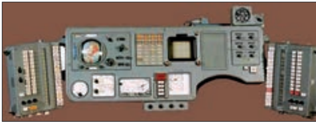
32. ábra. A leglátványosabb fejlődést a lényegében a Soyuz űrhajó belsejében láthatjuk. A legkorábbi Soyuz űrhajók vezérlőpultja
