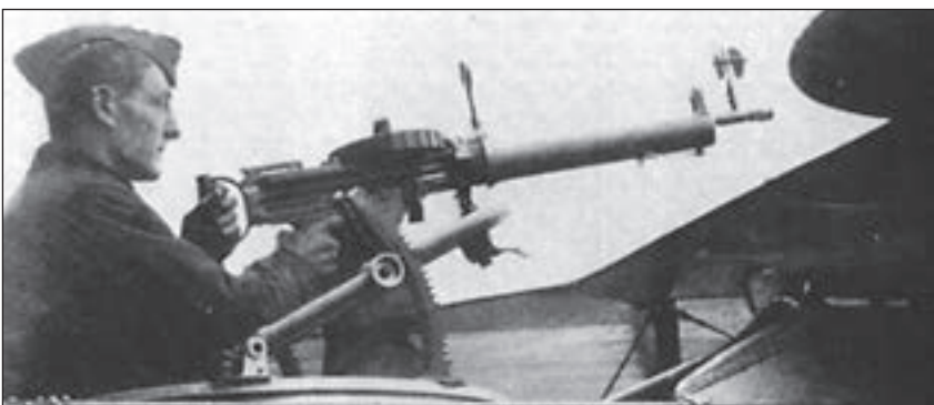
1. ábra. Az I. világháború egyik jellegzetes, kétszemélyes vadásztípusa volt a brit Bristol F.2B vadászrepülőgép, amelynek hátsó fülkeresztjét egy Scarff állványra rögzített, mozgatható 0,303 inches (7,7 mm-es) Lewis géppuskával szerelték fel
