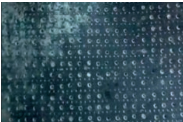
5. ábra. A hajótestre ragasztott bevonat furatainak egyik elrendezése
