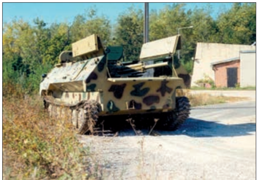
14. ábra. Vasziljok automata aknavető MTLBU alvázon
