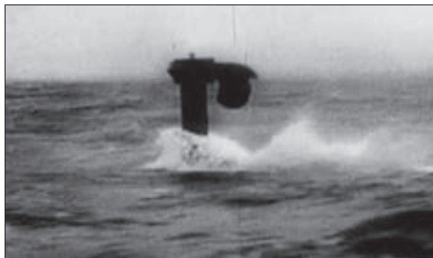
2. ábra. A snorkel kitolva, a naszád víz alatt haladásakor
