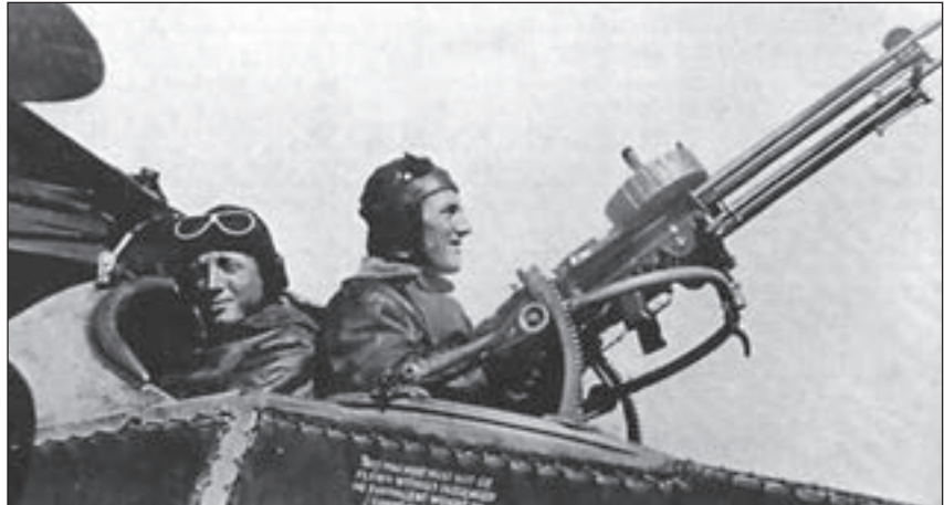
2. ábra. A Bristol F.2B vadászrepülőgép két, Scarff állványra rögzített mozgatható 0,303 inches (7,7 mm-es) Lewis géppuskával
