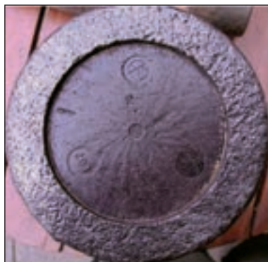
1. ábra. A 10,5 cm-es löszert vetőtöltetének bakelit zárókorongja
