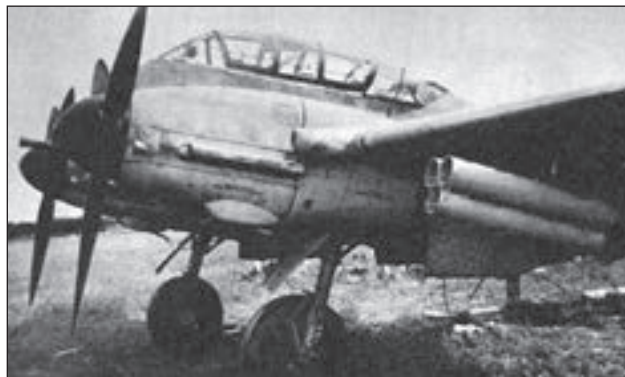
3. ábra. RKI rakétakísérlet Me 210 fedélzeti fegyverként
