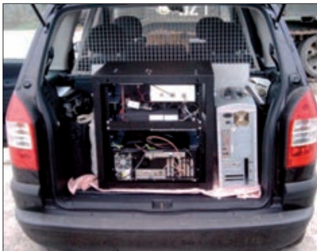
8. ábra. A korábbi VHF sávú lokátort két tehergépjármű vontatta, az új egy személygépkocsi csomagtartójában is elfér
