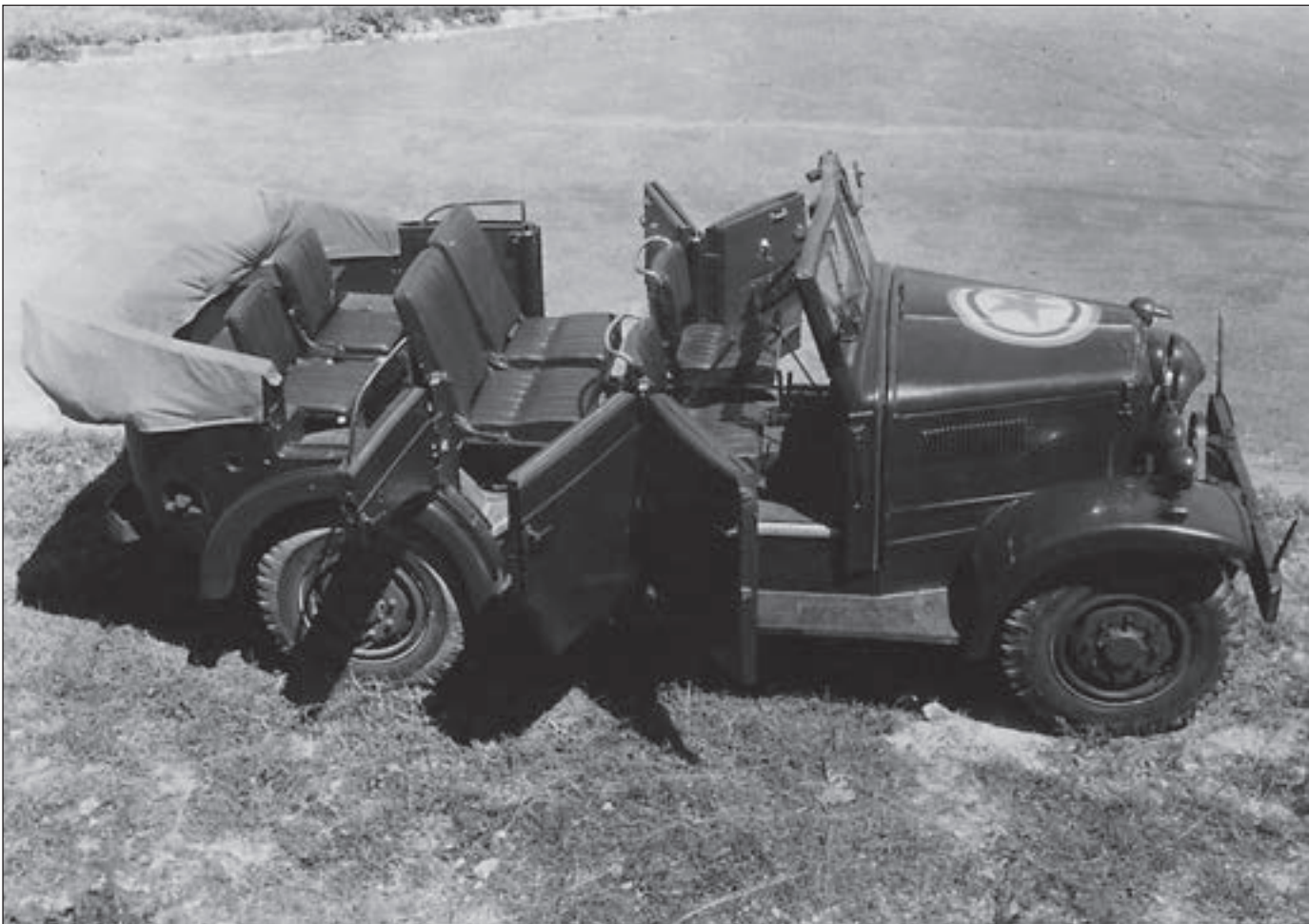
3. ábra. Változtatható ülésekkel több funkciót szolgálhatott
