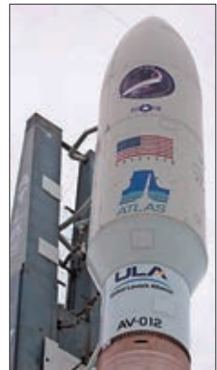
10. ábra. Atlas-V 501 az SLC-41 starthelyen az OTV-1-gyel a nagyméretű orrkúp alatt (USAF)
