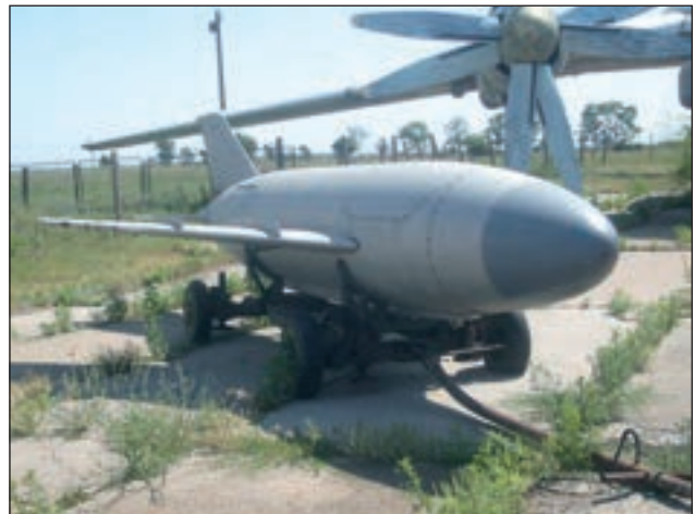
3. ábra. A Tu-16 szárnya alól indítható robotrepülőgép
