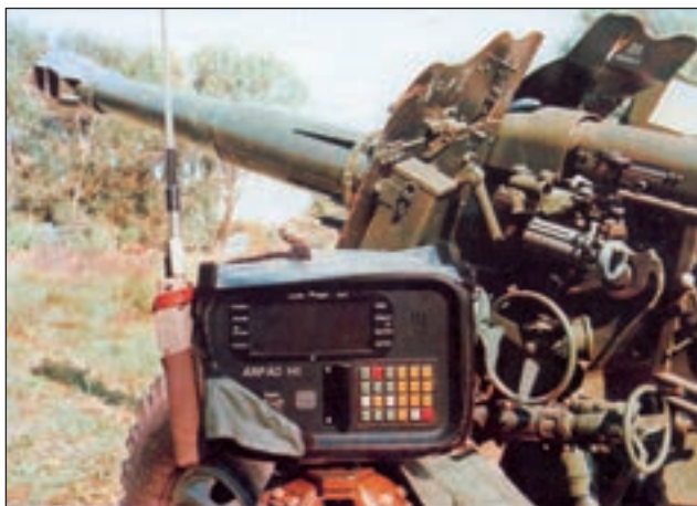
9. ábra. Árpád tűzvezető rendszer
