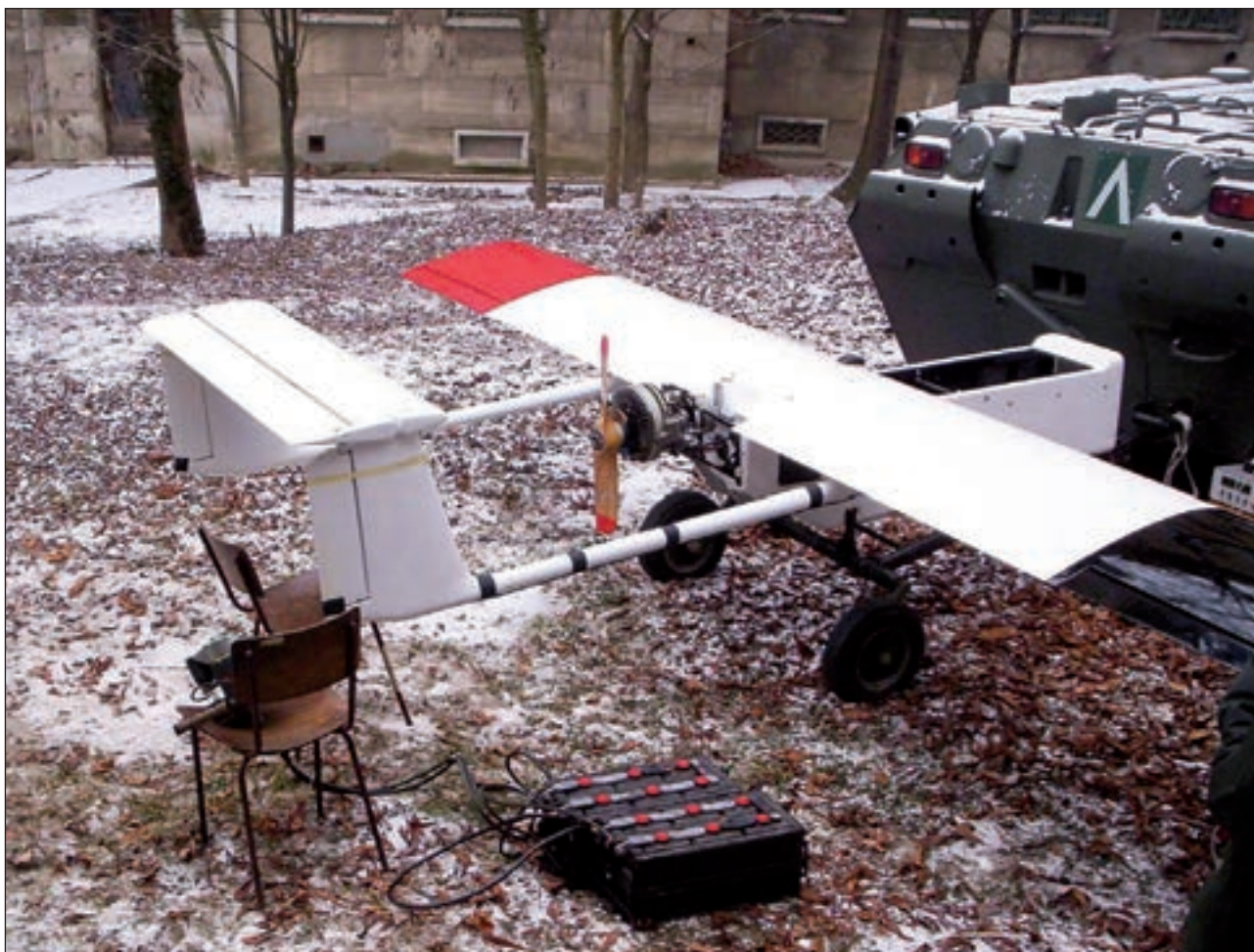
16. ábra. Wankel motor próbája a HTI udvarán a robotrepülőgépen
