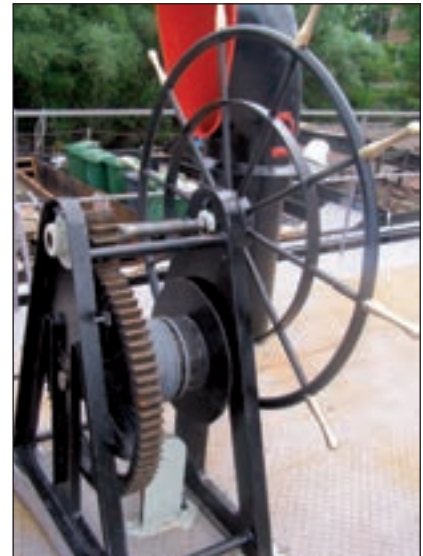
12. ábra. A kormánykerék a drótkötél vezetékekkel. Mögötte az egyik szellőző kürtő
