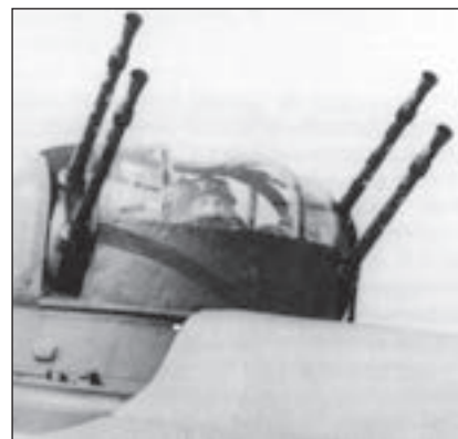
8. ábra. A Type A Mk IID torony a négy 0,303 inches (7,7 mm-es) Browning Mk II-es géppuskával
