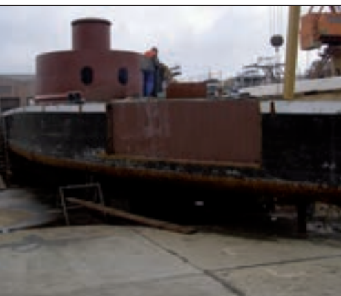
3. ábra. A bordabeugrást követő új lemezek
