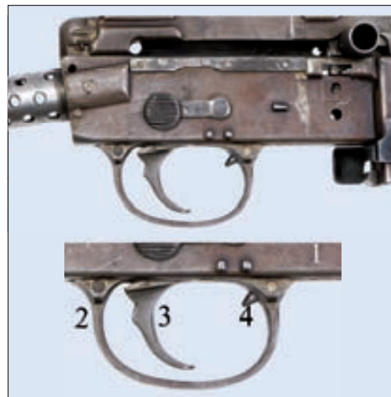
9. ábra. A fegyver sátorvasa és részei: 1. tok, 2. sátorvas, 3. elsütőbillentyű, 4. jelzőcsap
