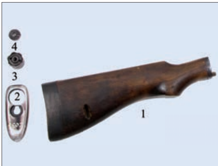
8. ábra. A fegyver tusa és részei: 1. tusa, 2. tusaborító lemez, 3. tusarögzítő, 4. tusarögzítő biztosító (másodlagos funkciója a rászertelt tisztítóvessző kezelhetőségének biztosítása)
