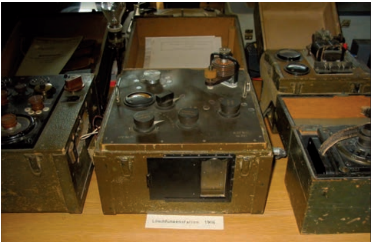
4. ábra. A KST M17 típusú szikratávíró készüléket a Siemens-Halske cég gyártotta 1916-tól. A KST rövidítése a Kleine Station elnevezésnek (A szerző felvétele a bécsi Első Osztrák Szikratávíró és Rádiómúzeumból)
