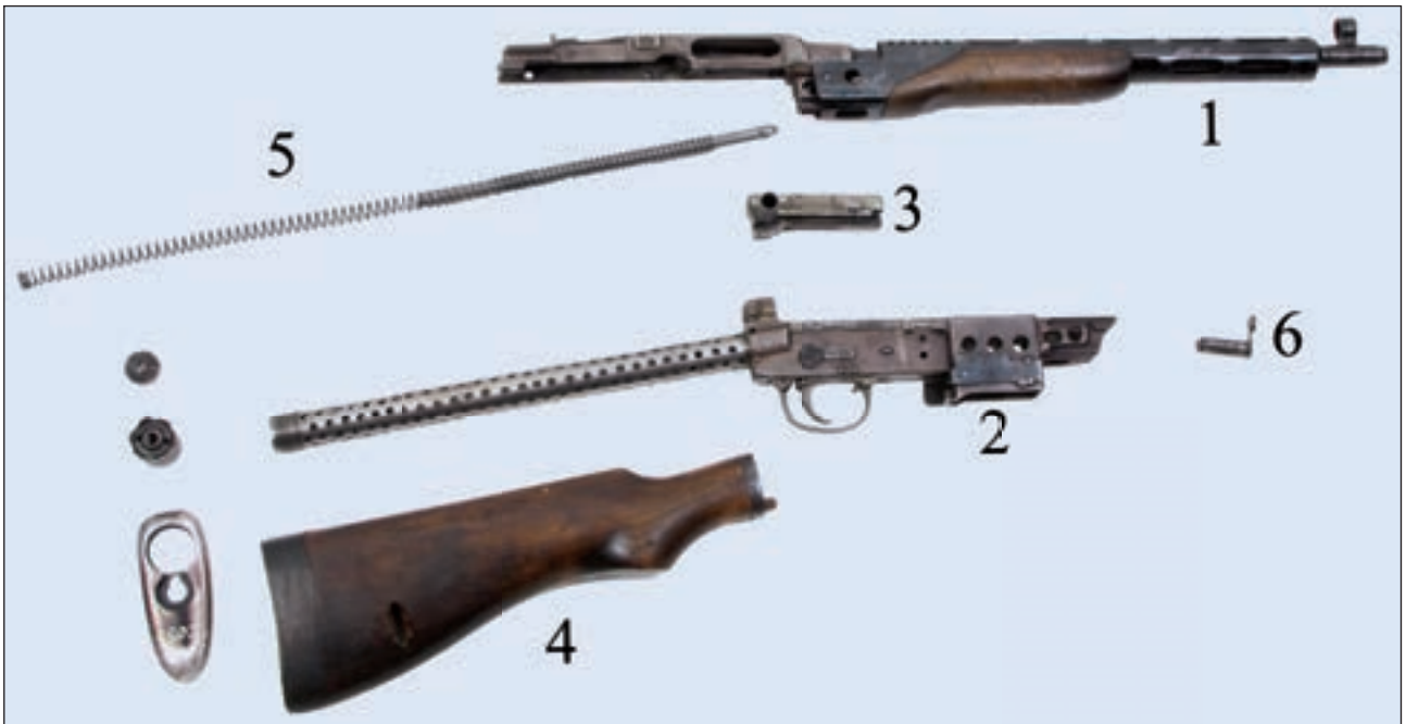
4. ábra. A rohampuska fő részei: 1. szerelt cső, 2. tok, 3. zár, 4. tusa, 5. helyretoló szerkezet, 6. csőrögzítő
