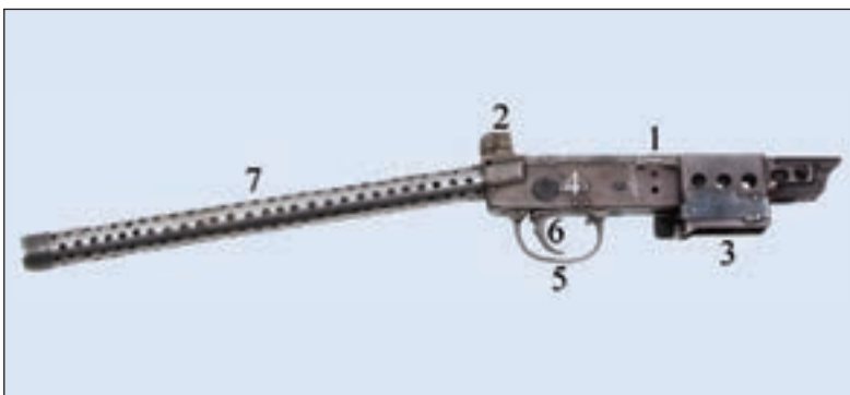
6. ábra. A 7,92 mm-es rohampuska tokjának részei: 1. tok, 2. nyúlvány (a tokfedél rögzítésére), 3. tárhüvely, 4. tűzváltó, 5. sátorvas, 6. elsütőbillentyű, 7. helyretolószerkezet-vezető
