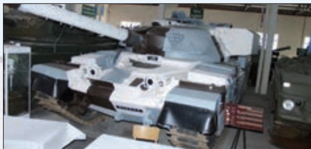
16. ábra. A Conqueror korának tipikus brit nehéz harckocsija. Kiváló védettség, 120 mm-es nehézlöveg, a szovjet ISZ, T-10 harckocsik ellenfelének szánták
