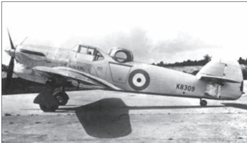
6. ábra. A Hawker Hotspur repülőgépe a lövésztorony fából készült makettjével
