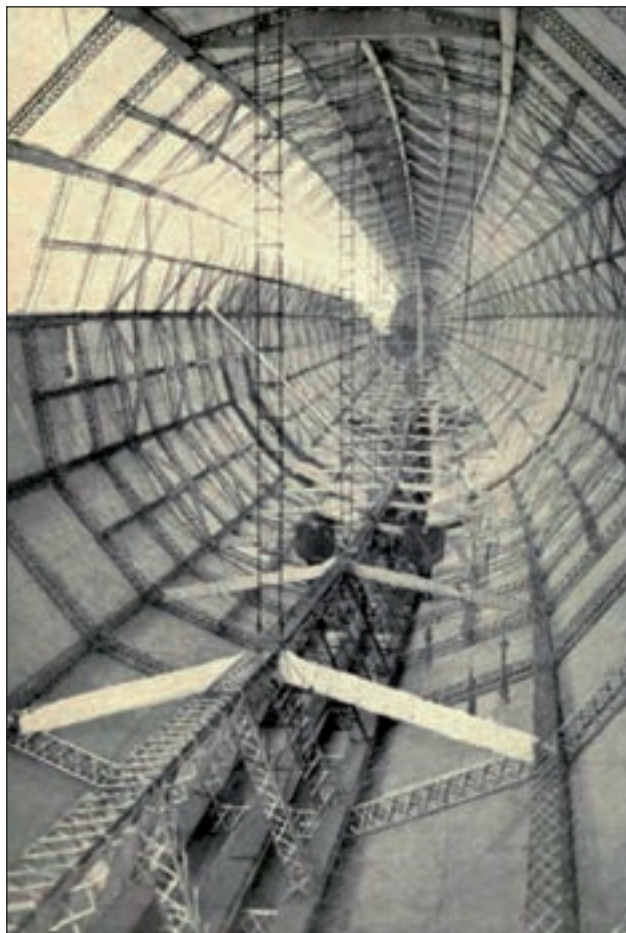
2. ábra. Az L30 (LZ-62) léghajó szerkezete belülről 1916-ban
