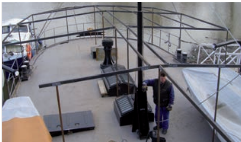
7. ábra. A hátsó fedélzet a csónakokkal, lejárókkal, árbocotóval és a gugorával
