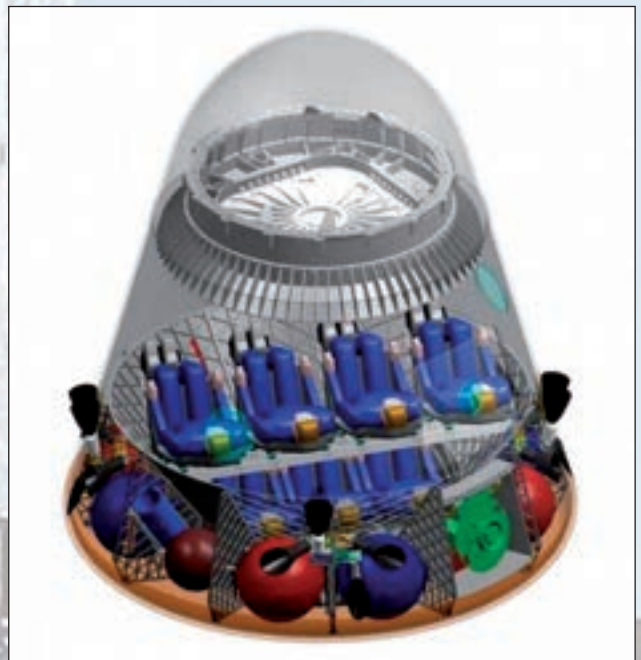
3. ábra. Rajz az űrhajósok elhelyezkedéséről. Hasonló volt – csak öt személyre átalakítva – az Apollo űrkabin, amelyet a Skylab-programban használtak volna (Űrvilág)
