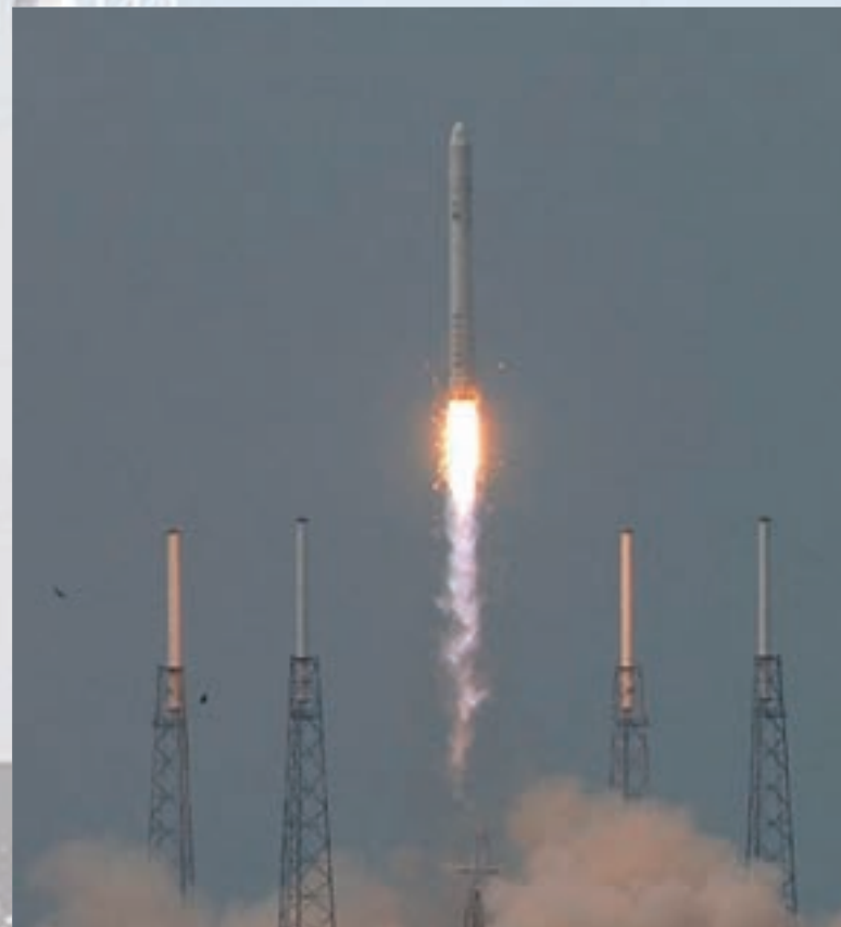
5. ábra. A Falcon-9 első startja. A 40-es indítóállás négy toronyból álló villámhárító-rendszerét a Titan-rakéták számára építették (Űrvilág)
