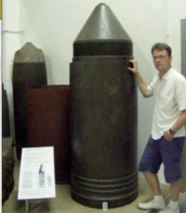
5. ábra. Ha háborúról volt szó, a németek nem ismertek tréfát. A valaha bevetett legnagyobb tűzérési lövedék és a szerző. A képen látható 4,8 tonnás monstium 2310 mm hosszú, melyre tüzelés előtt még egy ballisztikus kúpot is illesztettek, így hossza 5400 mm-re nőtt, aminek köszönhetően ezt a gigászi pusztító erőt maximum 48 km távolságba lehetett célba juttatni
