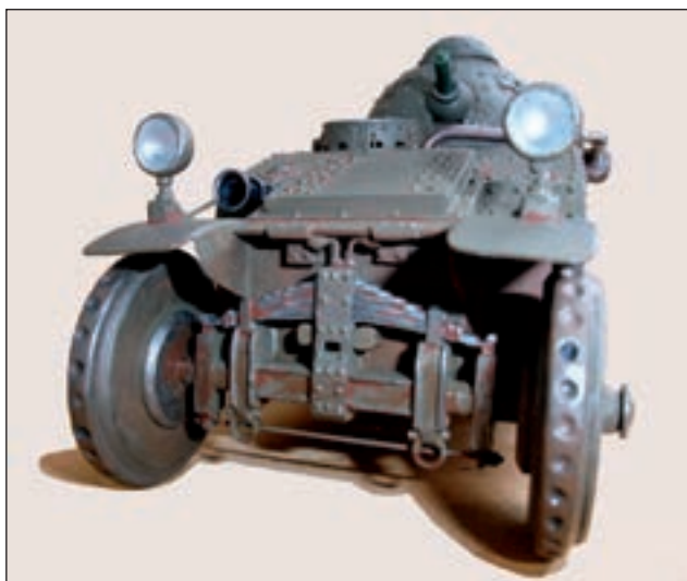
21. ábra. Az első híd a rugózással, első kerék-felfüggesztéssel
