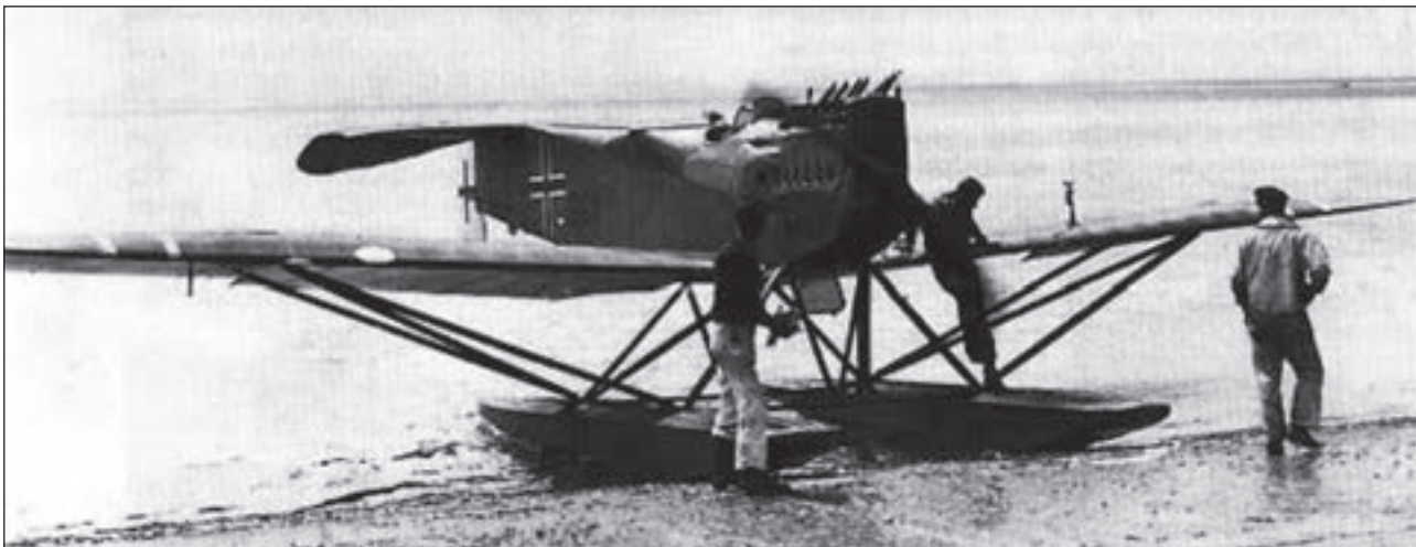
3. ábra. Géppuskás C3MG altípus kihúzva a partra. Az úszótalpak katonai pontoncsónak formájúak, elkeskenyedő hátsó résszel. A balszárnya a sebességmérő anemométert szerelték
