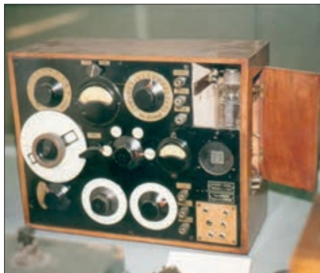
21. ábra. ARS-68-nak nem találtuk nyomát, de ARS-69-ből kettő is megmaradt. A képen látható készüléket olasz léghajón használták 20 wattos csővel (Szerző felvétele a Milai Technikai Múzeumban)
