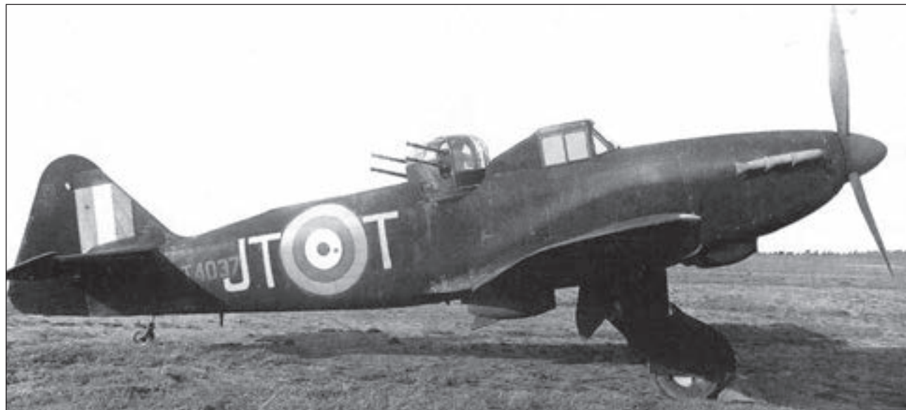
15. ábra. A No.256 Squadron éjszakai vadászként alkalmazott Defiant repülőgépe. A képen jól látszik a törzsgerinc torony előtti és mögötti elemeinek leengedett helyzete
