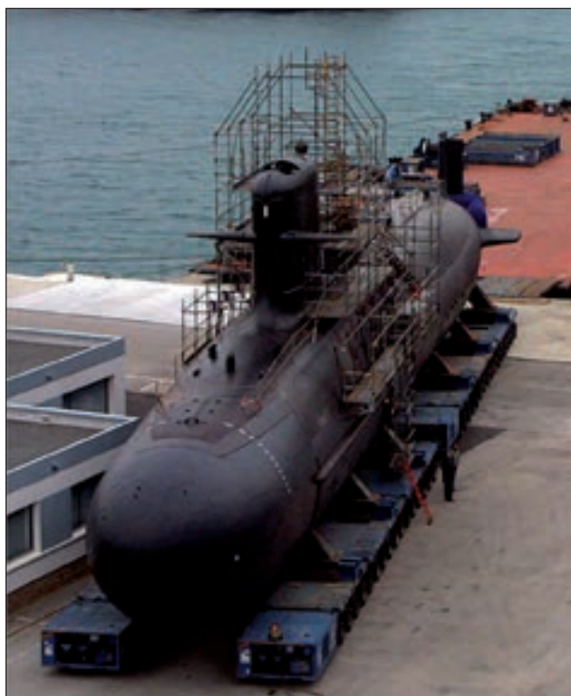
6. ábra. Az első Chilei SCORPÉNE, az O'HIGGINS végszerelése Spanyolországban
