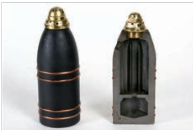
6. ábra. 1875.M 9 cm-es Srapnel időzítő gyújtóval és metszete
