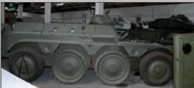
31. ábra. Francia EBR ETT 8 kerekű (4 kerék és négy támasztókerék) páncélosított szállítójármű
