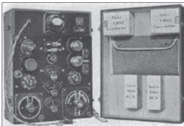
17. ábra. Telefunken E-225a típusú vevőkészülék az F-Gerät-höz, két párhuzamosan kapcsolt elektroncsővel, 300–2000 méter hullámhosszra
