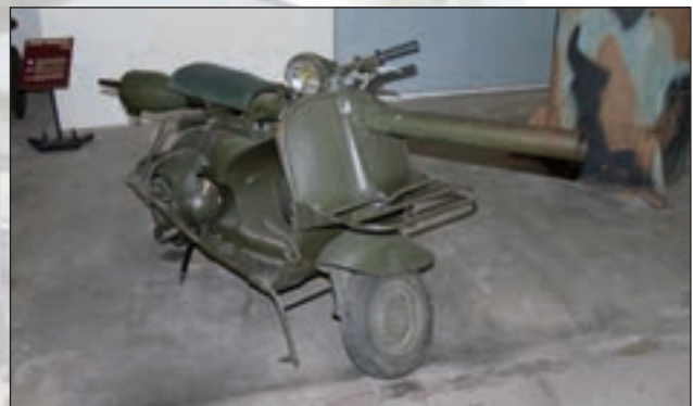
33. ábra. ACMA TAP (Vespa moped, 75 mm-es HSN páncéltörő fegyverrel)
