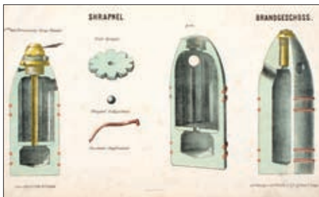
5. ábra. 1875.M 8 cm-es Uchatius ágyú lövedékei, balról időzítő gyújtóval szerelt Srapnel, jobbról gyújtólövedék
