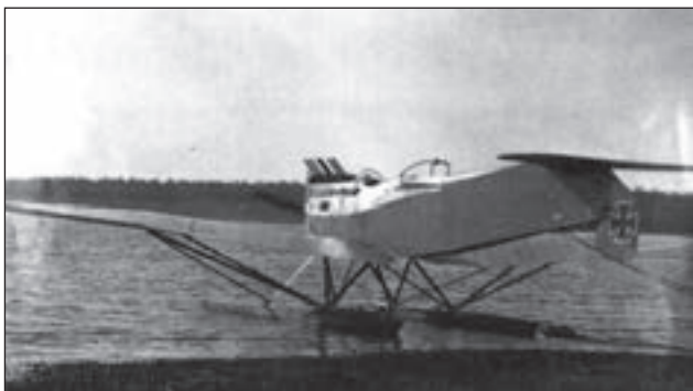
2. ábra. Brandenburg W.29 prototípusa kikötve. Az oldalkormány – amit rövidesen nagyobbra cseréltek – alul van, így hatásosabb permetvíz-kormányzást tesz lehetővé le-, illetve felszálláskor
