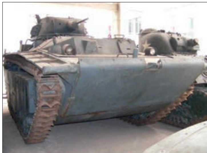
10. ábra. Első generációs amtrac, LVT (A)–1. A jármű vízben különleges „úszóhártás” kialakítású lánctalpai segítségével mozgott
