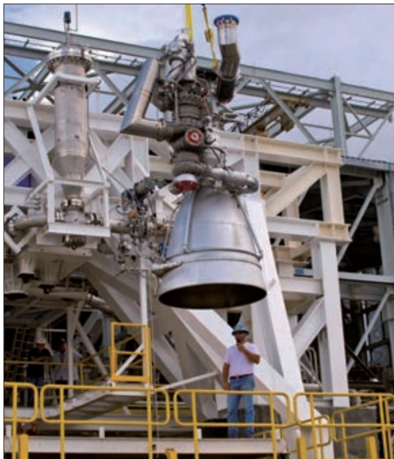
4. ábra. Az AJ-26-os hajtómű fékpadi próbája (Aerojet)
