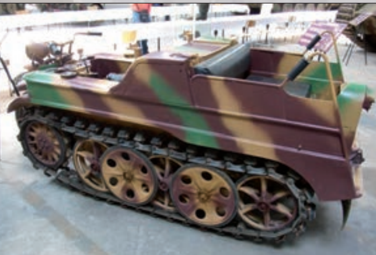
36. ábra. Az Sdkfz 2 Klein Kettenkrad lánctalpas vontatót elsősorban ejtőernyős és hegyi csapatok vették igénybe, de később a Luftwaffe is használta vontatójárműnek
