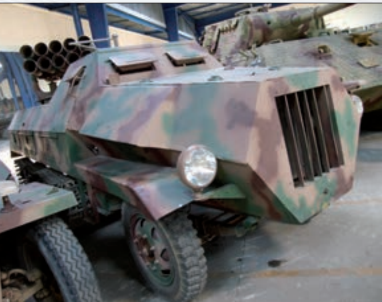
35. ábra. Az Sdkfz 3 Maultier (öszvér) páncélozott alvázon a németek Nebelwerfer reaktív rakétafegyverét hordozta
