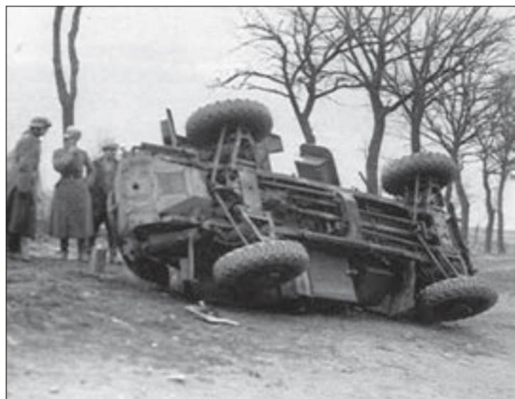
10. ábra. A felborult páncélfelderítő alján láthatóak a négykerék-hajtás és négykerék-kormányzás részei
