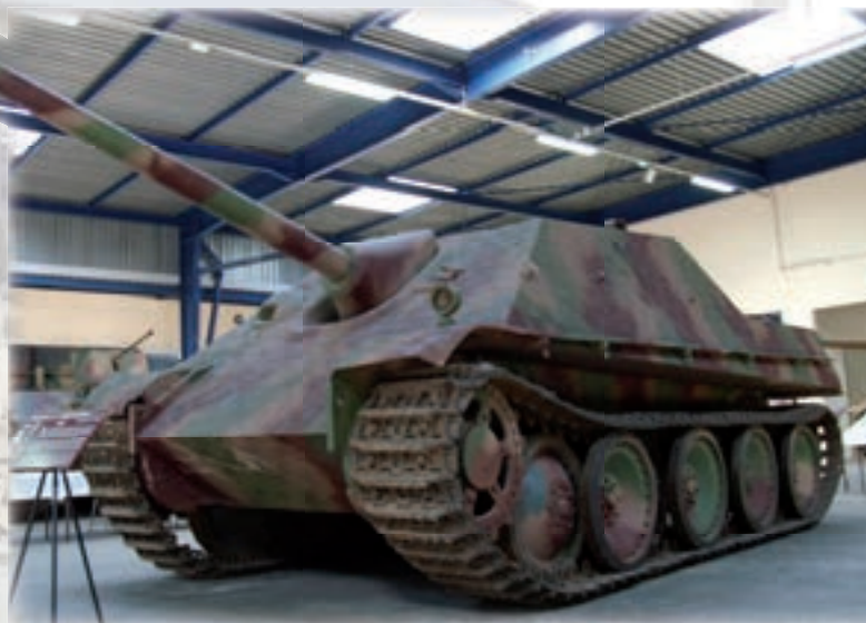
42. ábra. A szemből szinte kilőhetetlen páncélatú, 88 mm-es löveggel épített Jagdpanther vadászpáncélos alulmotorizált volt, és kis példányszámban készült
