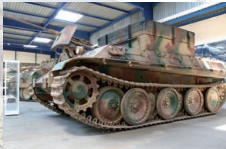
48. ábra. A PzKw V. Panther alváza szerelt, Bergepanther műszaki harcjárműnek 20 mm-es gépágyúja ellenére, nyitott, félig fa felépítménye miatt, egy kézigránát, vagy gyalogsági lőfegyvert is elpusztíthatta a kezelőt
