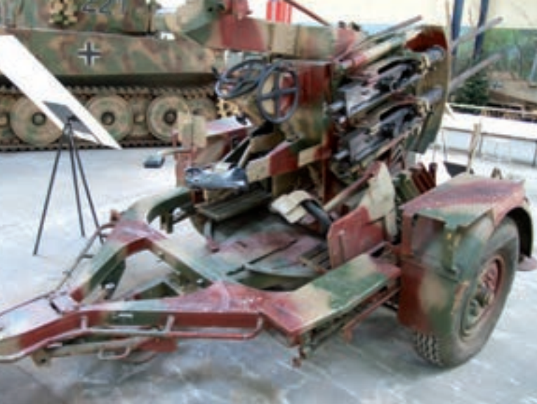
43. ábra. Német Flakvieling 38 négycsövű, 20 mm-es légvédelmi gépágyú
