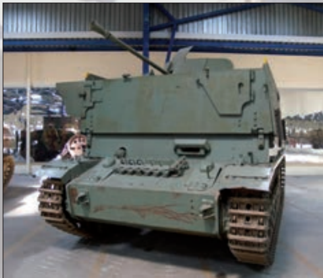
47. ábra. A PzKw IV. felépítményre szerelt 37 mm-es légvédelmi gépágyúval rendelkező páncélost Flakpanzer Möbelwagen néven gyártották
