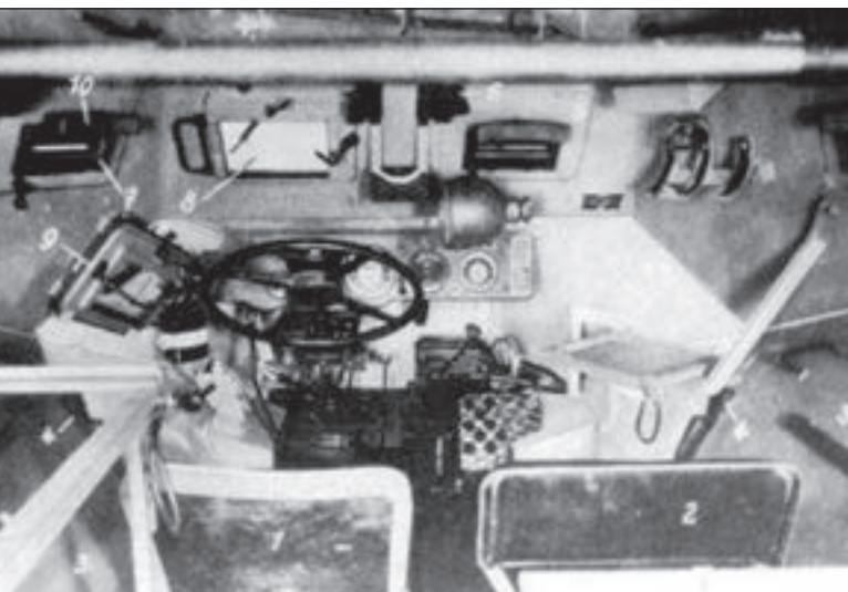
2. ábra. A páncélfelderítő vezetőjének helye, a német lövészpáncélosokhoz hasonlóan erősen döntött kormánykerékkel. E kialakítás révén a vezető veszély esetén könnyebben tudta elhagyni a vezetőállást, lába nem akadhatott be a kormánykerék alá
