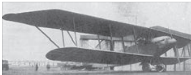
5. ábra. A Li-He gyár ezen típusa ugyan nem átlátszó mint az 1. ábrán, de oly mód vezet fel az ellenséget, hogy egy légcsvarja miatt vadászgép, vagy kisebb repülőgép benyomását adja távcsóval tekintve. Az egy légcsvart az orrban elhelyezett motorcsoport forgatta és a gép a maximális átmérőjű légcsvarok rekordere volt
