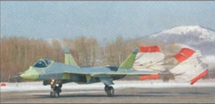
8. ábra. Leszállás az első repülés végén két fékernyővel
