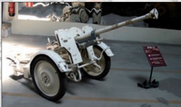
38. ábra. A német 28 mm-es Spz 41 páncéltörő ágyú nem felelt meg harckocsielhárító feladatra
