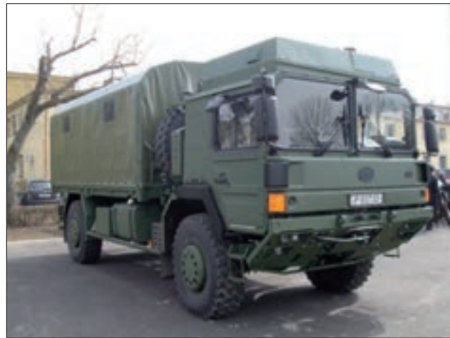
7-8. ábra. RÁBA H14.240 AEL-103 páncélozásra előkészített fülkével szerelt katonai terepjáró gépjármű nézeti képei
