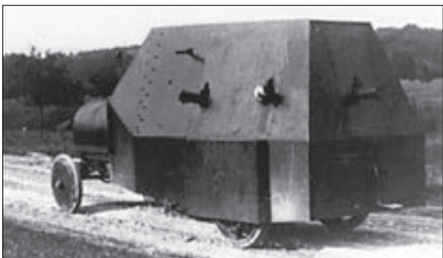
8. ábra. Az alaptípus egy másik példánya, melyről hiányzik a reflektor és a motortér alatti páncélzat (Éder Miklós gyűjteménye)
