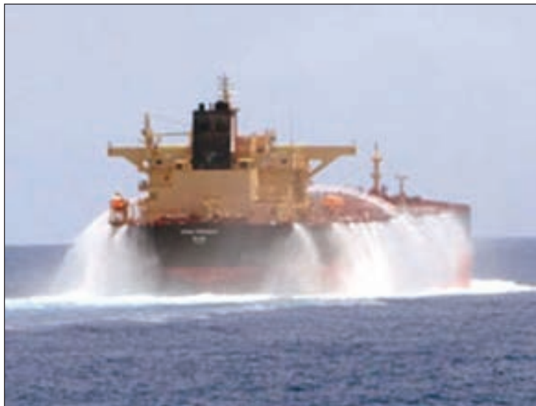
2. ábra. A hajók a képen látható vízfüggönnyel igyekeznek megakadályozni, hogy a kaló zok a fedélzetre jussanak
