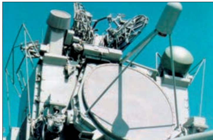
5. ábra. Az SA-N-9 (Gauntlet) rendszer radarja
