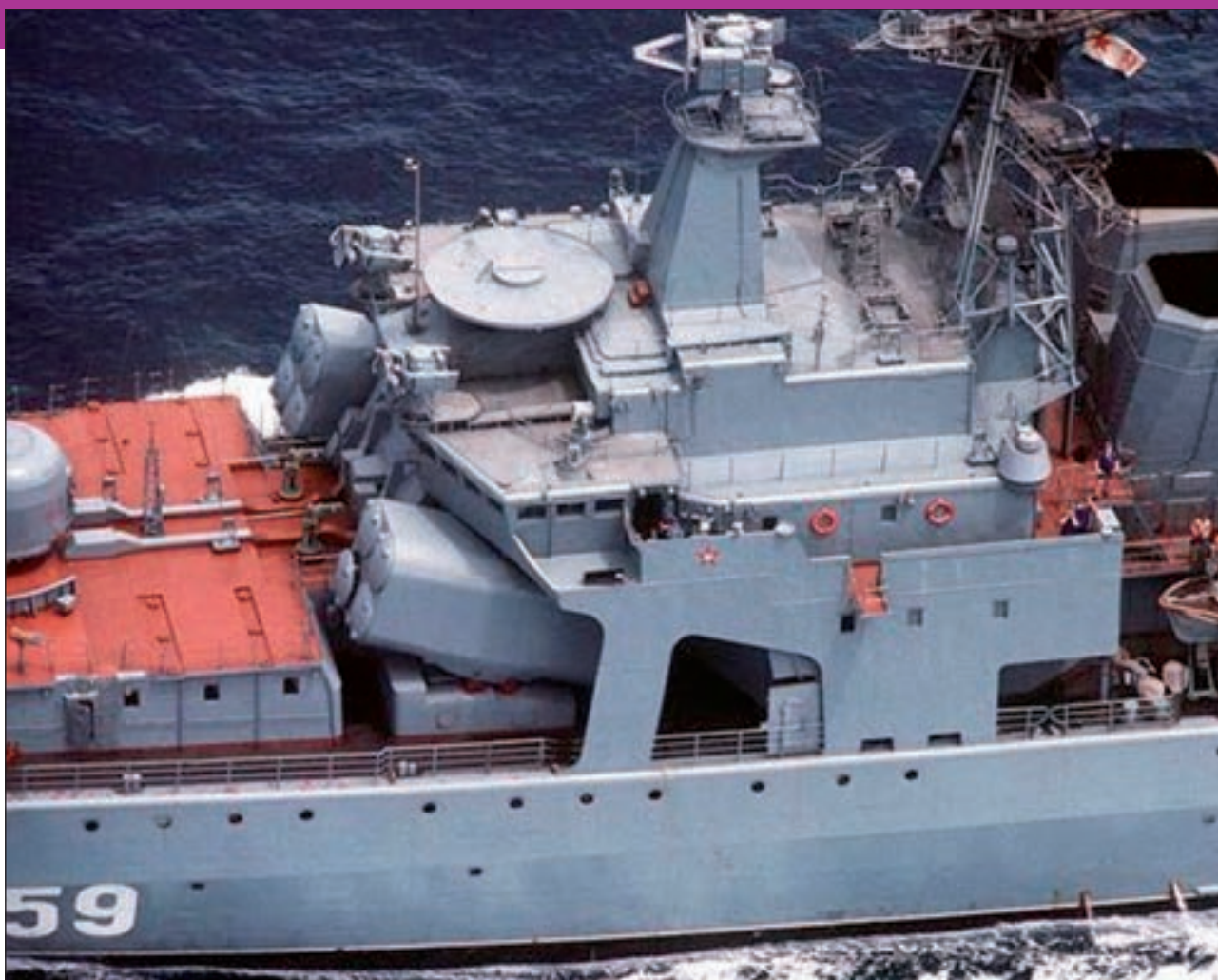
7. ábra. Az SA-N-9 (Gauntlet) rendszer radarjának platformja a parancsnoki híd felett
