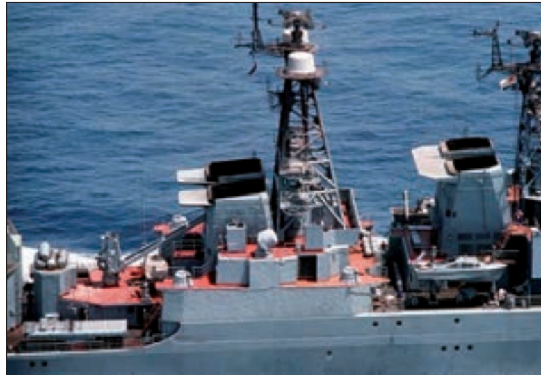
2. ábra. Egy-egy AK-630M a felépítmény sarkán, míg középen, egy szinttel feljebb az MR-123-02-es tűzvezető radar látható
