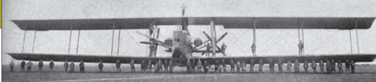
29. ábra. Egy nagyon ismert felvétel, az összes repülési könyv tartalmazza. Az SSW gép (Siemens–Schuckert Werke), mint a fronton bevetett legnagyobb, hatmotoros óriásgép, ritka beállításban
