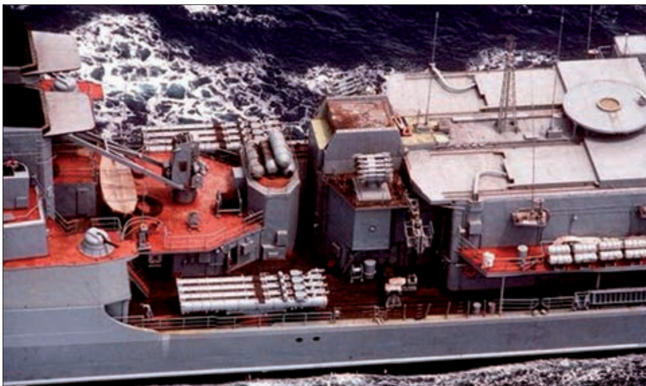
8. ábra. A helikopterhangár tetején lévő szintén üres radarplatform a kép jobb oldalán és az SA-N-9 (Gauntlet) indítótubusai egy rozsdás lemezzel letakarva a kép közepén
