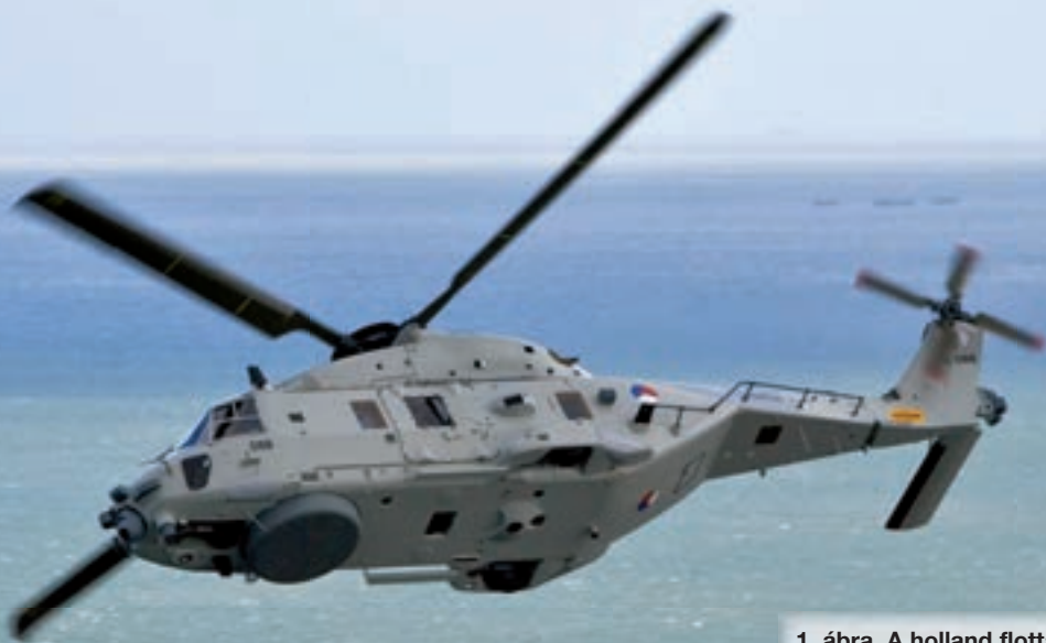
1. ábra. A holland flotta NH90 NFH helikoptere. Látható az ASW lokátor
