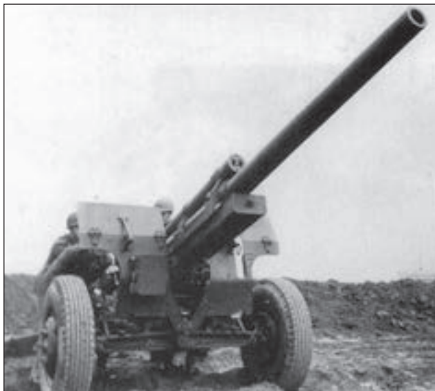
6. ábra. A háromhüvelykes (76 mm) M5 több mint 2 tonnás tömegével nagydarabnak és nehéznek számított. A löveg teljesítménye közepszerű volt, nem számított sikeres harceszköznek
