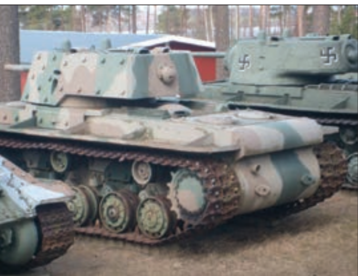
18. ábra. A KV-1 kiegészítő páncélozással szerelt példánya
