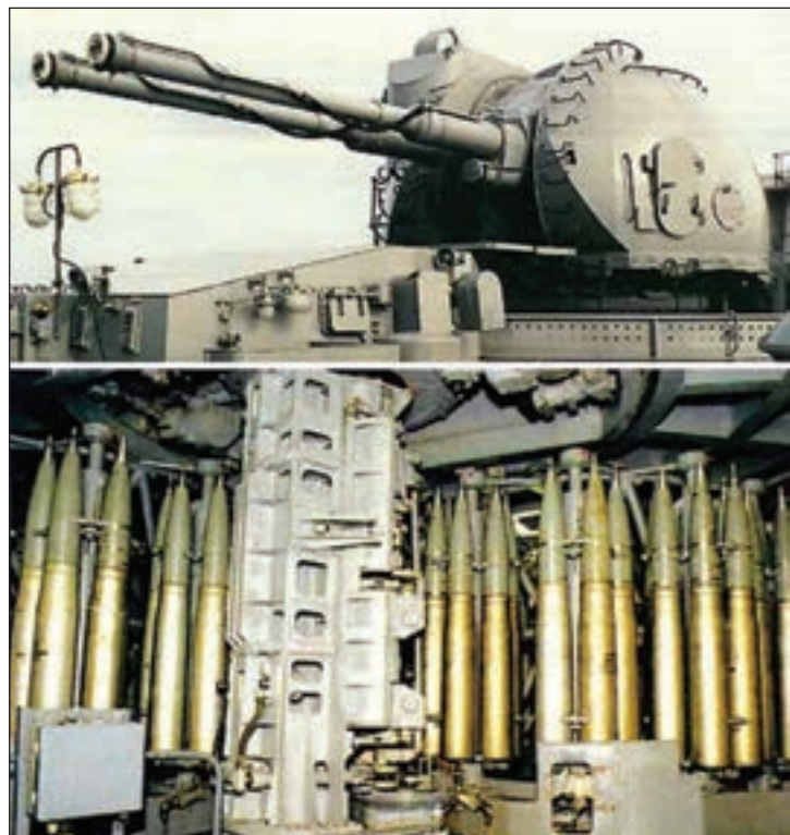
17. ábra. AK-130 hajólöveg, és lőszerai a töltőautomatában
