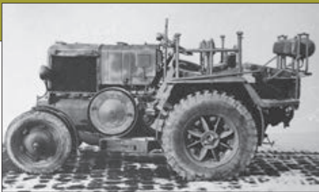
4. ábra. A KV-40 bal oldali nézete. Alul jól látható a kipufogóberendezés, valamint a hátsó kerék tárcsájában rögzített kapaszkodókörmök
