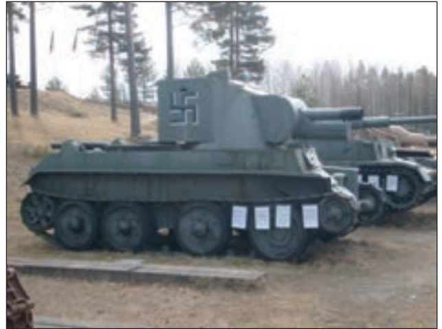
13. ábra. Zsákmányolt BT-5 átépítés, finn 152 mm-es tarackkal
