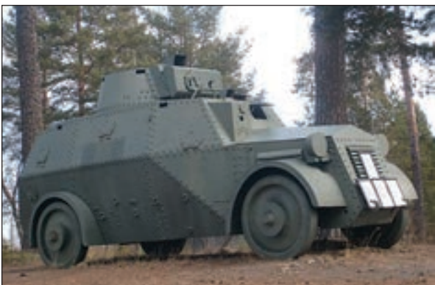
21. ábra. Finn gyártású páncélaútvó, amely átalakításból készült
