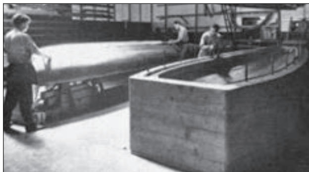
4. ábra. Ragasztott, réteges lemez sárkányszerkezet gyártása a Lockheednál (1931)
