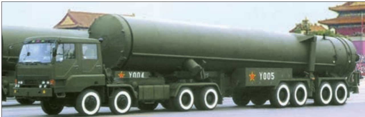
14. ábra. A DF-31 szilárd hajtóanyagú ICBM rakéta a szállító járművén, konténerben
