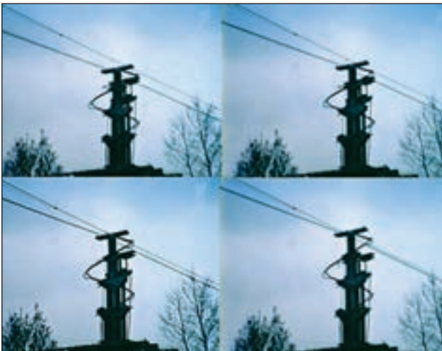
16. ábra. A vezetékfeszítő szerkezet működésének első fázisa
