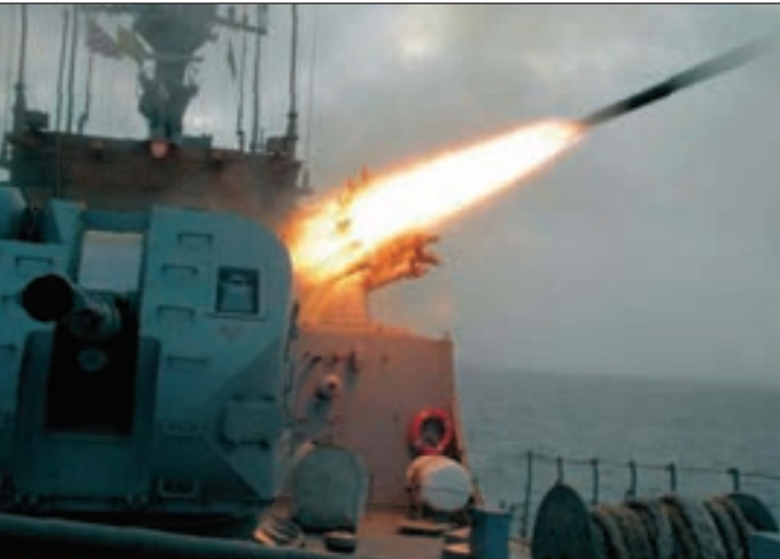
14. ábra. Az egyik, a repülés közben nem irányított RGB-60-as, melynek 110 kg-os indulótömegéhez egy 25 kg-os harci rész társul
