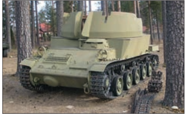
23. ábra. A svéd szállítású L-62 önjáráó légvédelmi géppágyú, a fegyverzet nélkül
