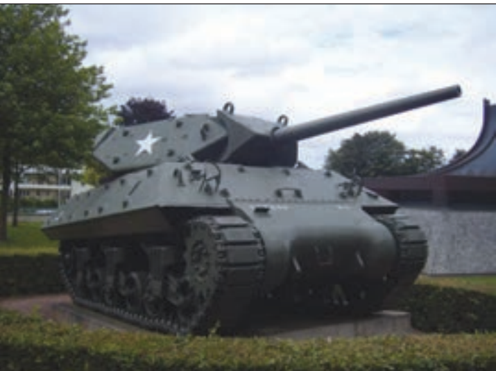
4. ábra. Az M4 Sherman alvázán kialakított M10 1943-ban még korszerűnek számított. Az észak-afrikai sivatagban az ellenfeleket nagy távolságból is kilőhették
