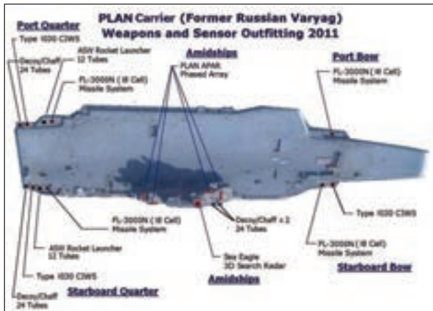
8. ábra. A fegyverzetek beépítési pozíciói
