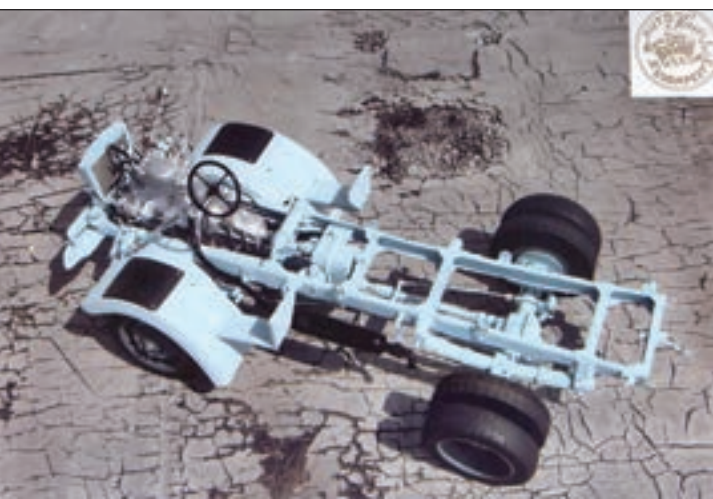
10. ábra. Az alváz és futómű modellje 1:5-ben
