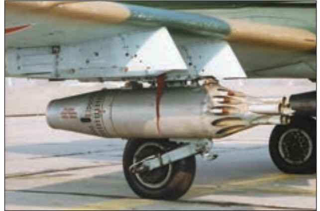
10. ábra. Az UB-16-57 rakétablokk részleges feltöltéssel a 3. fegyvertartón 2007. április 3-án
