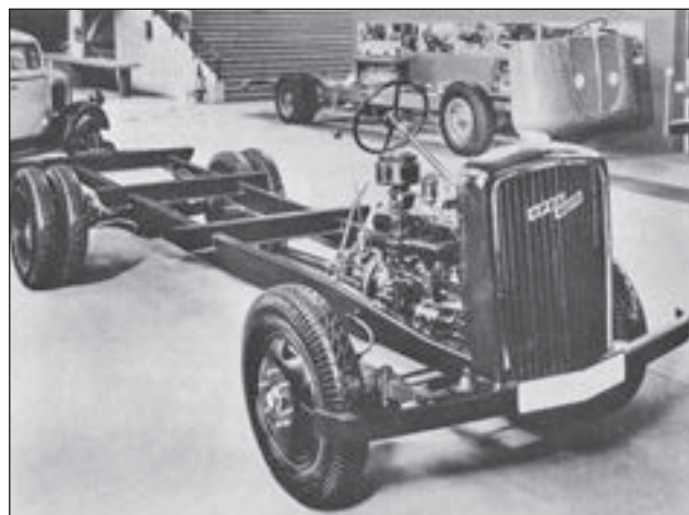
2. ábra. Az 1937-es berlini IAMA (Nemzetközi Automobil Kiállítás) egy részlete a 3 t-s Opel Blitz komplett alvázával
