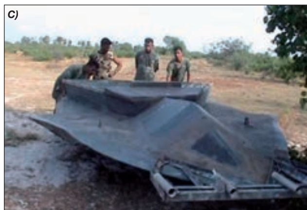
3. ábra. Az Oroszlános haditengerészet 23 mm-es gépágyúval felszerelt, 7,6 méter hosszú ARROW kisnaszádjaja (SFAC). Főleg a nagyobb FAC-ok kísérésére, ritkában SBS kommandósok támogatására használták
