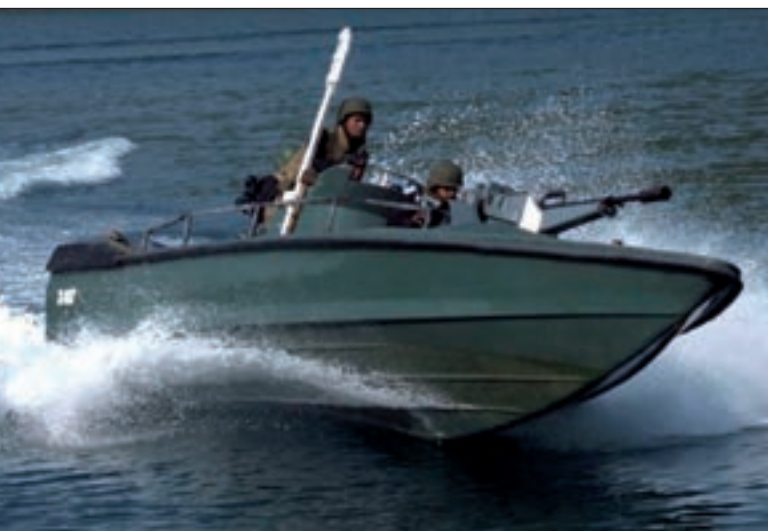
3. ábra. Az Oroszlános haditengerészet 23 mm-es gépágyúval felszerelt, 7,6 méter hosszú ARROW kisnaszádjaja (SFAC). Főleg a nagyobb FAC-ok kísérésére, ritkában SBS kommandósok támogatására használták
