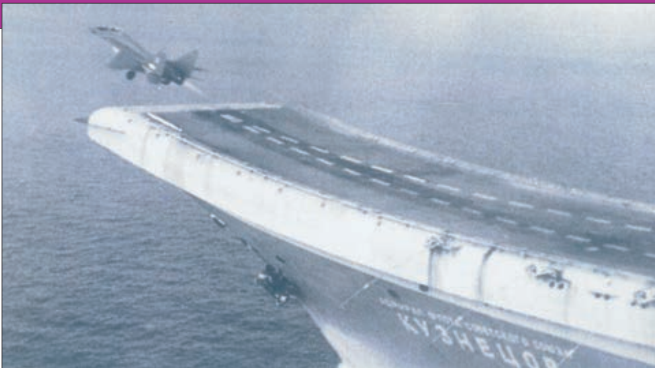
6. ábra. A TBILISZI/KUZYNECOV fedélzetén végzett próbák bizonyították, hogy egyik gépnek sem okoz gondot a külső rásegítés nélküli felszállás. A MiG-29K azonban jelentősen nagyobb sebességgel érkezett a leszálláshoz, míg a Szu-27 a megközelítés során sokkal „megbocsátóbb” volt. A nagyméretű Szuhoj nagyobb hatótávolsággal is rendelkezett
