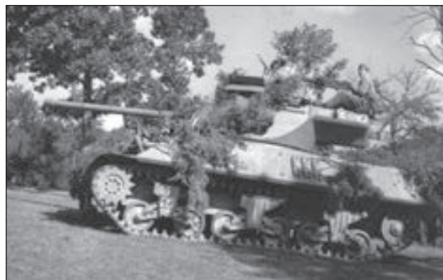
11. ábra. Ez már egy másik éra. Jugoszláv szolgálatban az M36-okba a T-55 dízelmotorját építették be. Az öreg tipushoz korszerű kumulatív lőszerkeket is rendszeresítettek
