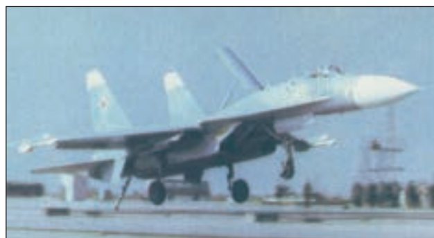
3. ábra. A Szu-27K fejlesztéséhez számos Szu-27 törzset használtak fel, a két legfontosabb ezek közül a kacsaszékesekkel felszerelt T10-24 és a képen látható, fékhoroggal ellátott T10-25 (Szaki, NITKA központ)
