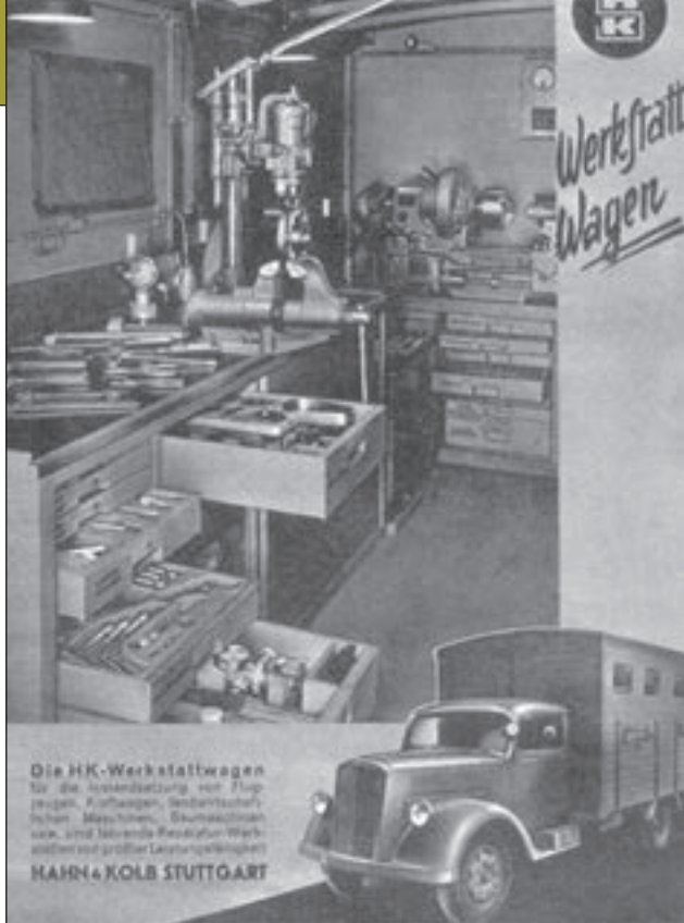
6. ábra. A stuttgarti Hahn & Kolb cég minden igényt kielégítő műhelykocsi-felépítményt épített a 3 t-s Opel Blitz „S” és „A” alvázakra. A felépítmény alsó és felső oldalai kihajthatóak voltak, melyek munkaasztalként, illetve azokhoz fedélként szolgáltak
