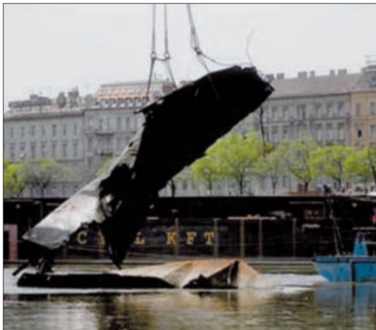
70. ábra. Az első uszályroncs kiemelése a víz alól
