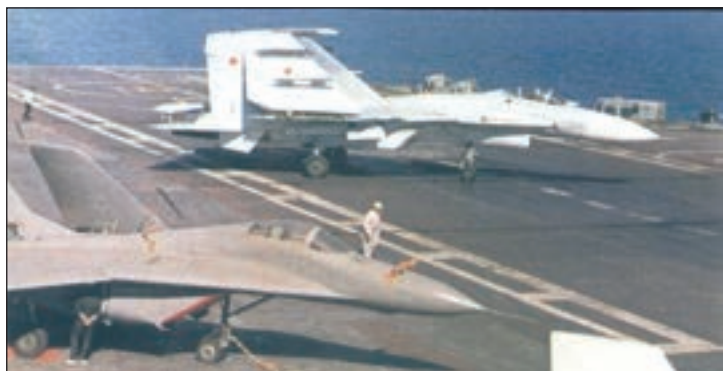
5. ábra. Az első sorozatgyártású Szu-33, a T-10K-3 egy fa MiG-29K-val osztozik a fedélzeti helyen. Ez utóbbi fontos eszköz volt a fedélzeti kezelhetőség felmérésénél, valamint a gép „beprobálásánál” a fedélzeti liftek és hangár esetében
