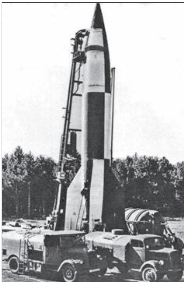
9. ábra. A képen két különböző Opel tartálykocsi látható, a V2 rakéta feltöltése közben. Balra egy nyitott vezetőfülkés „S” változat 3500 literes tartállyal, jobbra pedig egy 2100 liter üzemanyag szállítására alkalmas összkerékajtásos típus
