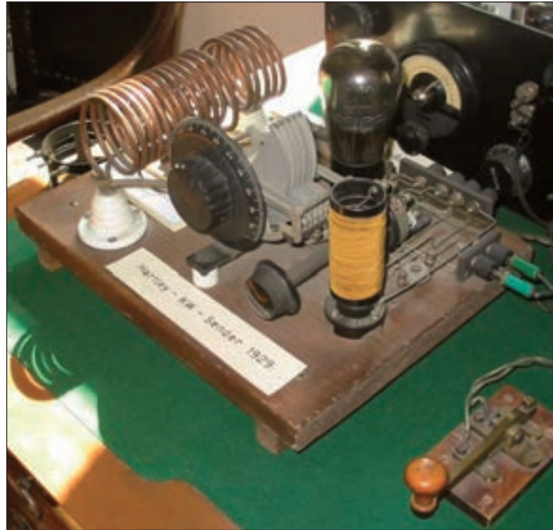
3. ábra. Deszkalapra szerelt egyszerű amatőradó 1929-ből. A szerző felvétele 2003-ban készült, az egykori bécsi rádiómúzeumban
