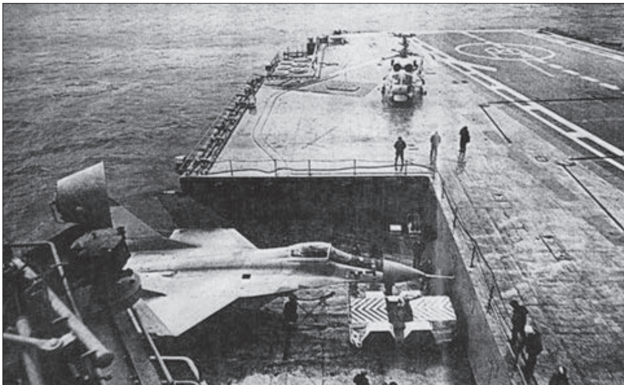
9. ábra. A hajó jobb oldalán épített lift segítségével egy MiG-29-est emelnek a fedélzetre. Balra hátul 6 db SA-N-9 légvédelmi rakétaindító siló fedőlemeze látható. Jobb oldalon látszik a fedélzeten beépített 4 fékező kábelből kettő (V. I.)
