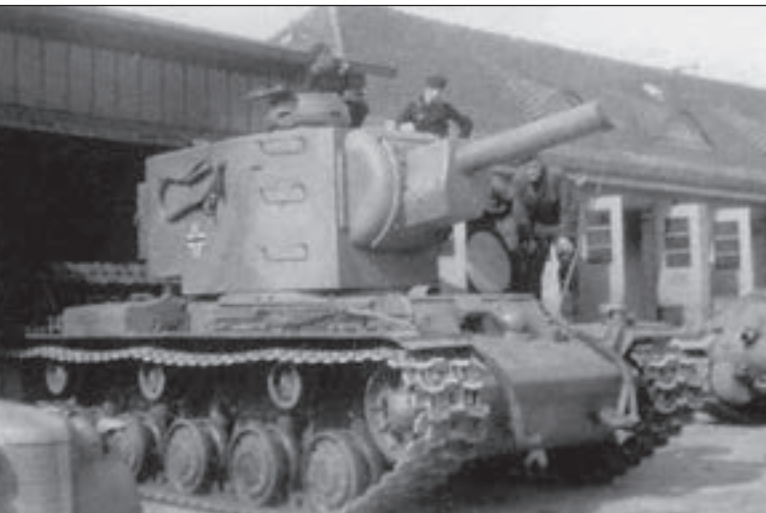
6. ábra. KV-II 754(r) a Panzer Abteilung z.b.V 66. második századából. Jól megfigyelhető a harckocsin a toronyra szerelt Pz. IV. parancsnoki kupola és a jármű hátsó részén a löszerrakaszok a 152,4 mm-es löveghez
