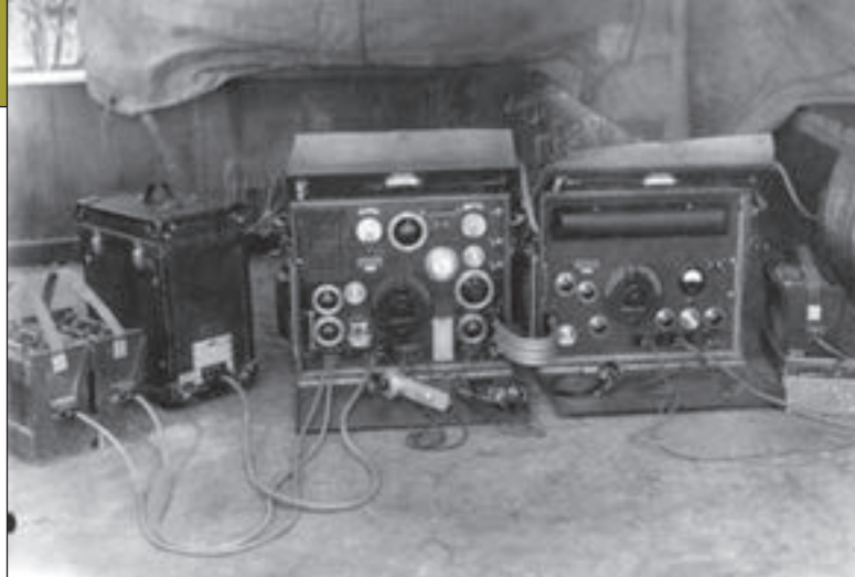
10. ábra. Az R/7 rádióállomás fényképe a Postamúzeum fotótárából. Balról akkumulátorok és az átalakító, középen az adó, jobbra a vevőkészülék
