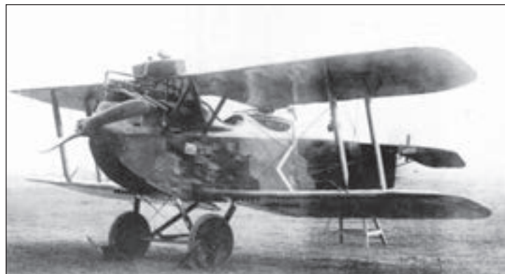
9. ábra. UFAG C.I 161.67 a Flik 23/D állományában 1918 nyarán. A szárnyak alatt 6-6 felfüggesztési pont 12,5 kg-os bombák számára (Grosz–Haddow–Schiemer, 294. o.)
