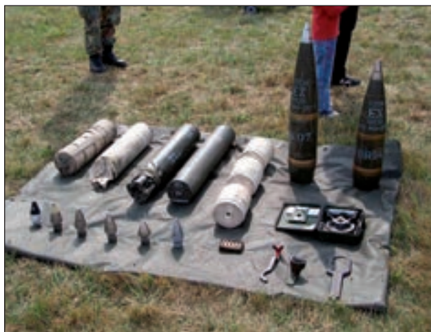
3. ábra. Modern löszerkészlet PzH 2000 tarackágyúhoz. Jól megfigyelhetőek a löszerek részei: a lövedék, hajtótöltet és gyújtó
