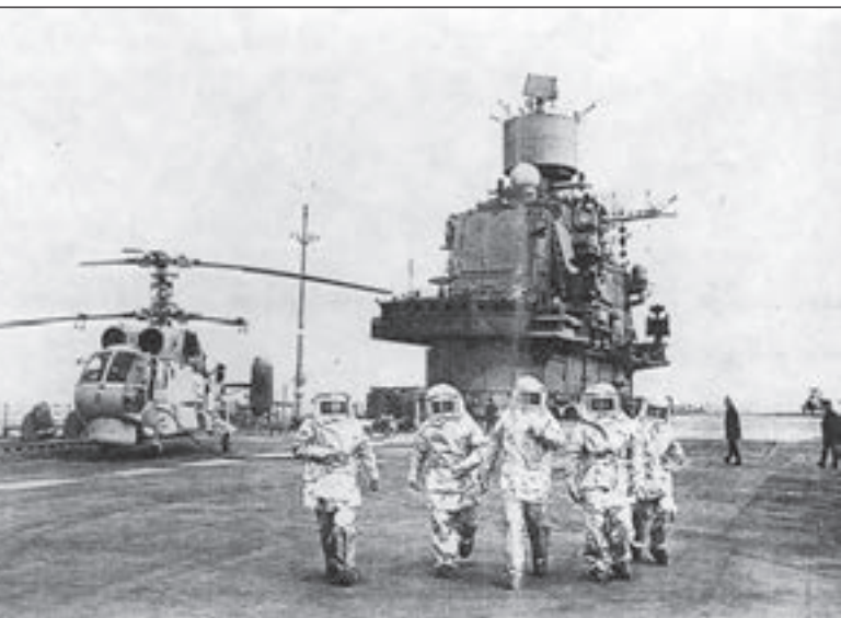
8. ábra. A még TBILISZI tűzoltó osztaga gyakoroló bevetés közben. Balra egy Ka-27 kutató-mentő helikopter áll, és jól látható a felépítmény tetején a hengeres palástban elhelyezett felderítő és a felette lévő célkövető radar is (V. I.)
