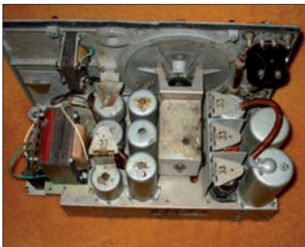
26. ábra. Az R/7–a vevő belseje felülnézetből. (Baloldalon utólag beépített tápegység.) A vibrátoros anódpótló és a világító szerelvény hiányzik
