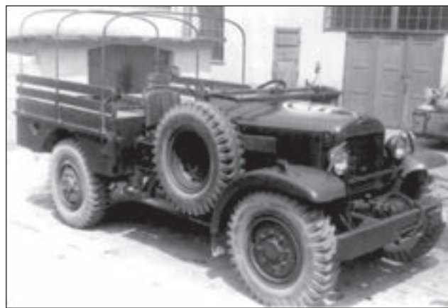
2. ábra. A NIK-130 jelzésű terepjáró rajgépkocsi benzinüzemű mintapéldánya
