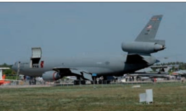
21. ábra. KC-10A légi utántöltő repülőgép, nyitott oldalajtóval
