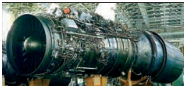
5. ábra. A MiG-29K harci repülőgép RD-33 MK hajtóműve
