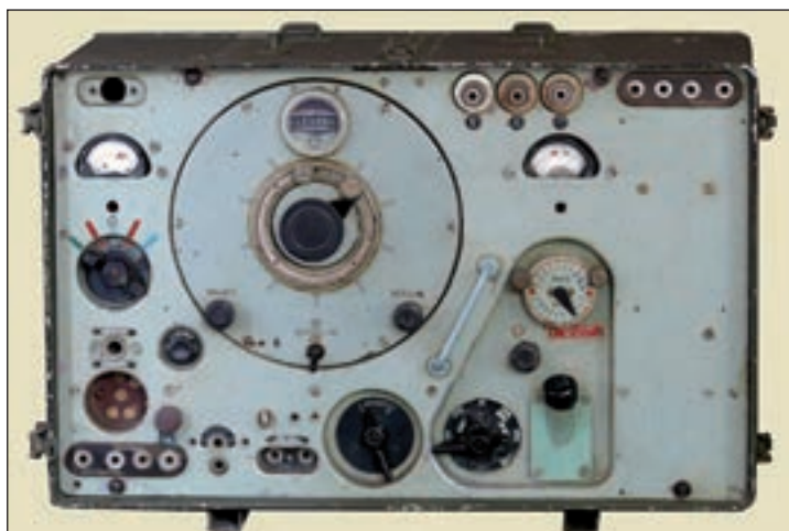
18. ábra. R/7-a adókészülék a HM gyűjteményéből (A bal felső sarokból a kihúzható lámpaszervevény hiányzik.) (Kollár Ernő felvétele.)
