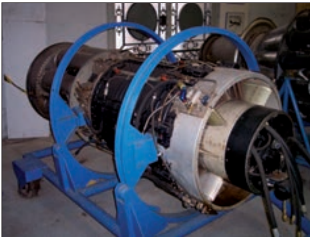
18. ábra. A GE J-47 típusú hajtómű egyik múzeumi példánya
