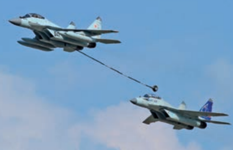
2. ábra. A MiG-29 KUB szimulálja a MiG-35-ös harci repülőgép légi utántöltését (K. I.)
