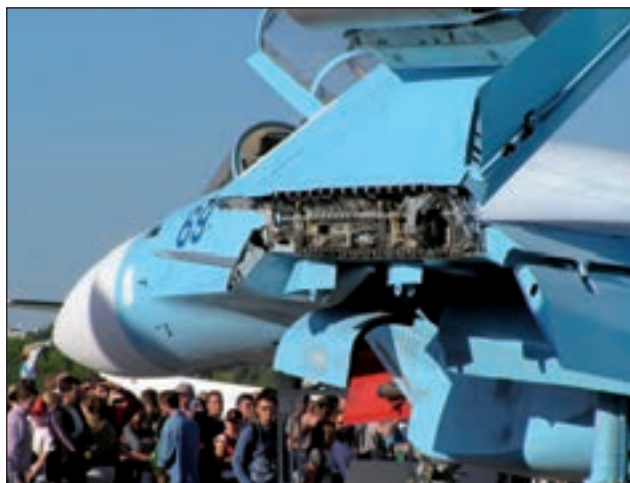
12. ábra. A haditengerészeti Szuhoj a MAKS 2011 szakkiallításán. Jól látható a szárny felhajtasát lehetővé tevő mechanizmus (K. I.)
