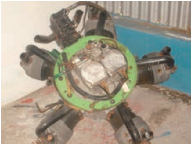
5. ábra. Orosz repülőgép csillagmotorja az első világháborúból
