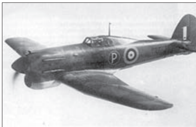
2. ábra. A Hawker Tornado szintén Rolls-Royce Vulture motorral repült
