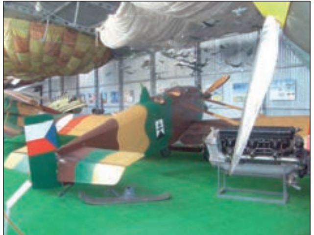
8. ábra. Húszas évekbeli Avia BH-11 monoplán replikája és egy V-12-es folyadékűtésű repülőgépmotor a II. világháborúból
