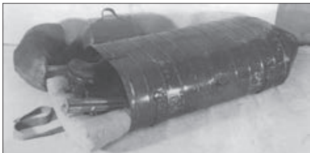
43. ábra. Lábhajtású generátor és az antenna alkatrészek dobóhüvelye
