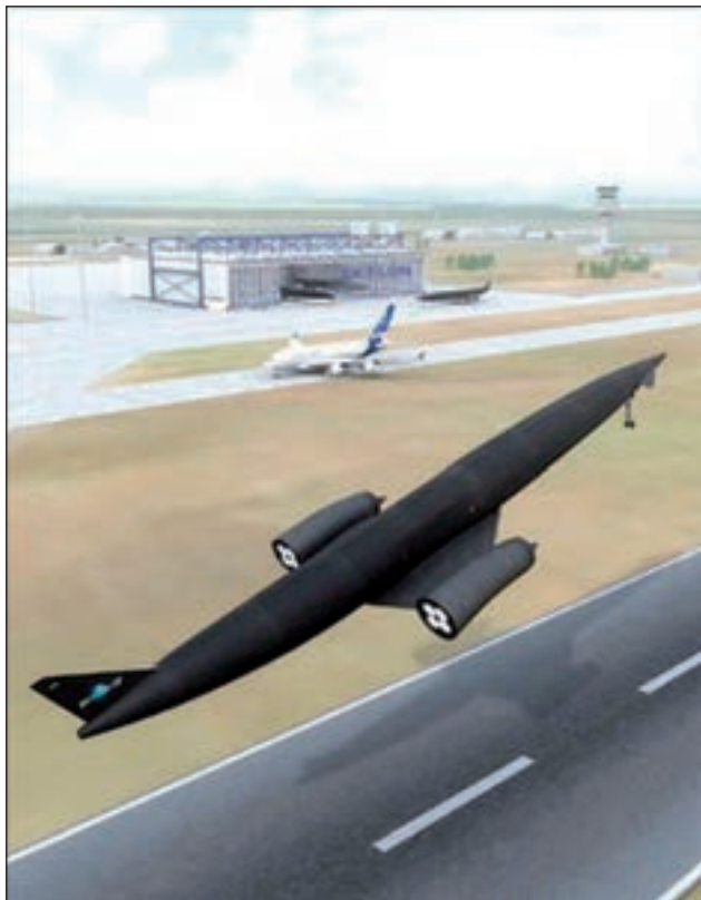
2. ábra. A Skylon űrrepülőgép hagyományos repülőgép módjára képes felemelkedni az utasszállító gépek indítására és fogadására kiépített repülőterekről (terv)
