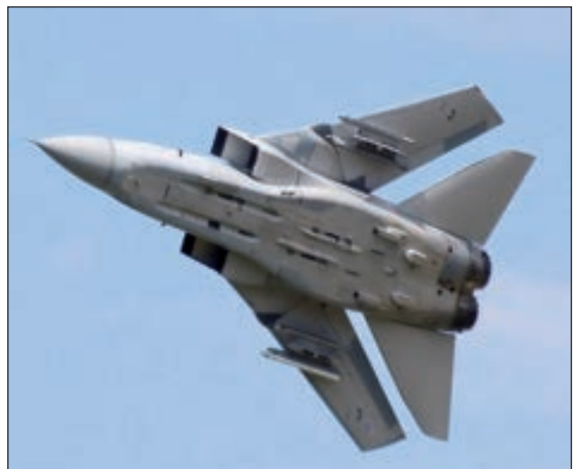
9. ábra. Tornado F3 alulról. Jól láthatóak a félig besüllyesztett, közepes hatótávolságú légi harc-rakétáknak kialakított függesztőpontok
