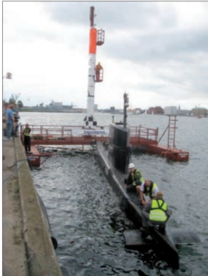
8. ábra. A dán rakéta úszó indítóplatformján, a platformot a helyszínre vontató, Peter Madsen által épített Nautilus tengeralattjáróval
