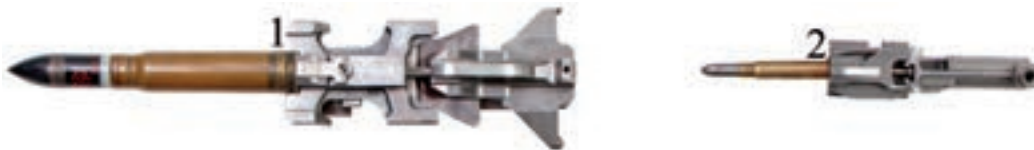
4. ábra. Zár-szerkezetek (1. 20 mm-es kísérleti nehéz géppuska, 2. 1934/ 37 M. 8 mm-es megfigyelő géppuska zár-szerkezetei)
