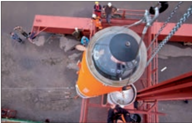
7. ábra. A dán rakéta felülről, a pilótakabin felől szemlélve. Jól látható, a pilóta milyen kényelmetlen helyzetet foglal el a mindösszesen 65 cm átmérőjű Tycho Brahe kapszulában
