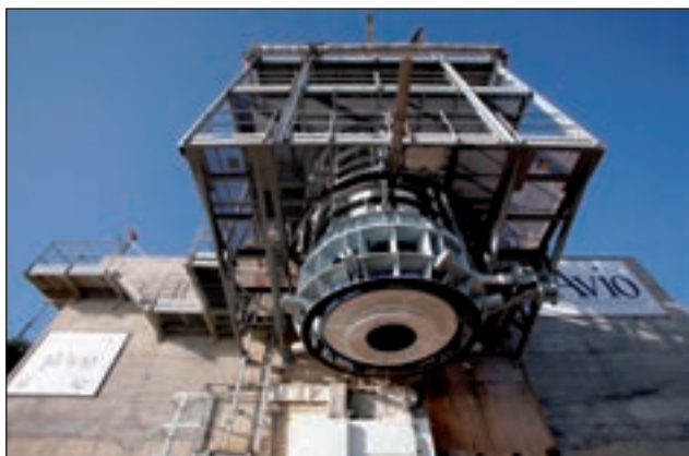
6. ábra. A Zefiro-9A próbájának előkészítése
