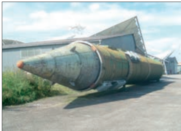
19. ábra. Az SS-24 rakéta hajtóművek nélküli palástja és orrkúpja
