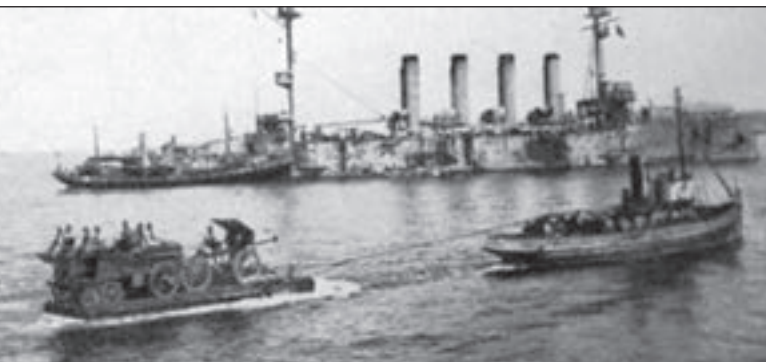
29. ábra. Vontatott partraszállító bárka nehéz tarackkal
