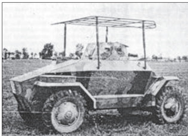
34. ábra. 40 M. Csaba parancsnoki páncélgépkocsi tetőantennával
