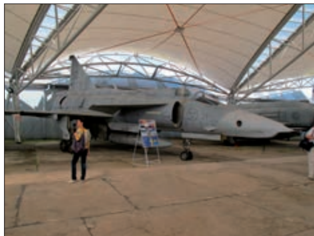
2. ábra. A svéd Saab J37 Viggen harci repülőgép kacsaszárnyal és sugárfordítóval
