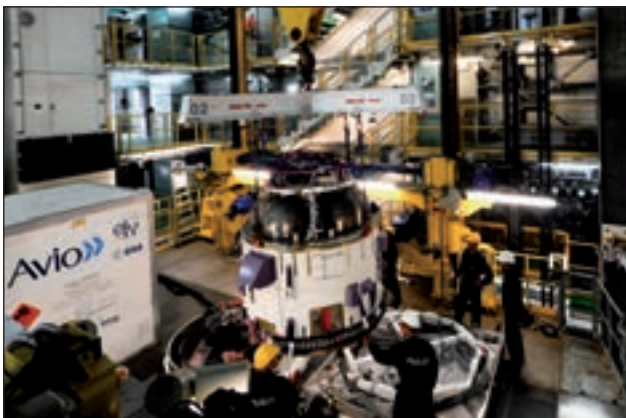
10. ábra. A 4. fokozat felszerelése a kaputoronyban
