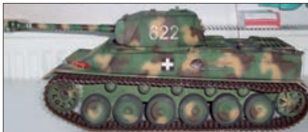
9. ábra. Jól látható a láncfeszítő kerék és lánctartó-görgősor szerkezeti megoldása
