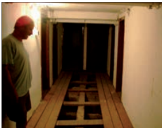
13. ábra. Egy bordákra fektetett, pallókkal borított betonhajó belső folyosója
