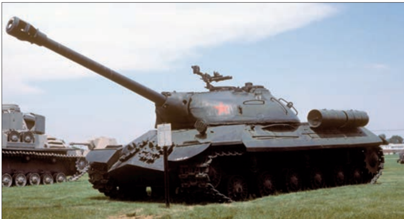
5. ábra. Az 1947-ben sorozatgyártásra kerülő új orosz közepes harckocsi, a T-54, valamint a második világháború végére elkészült, forradalmi formájú JSz-3-as nehéz harckocsi (képünkön) megemelte a mércét, és több mint két évtizeden át voltak a nyugati hadseregek mumusai
