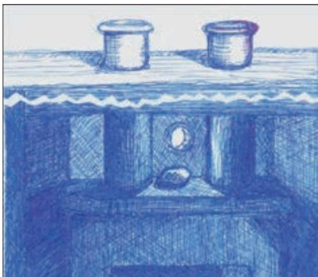
14. ábra. Kikötőbakok erőátvitele a beton héjszerkezetébe
