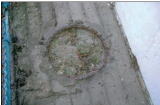
8. ábra. A szegedi betonhajó levágott kikötőbakja és zsaluzástól visszamaradt beton mintázata a fedélzeten
