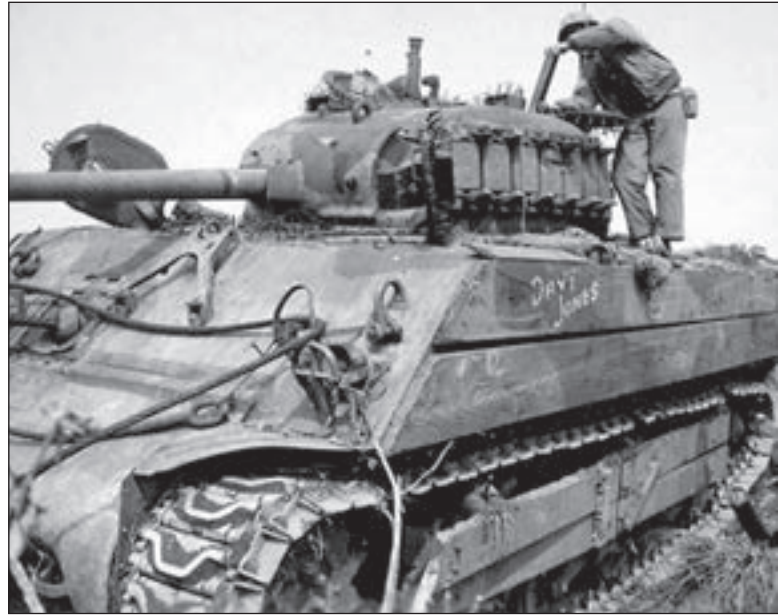
10. ábra. A Japán elleni harcokban 1945-ben használt Sherman páncélos fa kiegészítő páncélzattal
