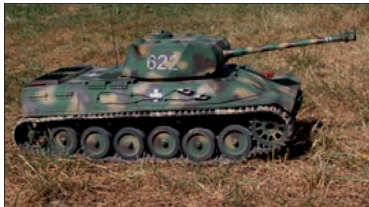
5. ábra. A Tasnál laprugóval támasztott lengőkar-páros felfüggesztést alkalmaztak. Jól látható a vontatókötél
