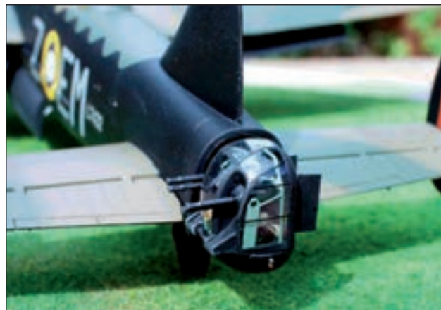
10. ábra. Az osztott vezérsíkok közötti torony négy Browning géppuskája jelentős tüzerőt képviselt
