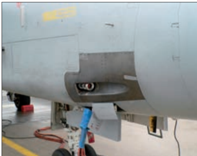
16. ábra. A Tornado ADV beépített tűzfegyvere a 27 mm-es MAUSER BK géppágyú
