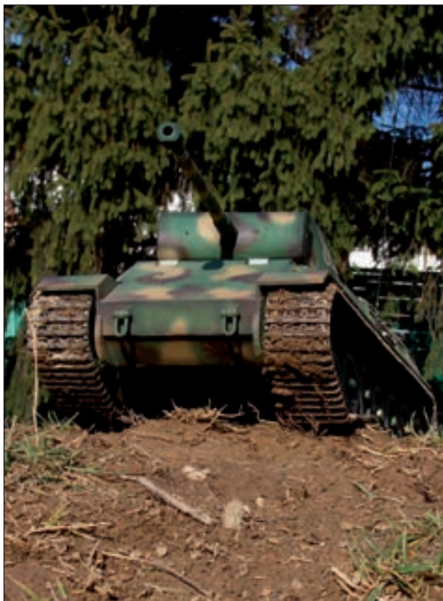
3. ábra. Az erősen döntött homlokpáncél kiváló védettséget nyújtott
