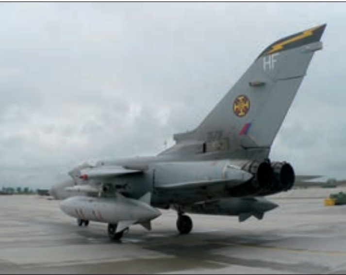
18. ábra. A leucharszi 111. repülőszázad Tornado ADV F3 repülőgépe Kecskeméten. Jól látható a Hindenburger becenevű óriási póttartály és az AIM-132 ASRAAM közelharc rakéta gyakorlíváltozata
