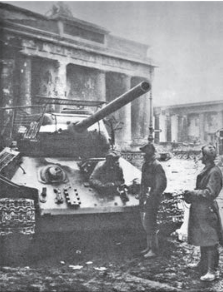
9. ábra. Szovjet T 34/85 harckocsi Berlinben, kézi kumulatív fegyverek elleni acélhálólakkal
