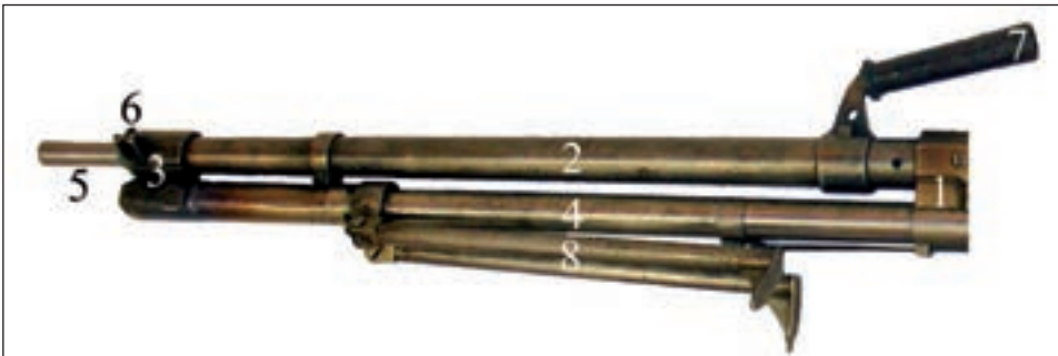
14. ábra. Golyószóró cső (1. tok 2. cső 3. gázhenger 4. gázdugattyú-vezető cső 5. csőtoldalék 6. célgömb 7. hordfogantyú 8. villaállvány (fegyverláb))
