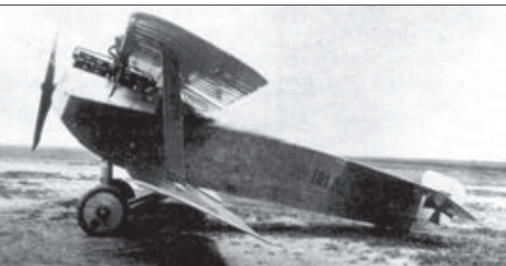
12. ábra. A 161.01-es UFAG C.I prototípus 1917 nyarán Aspernbén. A gép még a keskeny, mély törzzsel, kis oldalkormányral és „I” alakú szárnymerévítővel épült
