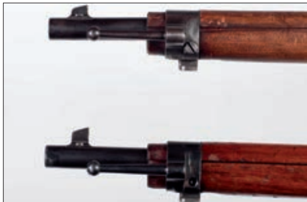
8. ábra. Az 1895/30 M karabély célgömbje (bal oldalon) majdnem kétszer olyan magas, mint az alapfegyvernél
