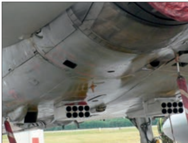
15. ábra. Infracsapda és dipolszoró a Tornado ADV F3 törzsének alsó részén
