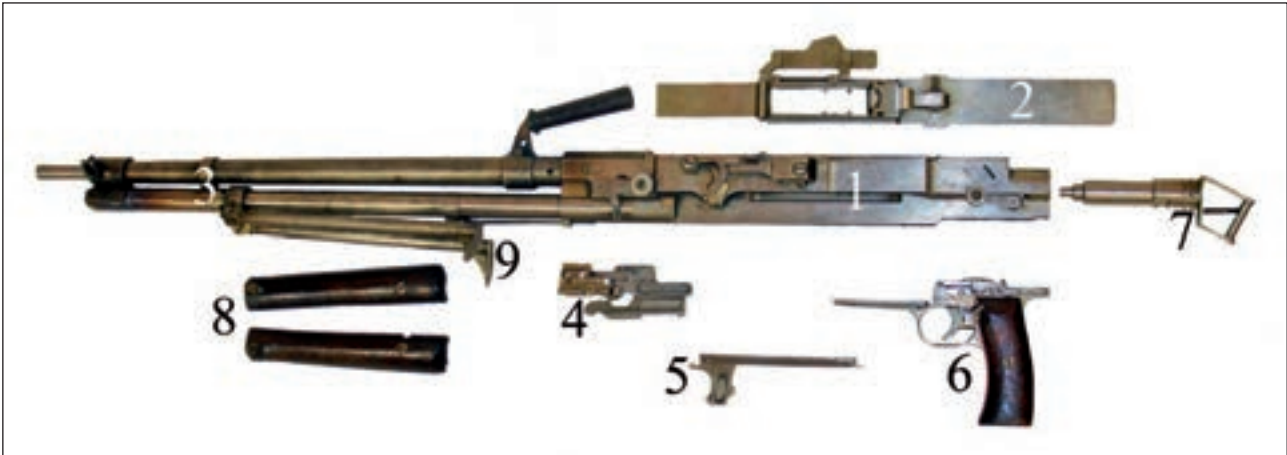
13. ábra. A golyószóró szerkezeti elemei (1. szerelt tok 2. tokfedél 3. szerelt cső 4. zárszerkezet 5. zárvesztő 6. markolat 7. ütközőtok 8. mellsőágy 9. villaállvány (fegyverláb))
