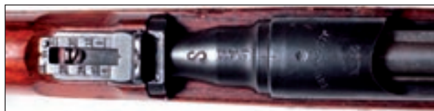
7. ábra. Az 1895/30 M karabély tokján az „S” beütő mellett az is jól látható, hogy a fegyver 1917-ben eredetileg a FGGY-ban készült és 1934-ben alakították át Steyrben
