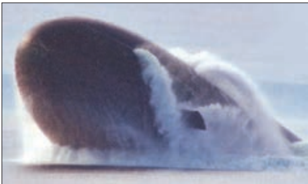
9. ábra. A DOLGORUKIJ nukleáris rakétahordozó tengeralattjáró vészfelmerülési próbája
