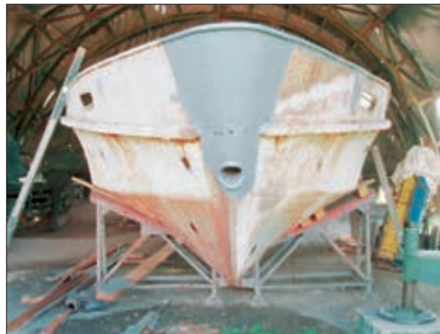
11. ábra. A kigömbült és helyreállított habvédlemez
