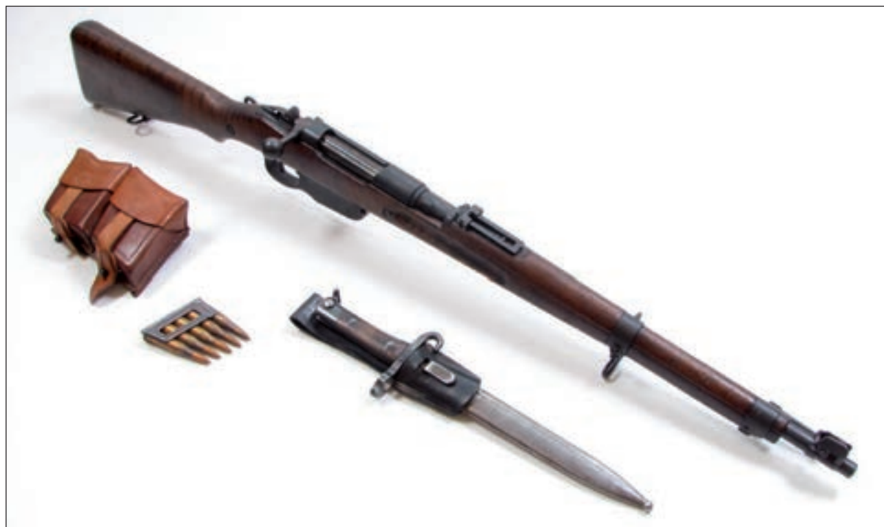
14. ábra. 1931/A M. puska szuronnyal, kettős tölténytáskával és a töltőkeretbe foglalt töltényekkel. A fegyver végén jól látható az 1931 M. célgömbvédő
