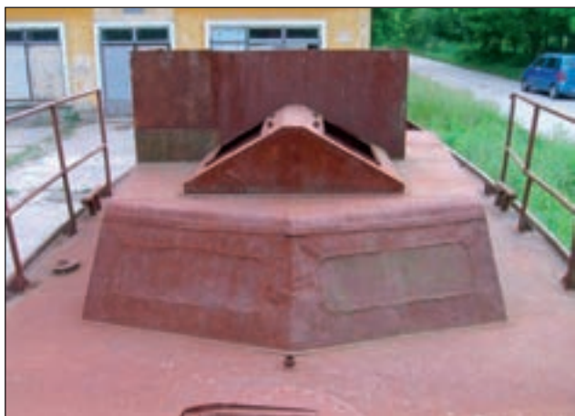
6. ábra. A hajó felépítménye az eredeti kormányállás lehegesztett ablakaival, az utólag ráépített felülvilágító ablakkal és az új kormányállás mellvédjével
