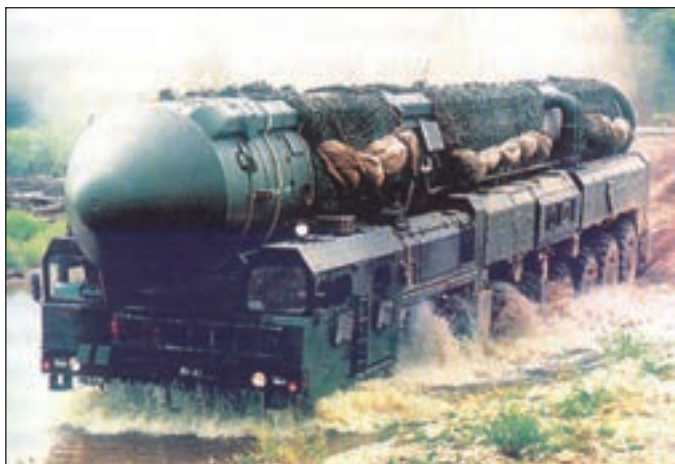
1.ábra. A Topol-M (SS-27; RSz-12M) mobil ICBM rakéta önjáró alvázon
