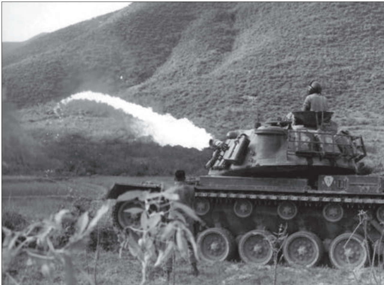
13. ábra. M48 átalakított változata lángvető alkalmazása közben. A „Zippo” lángszóró a harckocsikon egy állóvegcsővön keresztül 200 méteres távolsáig egy percen keresztül „dolgozott”
