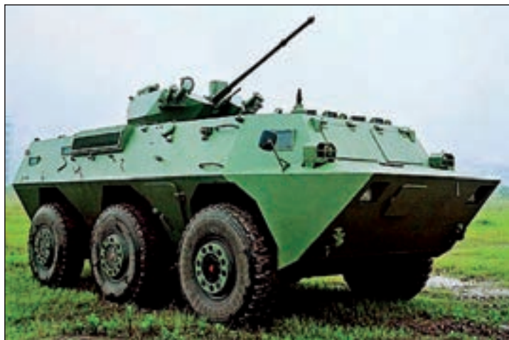
8. ábra. A ZSL 92 (WZ551) típusú harcjármű itt géppágyú fegyverzetrel ellátva
