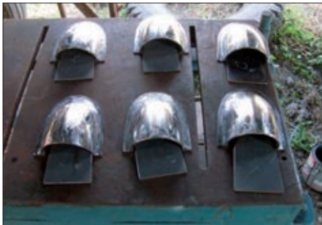
10. ábra. A géptéri szellőzők, ún.: „kopolyuk” kialakítása
