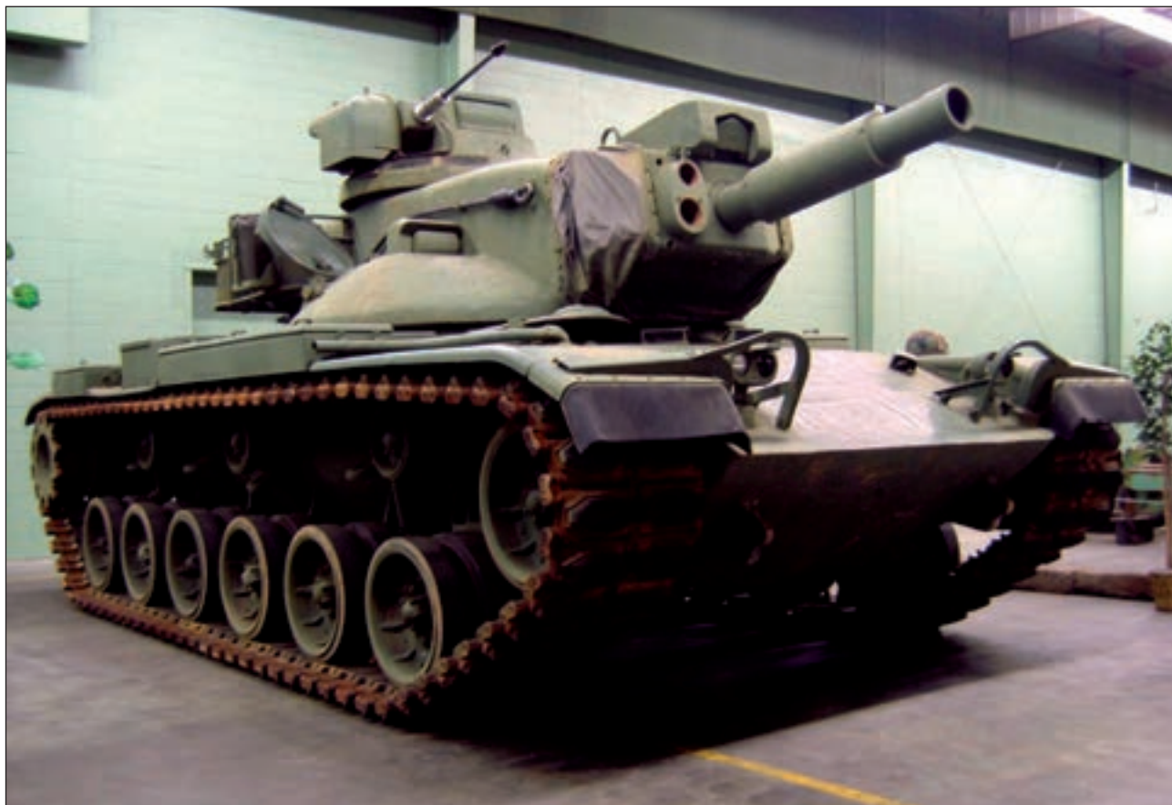
11. ábra. Az M60A2-es kombinált löveg/rakétaindító rendszerétől azt várták, hogy feleslegessé teszi a nagyobb lövegeket és a komplikált, nagy távolságú pontos tüzeléshez szükséges berendezéseket
