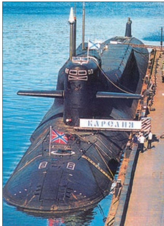
4.ábra. A K18 jelű KARÉLIA Delta IV-es tengeralattjáró 16 db RMU-2 Szinyeva ICBM rakétával van felszerelve
