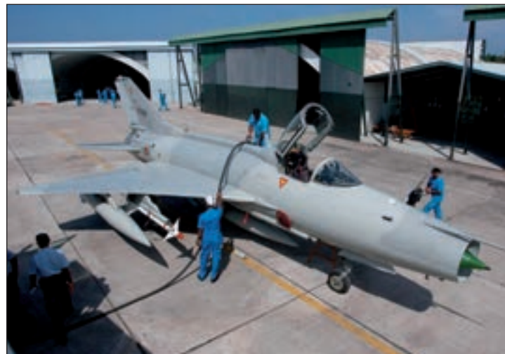
6. ábra. Szingalézek kínai gyártású F-7GS (orosz MiG-21-es másolat) vadászgépe, két darab PL-5E infravörös rakétával, és három 500 literes póttartállyal. A háborúban összesen 550 harci bevetést végeztek, többnyire bombázóként
