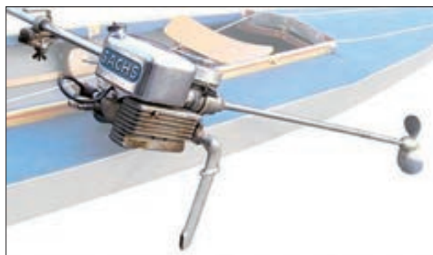
9. ábra. Két lóerős SACHS seprűs oldalmotor 1938-ból
