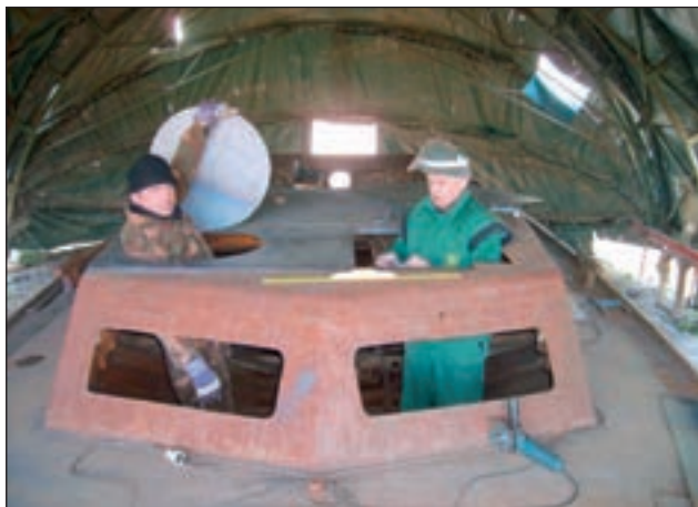
9. ábra. 2012. január végén a kormányállás került kialakításra a búvónyílásokkal.
