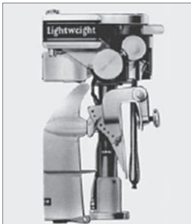
7. ábra. Felhajtható Evinrude csónakmotor 1929-ből
