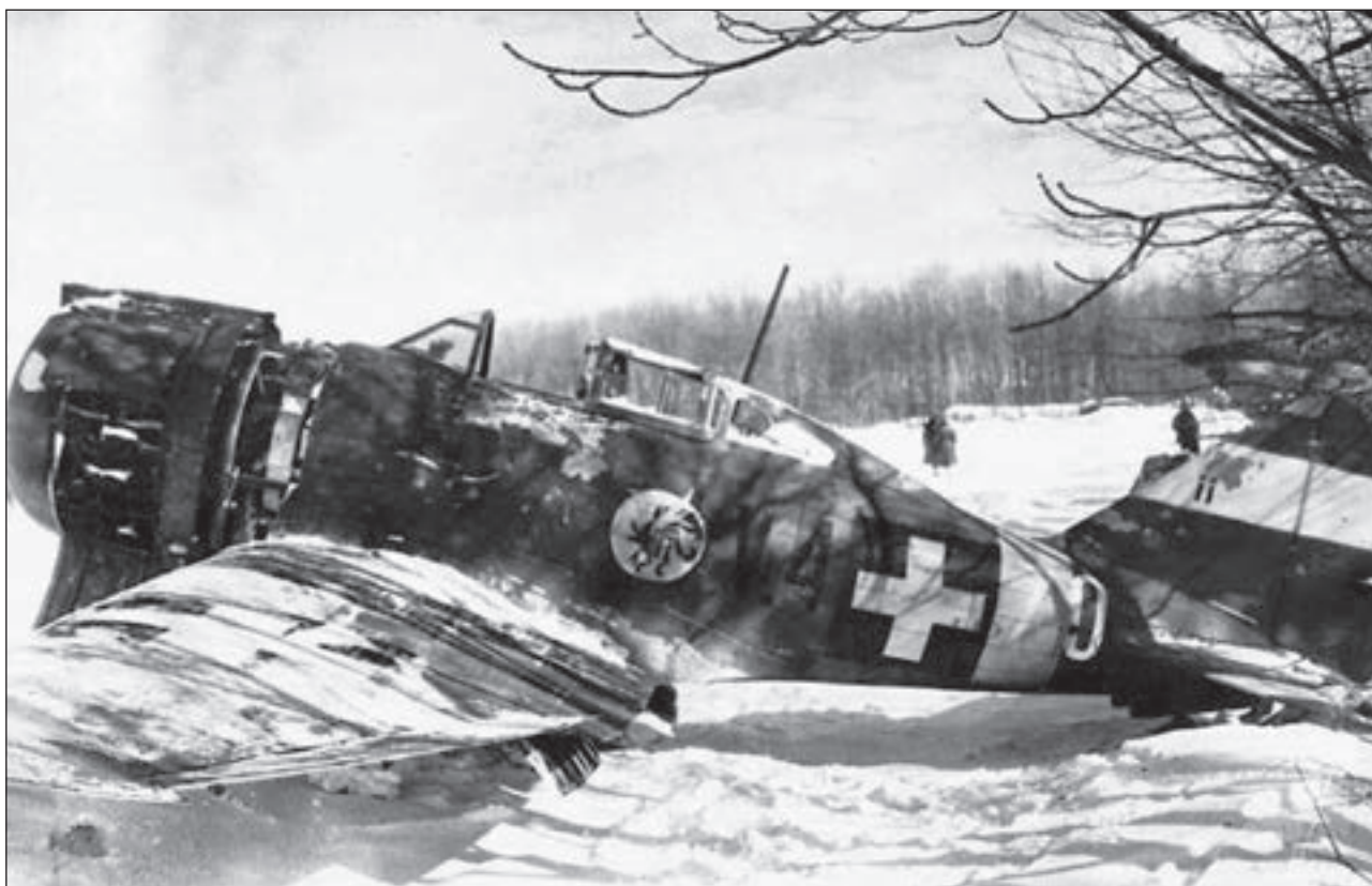
3. ábra. A V.4+70 szovjet kézen. A Héján nincs légcsonny, a nyitott, illetve levett szerelőfedelek nem rongálóak. A terepszín festés több helyen nagy foltokban levált – a kabin szélé alatt, a hónalj lemezen, a függőleges vezérsík belépője mögött több helyen
