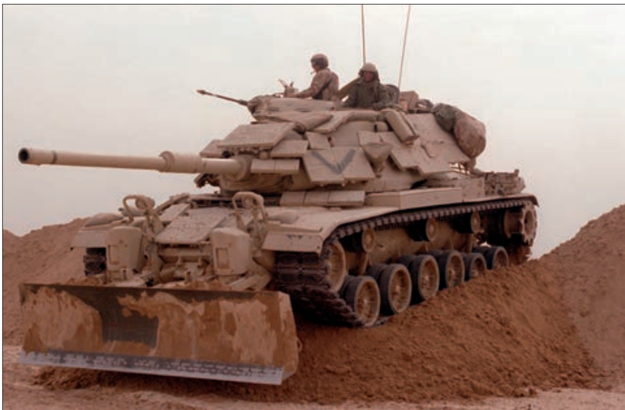
15. ábra. A tengerészgyalogság M60 A1-ese a Sivatagi Vihar hadművelet során robbanó előtét páncélzattal (ERA). A „bőrnyakú” M60-asok legnagyobb csatája a kuvaiti főváros repülőteréért folyt, ahol könnyűszerrel elbántak az iraki T-54-es és T-62-es harckocsikkal
