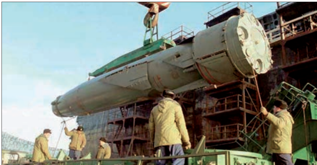
8. ábra. A Gránit típusú, hajó elleni rakéta. Jól látható a víz alatti indítás miatt túlméretezettnek tűnő gyorsító fokozat, a hordozó silót nem lehet újratölteni
