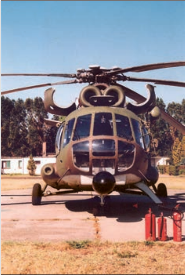
5. ábra. A helikopter az állóhelyen, lehajtott hajtóműtér-lemezekkel
