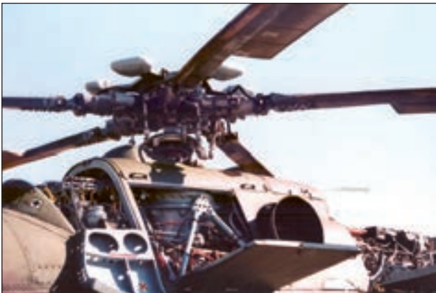
6. ábra. A forgószárnyra vibrációcsökkentő berendezések kerültek, ami kedvezően hat a helikopter és a beépített elektromos berendezések élettartamára és komfortjára
