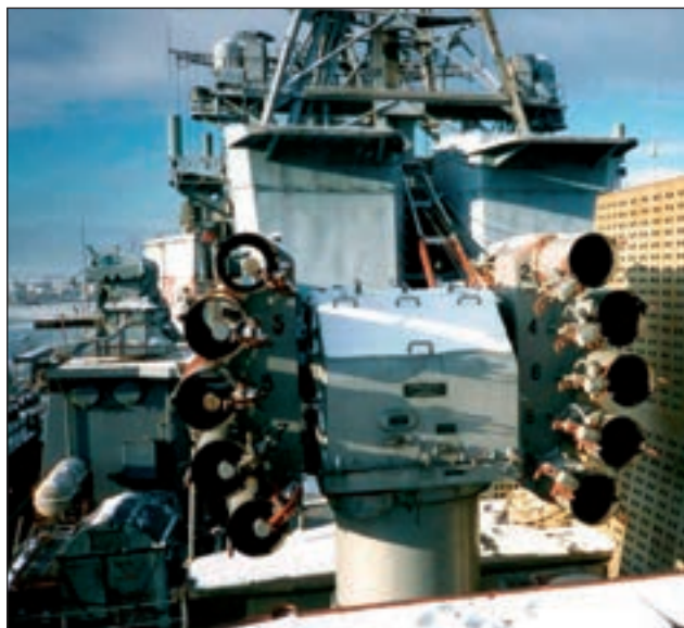
9. ábra. Az RBU-12000 típusú reaktív sorozatvető torony, az UDAV-1 rendszer indítóberendezése
