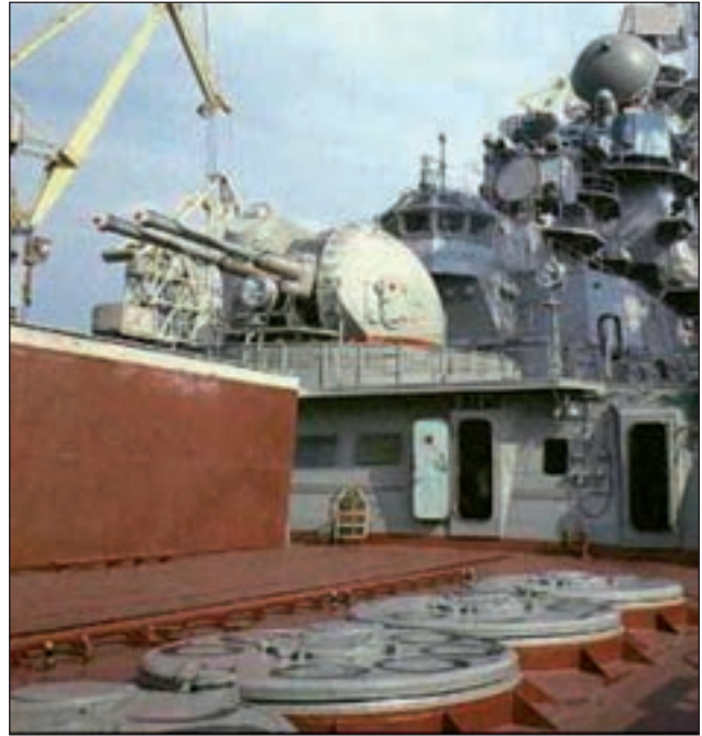
6. ábra. A Korytik indítósilóinak takarófedelei egy orosz hadihajón
