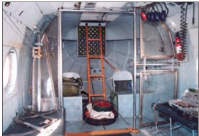
8. ábra. A tehertér végében egy plexi „fal” található, melynek a tehertér-ajtó leszerelésekor, az ejtőernyős ugrások során van jelentősége
