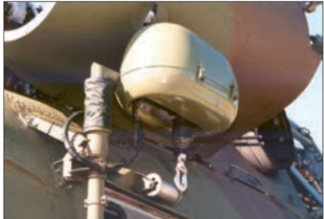
7. ábra. A törzs bal oldalán, az ajtó felett került beépítésre a Breeze típusú fedélzeti csörlő, amelynek üzemi terhelhetősége 272 kg
