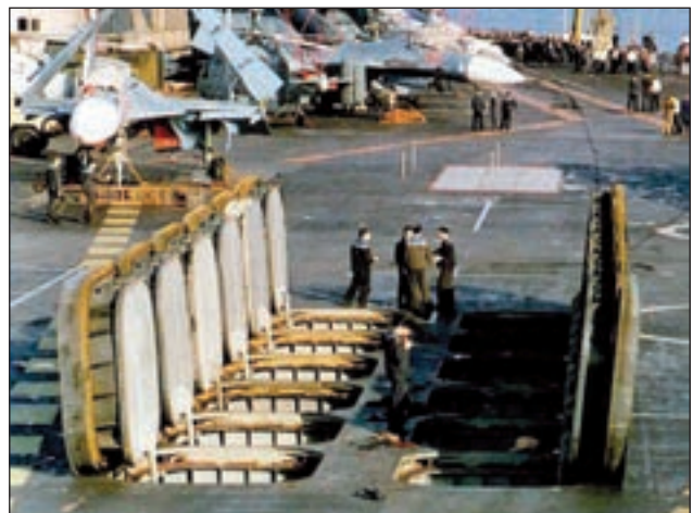
7. ábra. A KUZNYECOV hordozó Gránit robotrepülő-rendszerének silótakaró-fedelei
