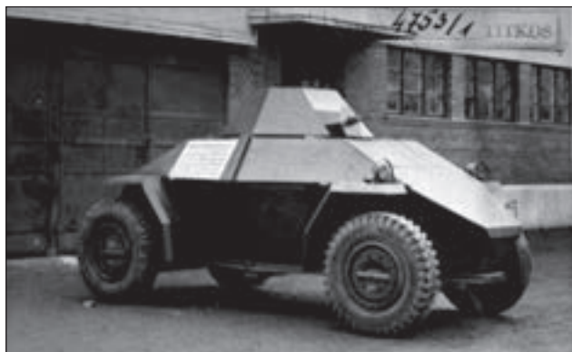
2. ábra. A páncélaútó atrap zárt fedelkekkel
