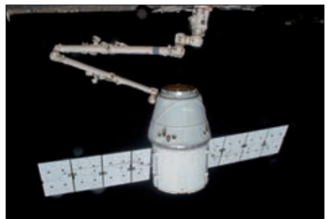
6–8. ábra. A közelítő Dragon-C2 látképe a Nemzetközi Űrállomásról nézve, majd a kanadai robotkar a Harmony modulhoz csatlakoztatja (NASA)
