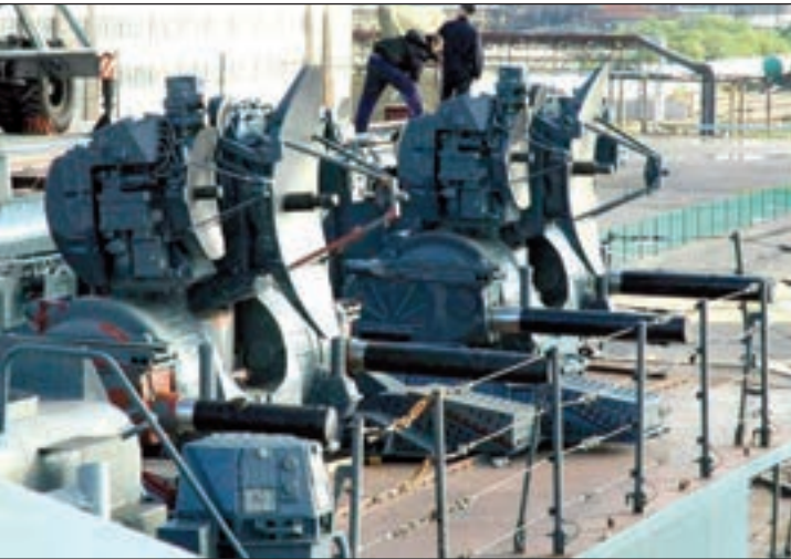
4. ábra. A Korytik légvédelmi tornyok beszerelés előtt
