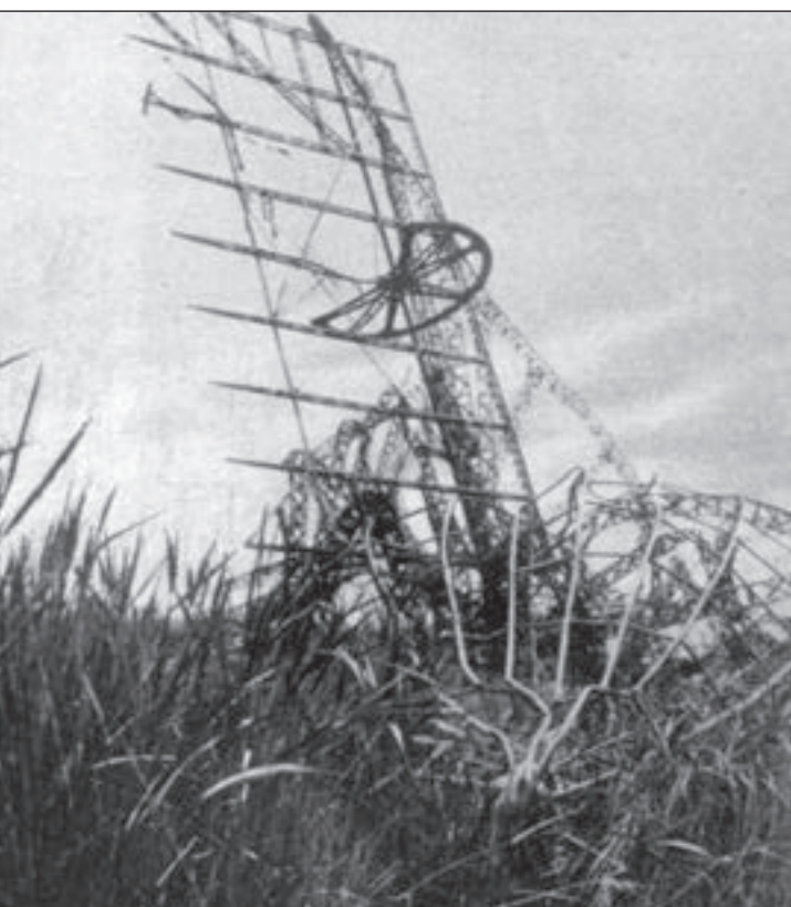
16. ábra. A roncs farokrésze, jól látható az oldalkormánymozgató mechanizmus
