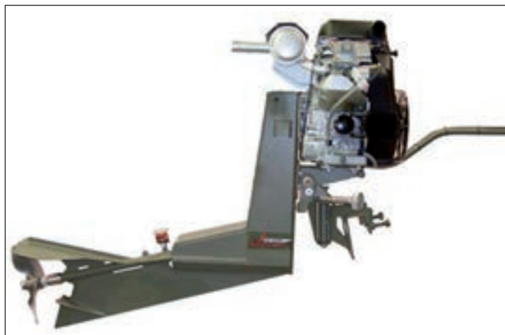
23. ábra. Nyújtott „Z” hajtás kialakítása
