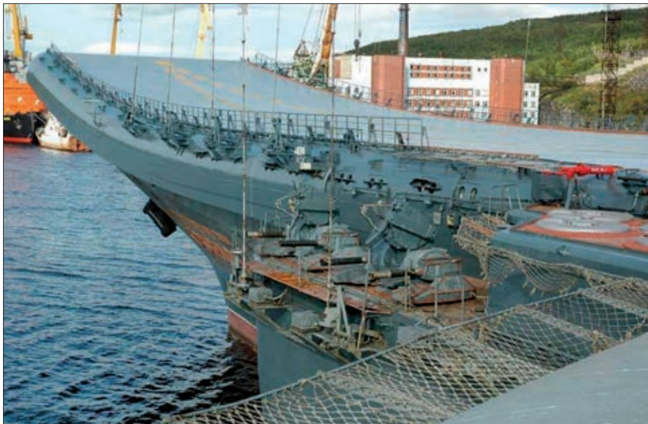
3. ábra. A KUZNYECOV hordozó mellső önvédelmi rendszerei
