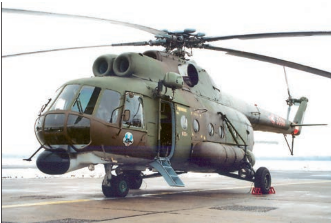
2. ábra. A finn Mi-8-asok egyik fő jellegzetessége az orr alatti radarantenna. A Bendix RDR-1400 fedélzeti radar egyaránt alkalmas időjárás felderítésre és navigációs feladatokra
