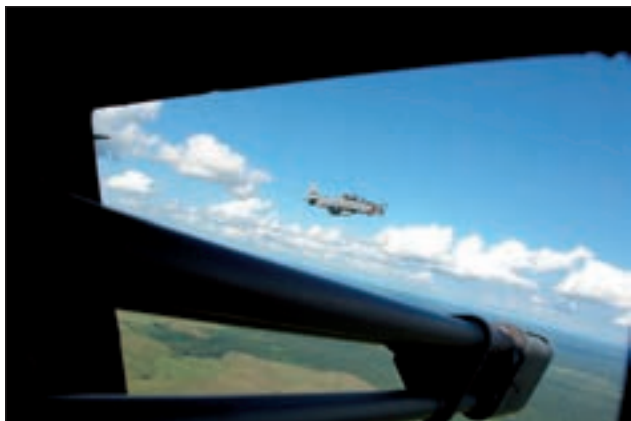
10. ábra. A háromcsövű GAU-19/A géppuska, ahogy a lövészt látja. A Fantasma kísérője ezúttal egy A-29 Super Tucano
