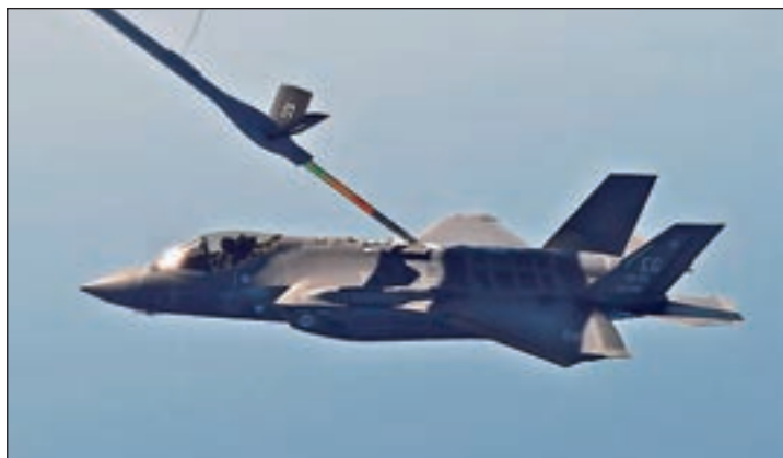
7. ábra. F-35A légi utántöltési próba (LM)
