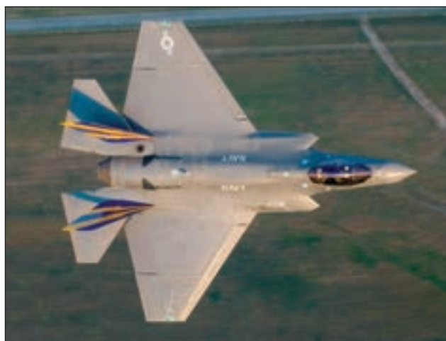
6. ábra. Az első F-35C (CF-1) felülnézetből, látható a kettős csűrő/ív előlap (LM)
