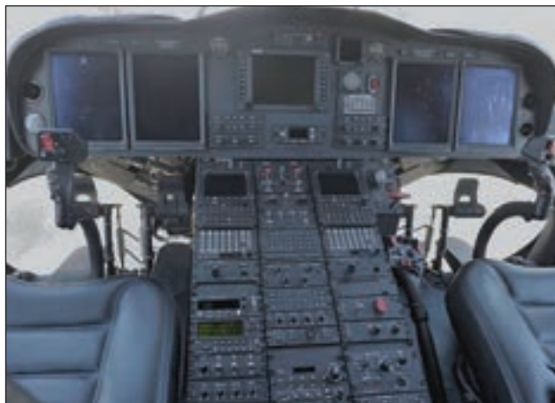
3. ábra. Az AW–139 integrált „glass cockpit” műszerfal rendszere
