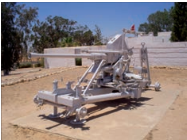
2. ábra. Brit 40 mm-es L/60 Bofors légvédelmi gépágyú hiányos lafetával
