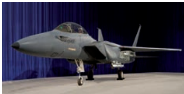
5. ábra. F-15SE az illeszkedő póttartályba helyezett belső fegyvertérrel (Boeing)
