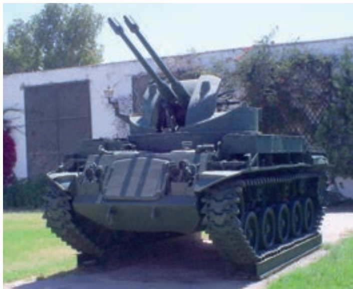
4. ábra. M42 típusjelzésű amerikai 2 x 40 mm-es önjáró légvédelmi gépágyú
