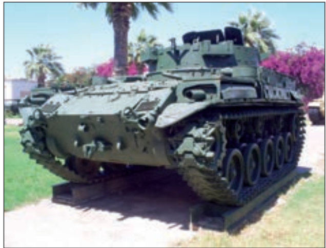
5. ábra. Amerikai M42 ikercsöves 40 mm-es önjáró légvédelmi géppágyú
