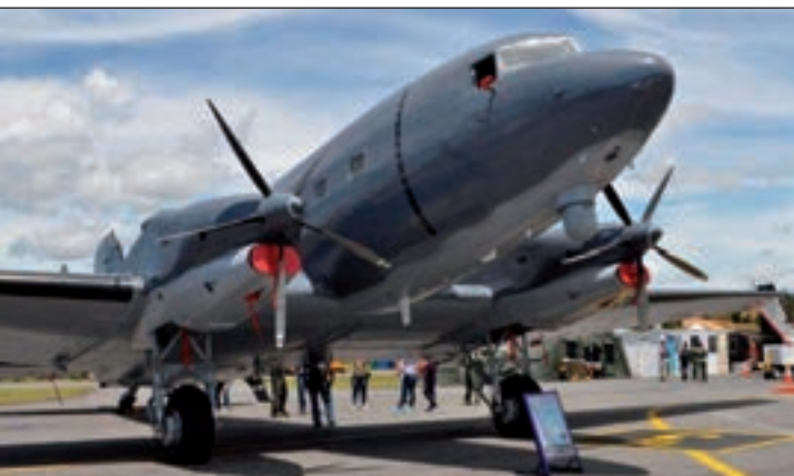
3. ábra. ...és ilyen lett a 2001-es Basler feljavítás után. A pilótafülke alatt a FLIR forgatható gömbje látható
