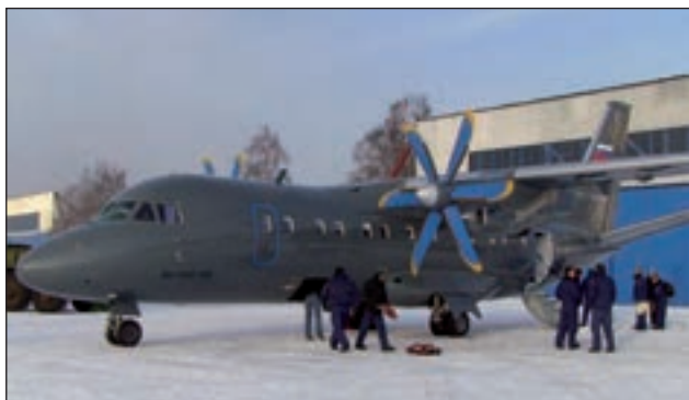
2. ábra. An-140 légcsvaros-gázturbinás könnyű szállító repülőgép
