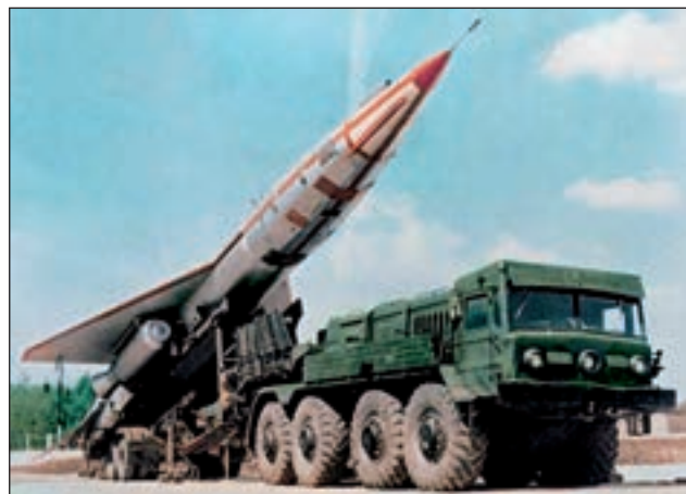
3. ábra. MAZ-535V vontató a DBR-1 Jasztreb robotrepülőgép SzTA-30 szállító-indító járművével
