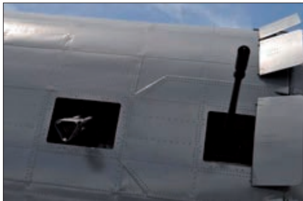
5. ábra. A FAC1658-as egy GAU-19/A géppuskával és egy 20 mm-es M621 géppágyúval
