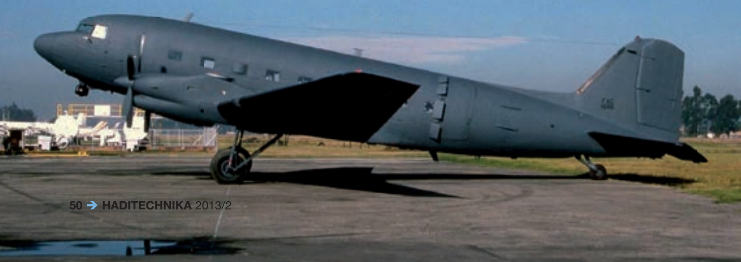
8. ábra. A FAC1686-os egytónusú sötétszürke festéssel. A megnagyobbított tehertér-ajtó és a beépített csörlő utal a repülő egyik feladatára, a légi szállításra. Jól látható a repülő módosított oldal- és magassági kormányza
