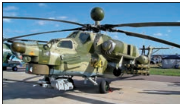
4. ábra. Mi-28N páncélozott harci helikopter harcjárművek elleni fegyverzettel
