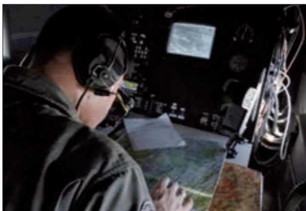
9. ábra. A FLIR kezelőjének munkaállása. Az infravörös kamerával a navigátor képes „meglátni” a fák lombjai alatt bujkáló fegyvereseket
