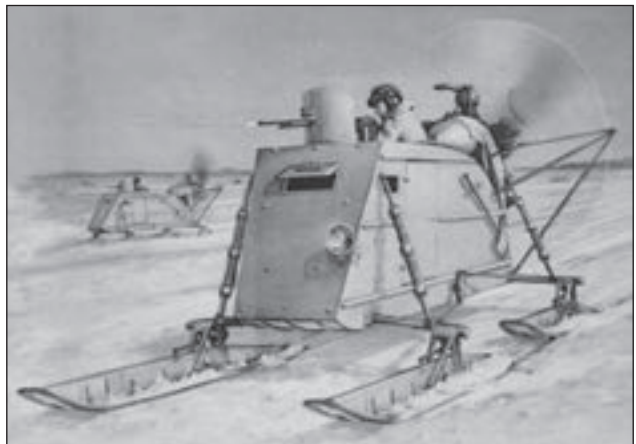
5. ábra. A talán legjobban bevált szovjet katonai motoros szán, az NKL-26 rajza
