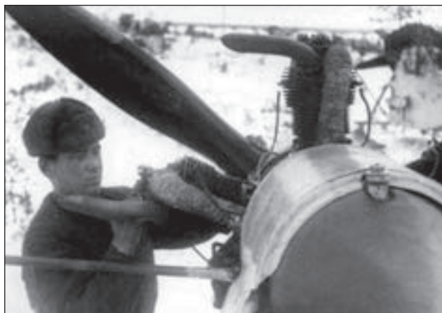
7. ábra. Az NKL-16 szán M-11 csillagmotorja. Érdekes a hengerek szívócsöveinek szigetelése, amellyel az erős hidegben indításkor a szívóvezetékek eljegesedését kívánták csökkenteni
