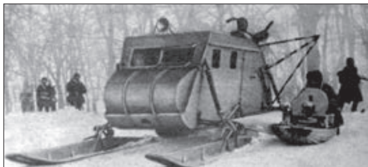
2. ábra. Az NKL-16/1941 szán, az oldalához rögzített csónaktestben egy Maxim géppuskás lövésszel. Egy katonai jármű esetében nehezen magyarázható módon az üzemanyagtartály a homlokfal előtt kapott helyet
