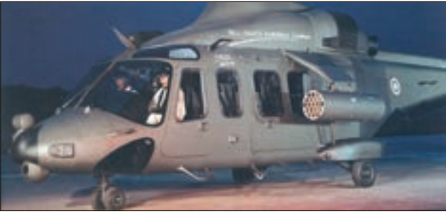
7. ábra. Jól látható a nem-irányított rakéták indítóblokkja a helikopter törzse melletti konzolra függesztve
