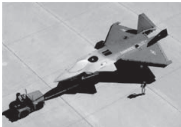
1. ábra. Egy korai STOVL harci repülőgép elképzelés emelőventillátorral
