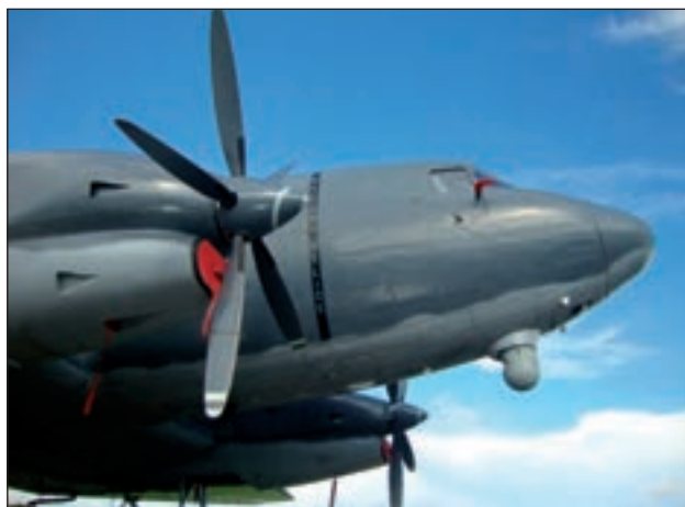
4. ábra. A PT6A-67R légszavas gázturbina és az ötágú (a régi háromágú volt) légszavar alkalmazásával a repülőgép nagyobb hatáskörrel és megbízhatóbban repült, és nem utolsó sorban jóval halkabban
