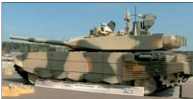
12. ábra. T-90AM harckocsi új típusú toronnyal és kötényezéssel
