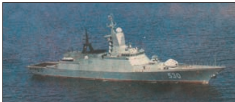
7. ábra. SZOVREMENNIIJ osztályú fregatt gázturbinás hajtással és helikopter leszállóhellyel, STEALTH jellegű hajófelépítménnyel
