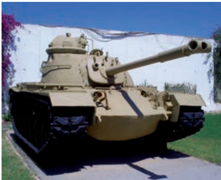
1. ábra. Korai amerikai M-48A2 Patton típusú közepes harckocsi 90 mm-es löveggel és 12,7 mm-es kupolás géppuskával
