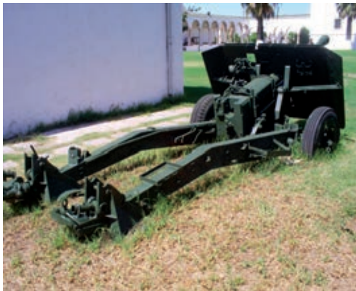
6. ábra. Az 1942-ben kifejlesztett brit Mark I. 17 fontos (76,2 mm-es) vontatott páncéltörő ágyú
