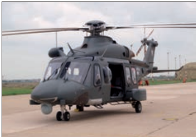
10. ábra. A helikopter nagyméretű oldalajtói előnyösek a katonai felhasználás során (Fotó: Kelecsényi István)
