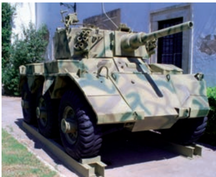
2. ábra. Brit 6 x 6-os meghajtású Saladin MK.1 felderítő páncélgépkocsi 76 mm-es löveggel
