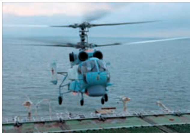
6. ábra. A Ka-27 koaxiális rotorú haditengerészeti helikopter lokátorral felszerelt variánsa
