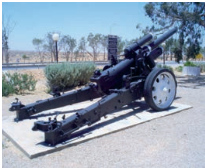
5. ábra. Német 1918 M 15 cm-es űrméretű vontatott tarack hátrahúzott csővel
