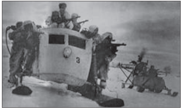
4. ábra. Az előtérben egy NKL-16/1942 légcavarhajtású szán látható, álcázóköpenyes lövészekkel
