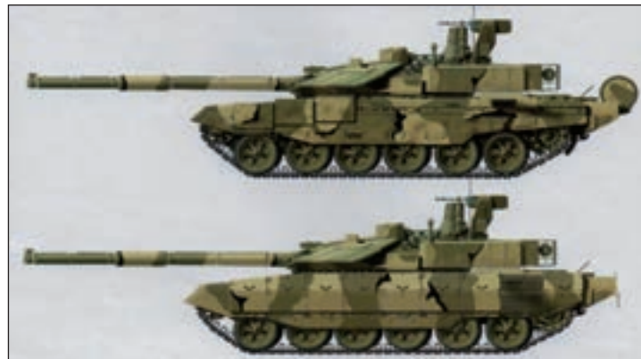
11. ábra. T-90M harckocsi döntött előtépáncéllal és távvezérlésű géppuskával
