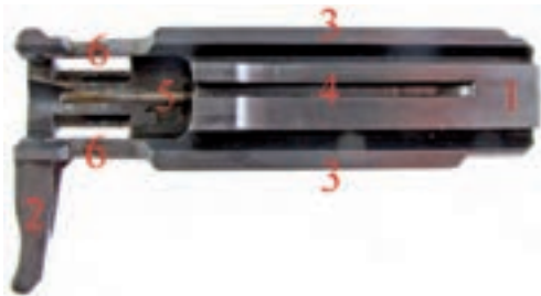
17. ábra. A zárvető 1. zárvezető, 2. felhúzó fogantyú, 3. vezetőléc, 4. kivető horony, 5. ütőszeg a zárkészítő rugóval, 6. reteszvezérlő-pálya
