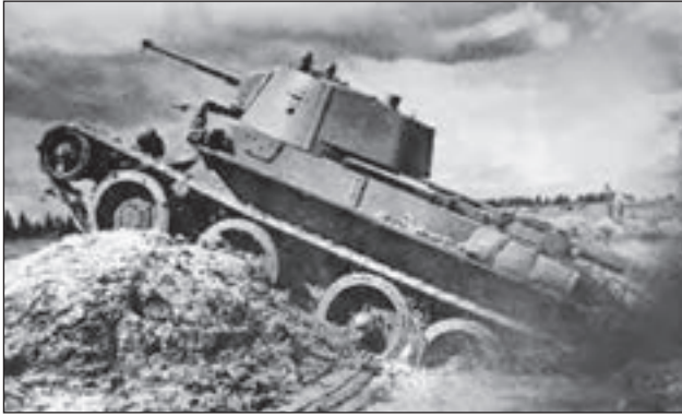
2. ábra. A T-34-es 1942-es tömeges megjelenéséig rendszerben tartott BT-5 könnyűharcoski gyors volt ugyan, de 13 mm-es homlok- és oldalpáncélzata messze nem biztosított számára elegendő védeltséget a német harckocsik és páncéltörő lövegek tüzeivel szemben
