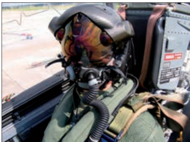
22. ábra. Az F-35 eredeti sisakja tesztelés közben (LM)
