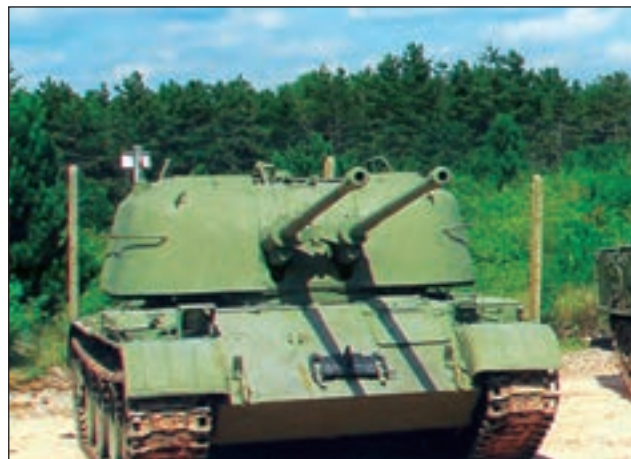
16. ábra. ZsU-57-2 önjáró légvédelmi gépágyú-komplexum lánctalpas alvázon. A magyar példányok 4 db kivételével Finnországba kerültek
