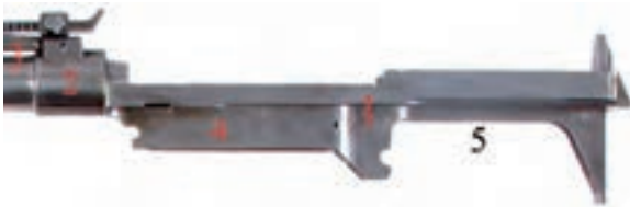
16. ábra. Ismétlő puska tok 1. tok, 2. csőfogalvány, 3. szerelt cső, 4. tárfészek, 5. elsütőberendezés fészek
