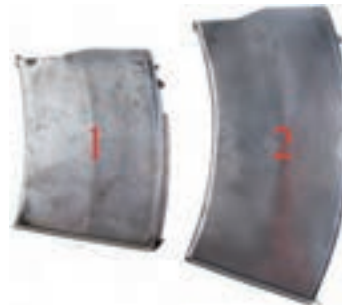
22. ábra. A tár két változata Az 1. tölténytár tíz, a 2. tizenöt darab töltény befogadására képes
