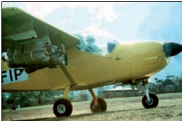
15. ábra. Von Rosen gróf Biafra Baby gépei közül az egyik, becsomagolt SNECMA68B nem irányított rakétákkal
