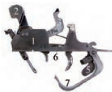
20. ábra. Az elsütőberendezés 1. elsütőház, 2. kakas, 3. kikapcsoló emelő, 4. elsütőbillentyű, 5. tűzváltó, 6. elsütőemelő (hátsó nyúlványa), 7. sátorvas
