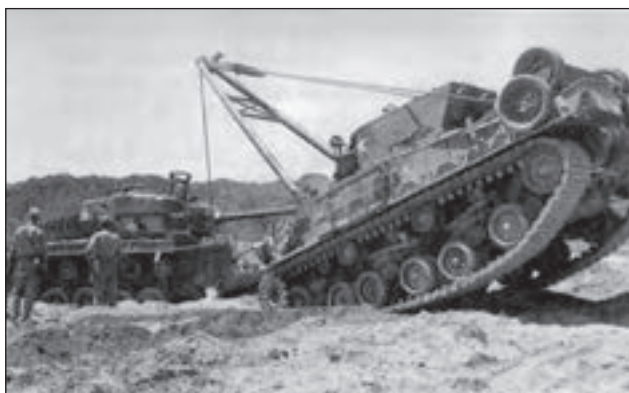
1. ábra. M32B3 harckocsi-mentő jármű Sherman alvázon – a sár miatt az M26-os lánctalpját levették
