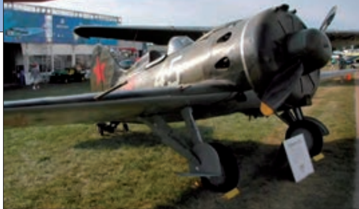
7. ábra. Az 1941-ben még mindig a szovjet vadászlégierő gerincét képező nyitott fülkés I-16 típus sebessége és csúcsmagassága kétharmada volt a Me 109-ének és fegyverzete is messze elmaradt a német vetélytársától
