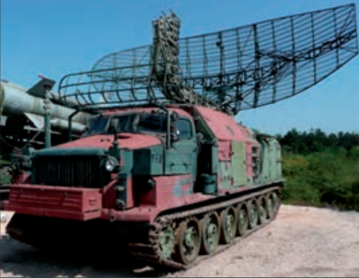
8. ábra. A Krug légvédelmi rakétarendszer osztályparancsnoki harcjárműve, az 1Sz12 típusú távolságmérő lokátor, amelyben a kialakított munkahelyekről három-hat alegység tűzét vezethették. A harcjármű parancsnoki oldalán látható teleszkópos antenna továbbította az alegységek felé a célparamétereket és parancsokat. A P-40 típusú radarrendszer 1R128 típusú távolságmérő állomásán ez nem volt, különben a két berendezés teljesen egyforma kívülről
