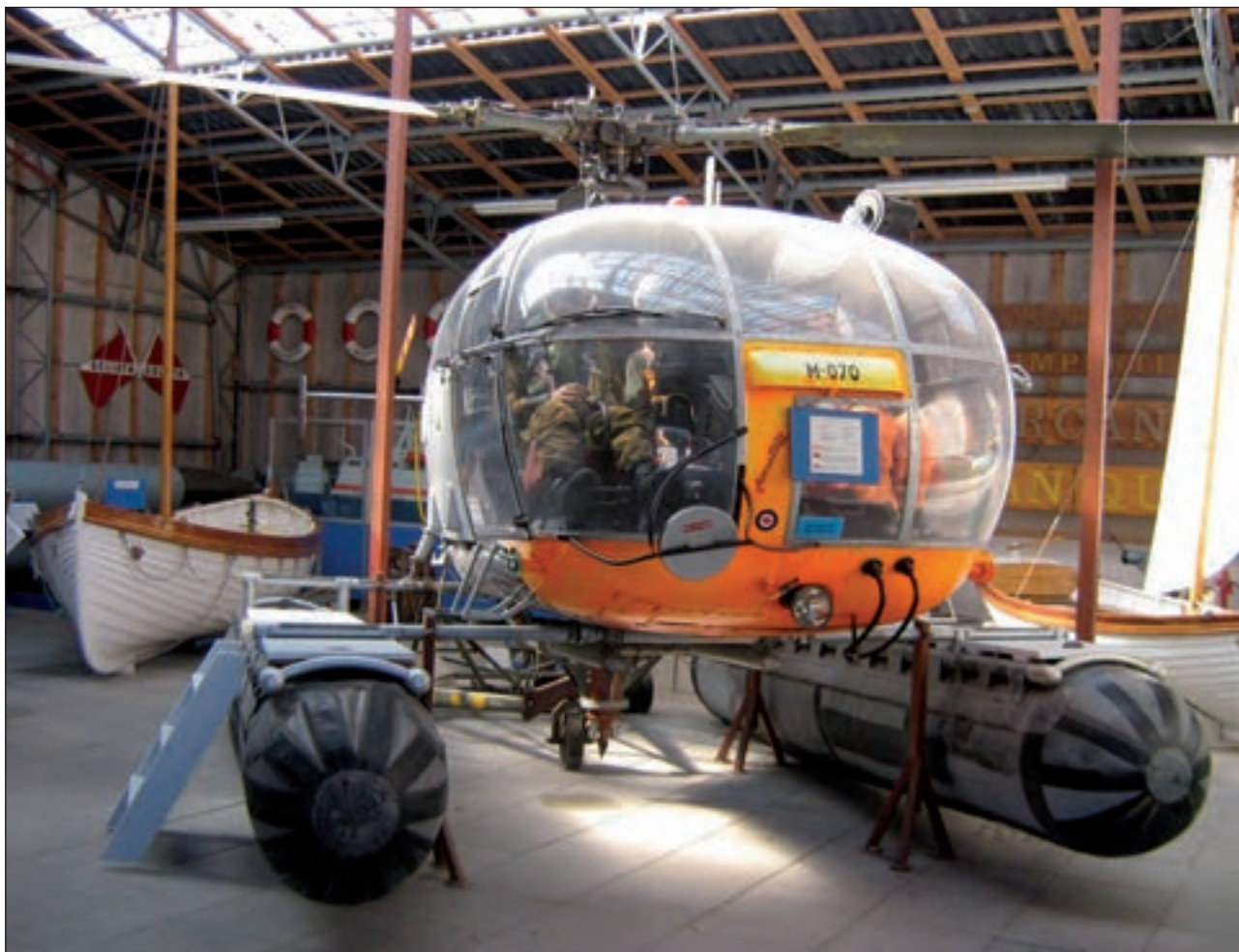
7. ábra. Alouette III helikopter felfújható, vízreszálló talpakkal
