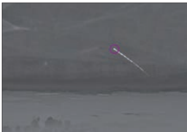
18. ábra. Az AN/AAQ-37 egyik érzékelője által „elfogott” rakétaindítás (Northrop-Grumman)
