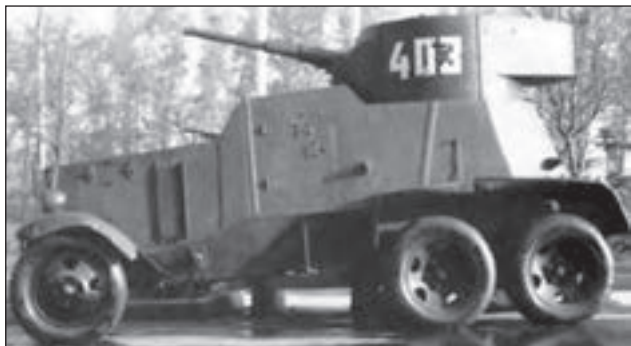
6. ábra. A vékony páncélzatú, kerek futóműve miatt gyenge terepjáró-képességű Ba-6 páncélgépkocsira egy T-26 harckocsi tornyot szereltek fel, ami kedvező tűzerővel bírt ugyan, de borulásra hajlamosá tette az 1941-ben tömegesen bevetett járművet
