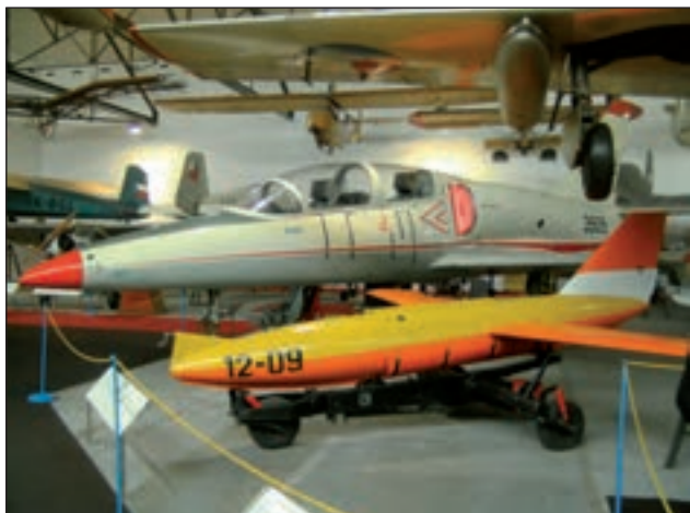
5. ábra. Letov KT-04 célgép és speciális L-39 vontatója. A felszállás a kocsiról történt, ami 50 cm magasan leoldódott
