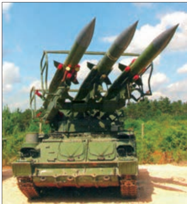
5. ábra. Kub légvédelmi rakétarendszer lánctalpas önjáró indítóállványon. Az áramellátást álló helyzetben egy hátul elhelyezett kisméretű gázturbina biztosítja
