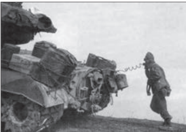
5. ábra. Egy gyalogos katona használja az M26-os harckocsira felszerelt gyalogsági telefont
