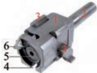
18. ábra. A zár 1. zárttest, 2. zárvezető, 3. retesz, 4. kivető horony, 5. peremág, 6. hüvelyvono
