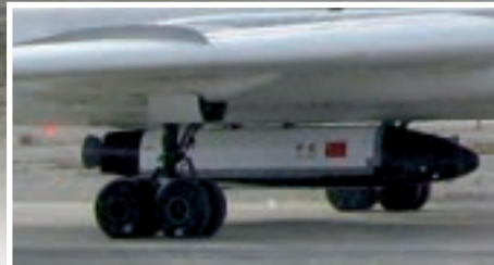
2. ábra. Közelebbi kép a Senlong robot-űrrepülőgép prototípusáról, a kínai H-6 bombázóhoz rögzítve, közvetlenül egy siklási kísérlet előtt, 2007 decemberében
