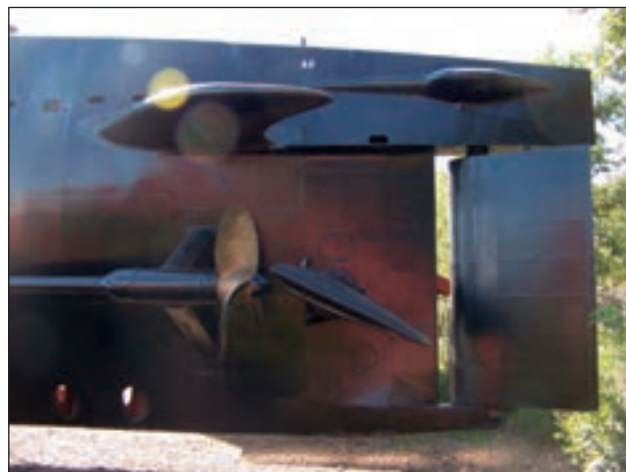
9. ábra. A „Springeren” tengeralattjáró hátsó része a hajócsavarral és a kormánylapokkal
