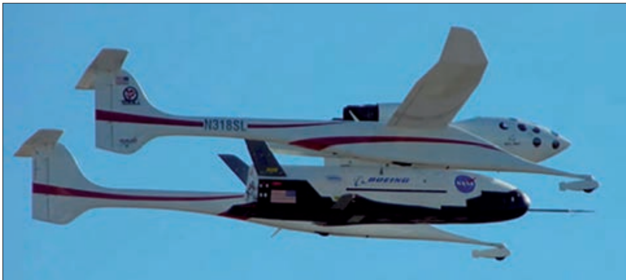
4. ábra. A White Knight-1 által szállított X-37B az egyik siklási kísérlet során
