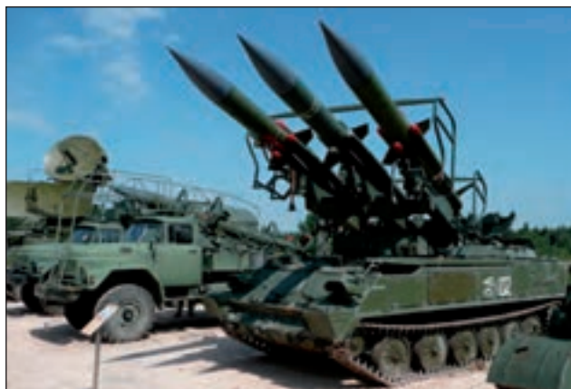
4. ábra. Kub légvédelmi rakétarendszer elemei elől az indítóállvány három rakétával, mellette töltő-szállító harcjármű, háttérben a rakétaráveztő állomás
