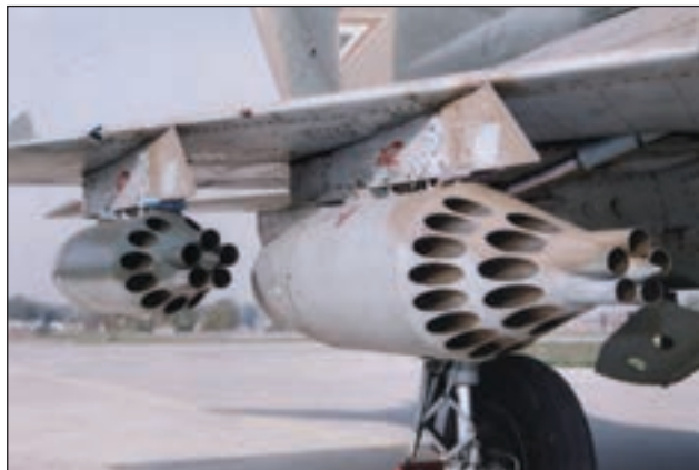
15. ábra. Nem irányított rakéták blokkjai MiG-21 harci repülőgépen függesztve
