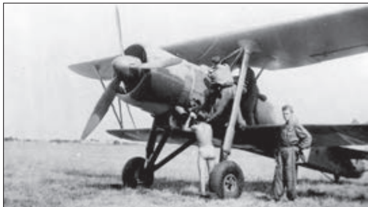
8. ábra. WM-21 Sóló közelfelderítő repülőgép műszaki előkészítése. A repülőgép 14 hengeres késői változatának 1050 LE teljesítményű csillagmotorja szintén hazai gyártású volt
