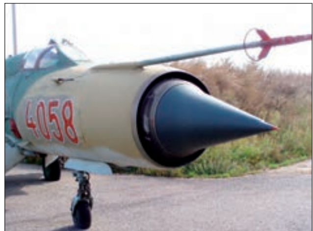
12. ábra. A MiG-21bisz szívócsatornájának beömlő nyílása a légáram szabályozott beáramlását biztosító mozgatható központi testtel, amely egyúttal a lokátort is tartalmazta
