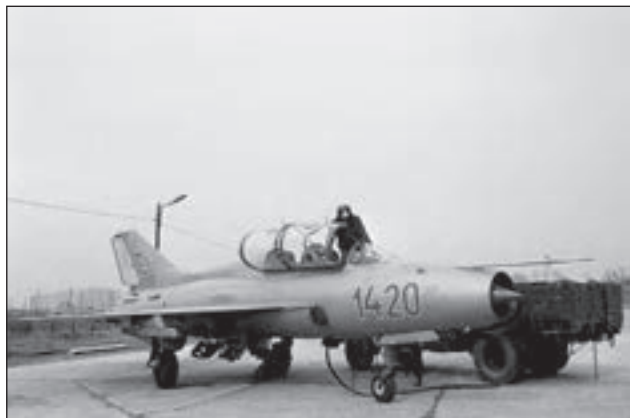
7. ábra. A hajtómű indításhoz szükséges elektromos áramot biztosító APA kocsi egy kétüléses UTI kiképzőgép mellett (B.L.)
