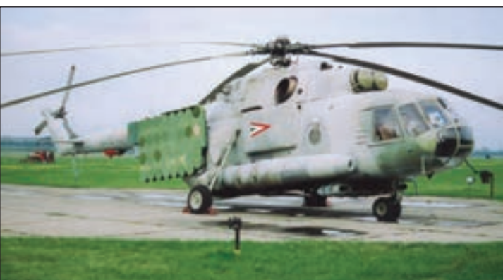
11. ábra. Mi-17 helikopter nagy teljesítményű elektronikai zavaró berendezéssel ellátott változata (B.L.)
