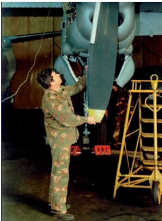
16. ábra. A légszavár ellenőrzése az An-26-os repülőgépen
