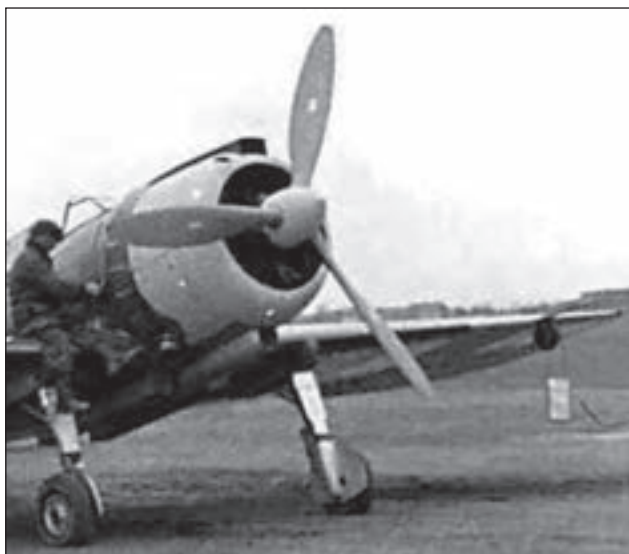
10. ábra. A „Pittinger-incidens” utáni festéssel ellátott Héja az olajradiátor levegőcsatornája mellett felszerelt bombatartókkal. A fotón egyszerűsnek látszó elem valójában 2 db, szorosan egymás mellé szerelt tartógerenda
