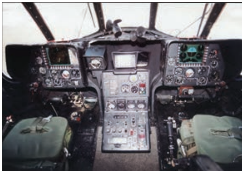
5. ábra. A Mi-17 N helikopter fülkéje és műszerfala, amely már korszerű kijelző felületeket is tartalmaz (B.L.)
