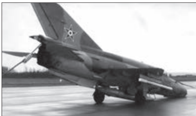
7. ábra. A 3732-es oldalszámú MiG-21bisz balul sikerült leszállása. A repülőgép farokrésznél, a függőleges vezérsík alatt becsatlakozva megfigyelhető a fékernyő kötél
