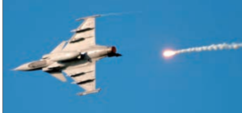
9. ábra. Infracsapdavités a Gripenről az ellenfél által indított infravörös irányítású rakétafegyverzet megsemmisítése érdekében
