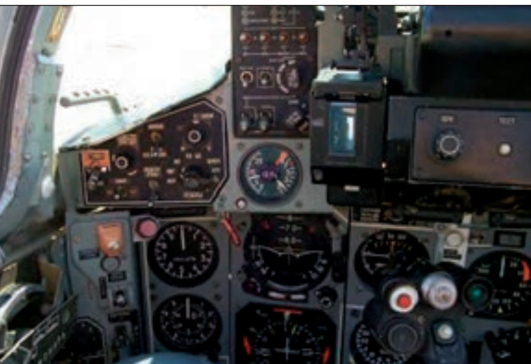
7. ábra. MAK-III metrikus-angolszász konverter beépítése MiG-29 repülőgéphez
