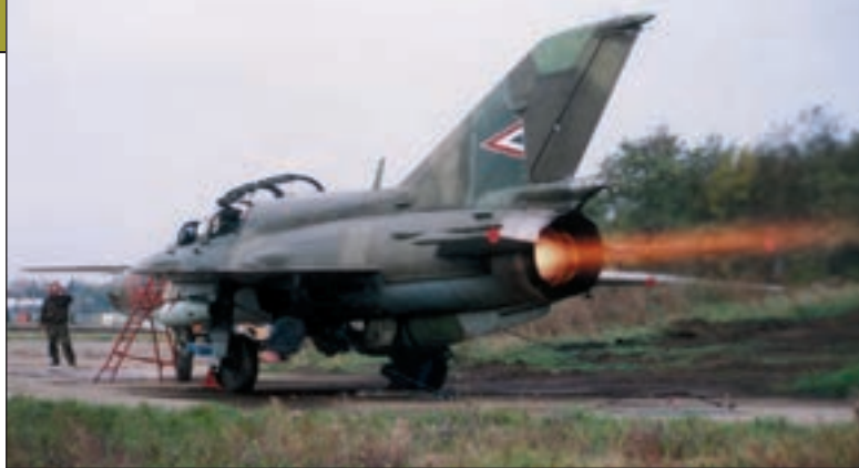
3. ábra. Drótkötelekkel rögzített MiG-21UM kiképző repülőgép hajtómű ellenőrzése forszázs üzemmódon (B.L.)
