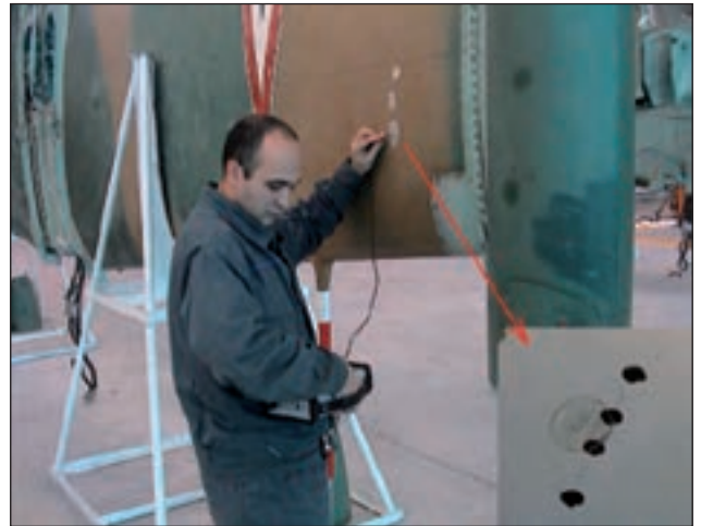
15. ábra. Ultrahangos repedésvizsgálat az L-39-es repülőgép szárnyán
