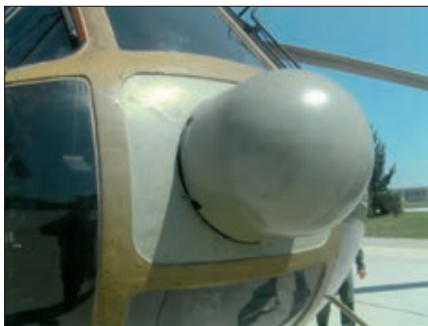
13. ábra. A Mi-17N legfeltűnőbb külső jellegzetessége a radarantenna burkolata (S.Z.)
