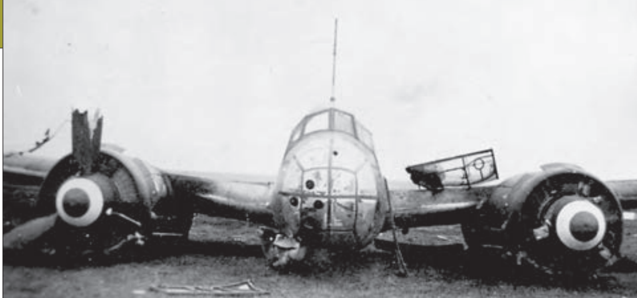
2. ábra. A 3/1. bombázó repülőszázad egy hasra szállt Ju 88 C-6 romboló alváltozatú gépe 1943 őszén, a keleti hadszíntéren. A fémmorrú gépre az üvegorrot imitáló festés a szovjet vadászok megtévesztésére került fel.
