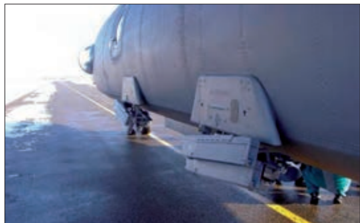
10. ábra. ASzO-2V-26M infracsapda-kilövő rendszer tervezése, gyártása és felépítése az An-26-os repülőgépre
