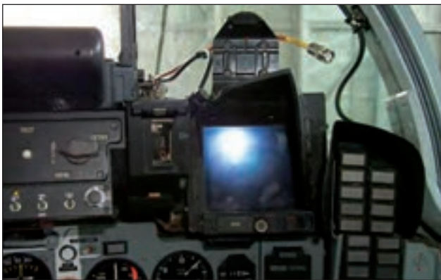
6. ábra. GPSMAP 295 műholdas navigációs rendszer beépítése MiG-29 repülőgépekbe
