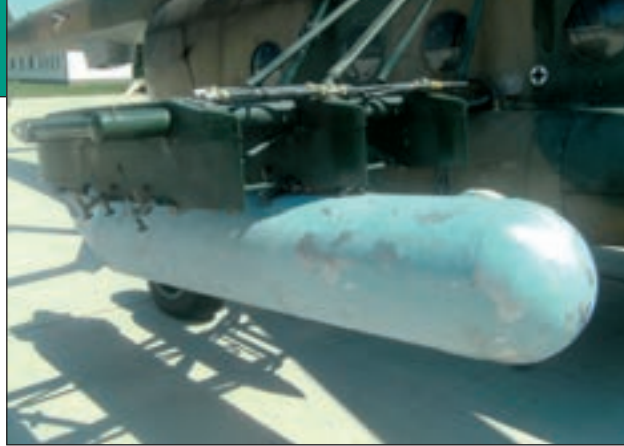
12. ábra. A póttartályok megegyeznek a Mi-24 típuson alkalmazottal. Megfigyelhető a rácstartóra szerelt tüzelő- anyag vezeték (Fotó: Sály Zoltán)
