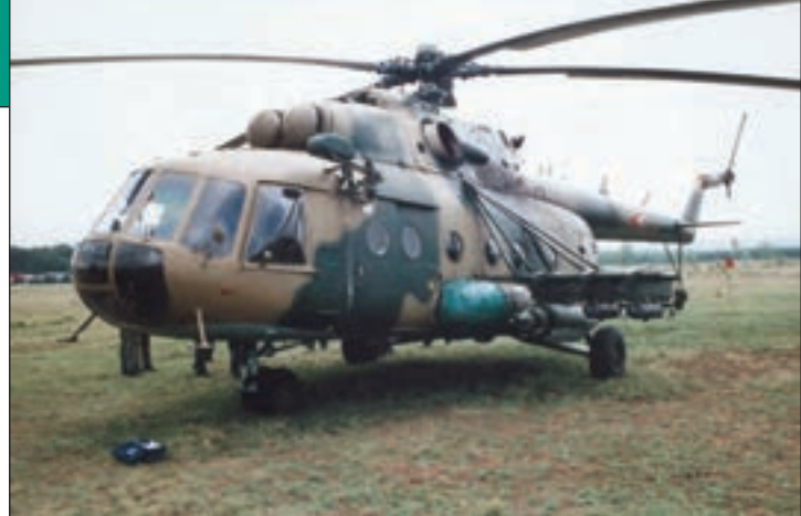
8. ábra. Mi-17 helikopter 1-1 57 mm-es rakétákat tartalmazó blokkal és 4 db bombával felfegyverezve (B.L.)
