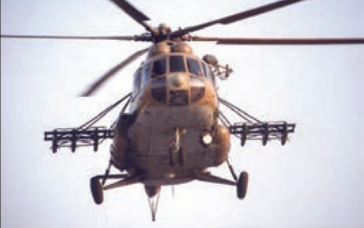
2. ábra. Mi-17 N helikopter fegyverzet és póttartályok függesztésére alkalmas tartókkal (B.L.)
