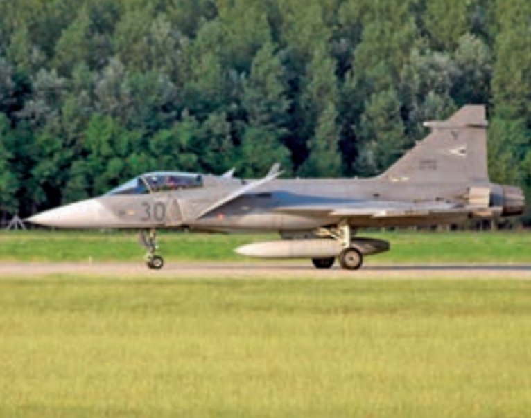
10. ábra. A Gripen 500 méteres leszállását a mellő elrendezésű vízszintes vezérsík kitérítésével érik el
