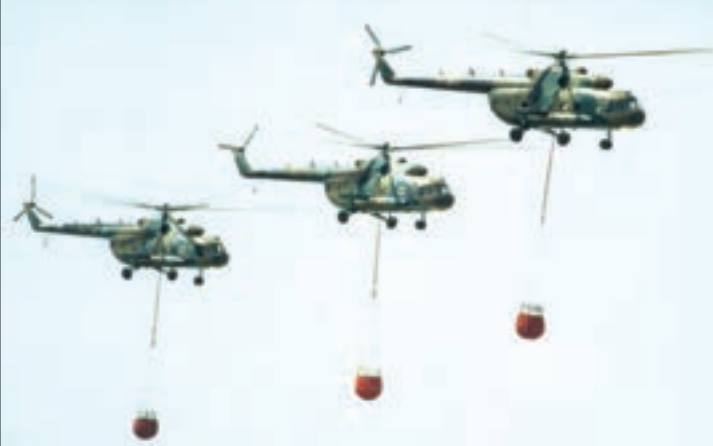
10. ábra. A Mi-17 helikopter jelentős terhelhetősége lehetővé teszi a nagy tömegű vízzel megtöltött „Bamby Bucket” tűzoltóeszköz szállítását és hatékony alkalmazását – például erdőtüzek esetén (B.L.)
