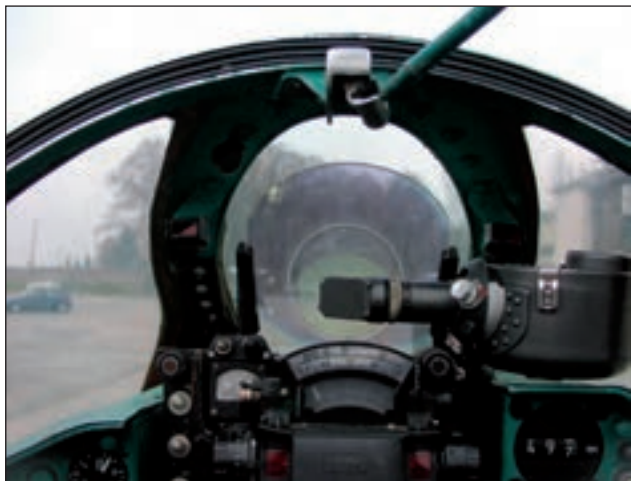
13. ábra. MiG-21bis repülőgép célzó berendezése és reflexüvege a fülkében, a páncélleveg mögött
