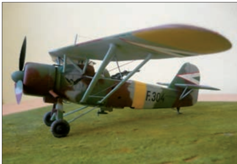
4. ábra. A felsőszárnyas monoplán kialakítás viszonylag korszerű megoldásnak bizonyult a kétfedelű gépekhez képest és jó kilátást biztosított a felderítő feladatok során
