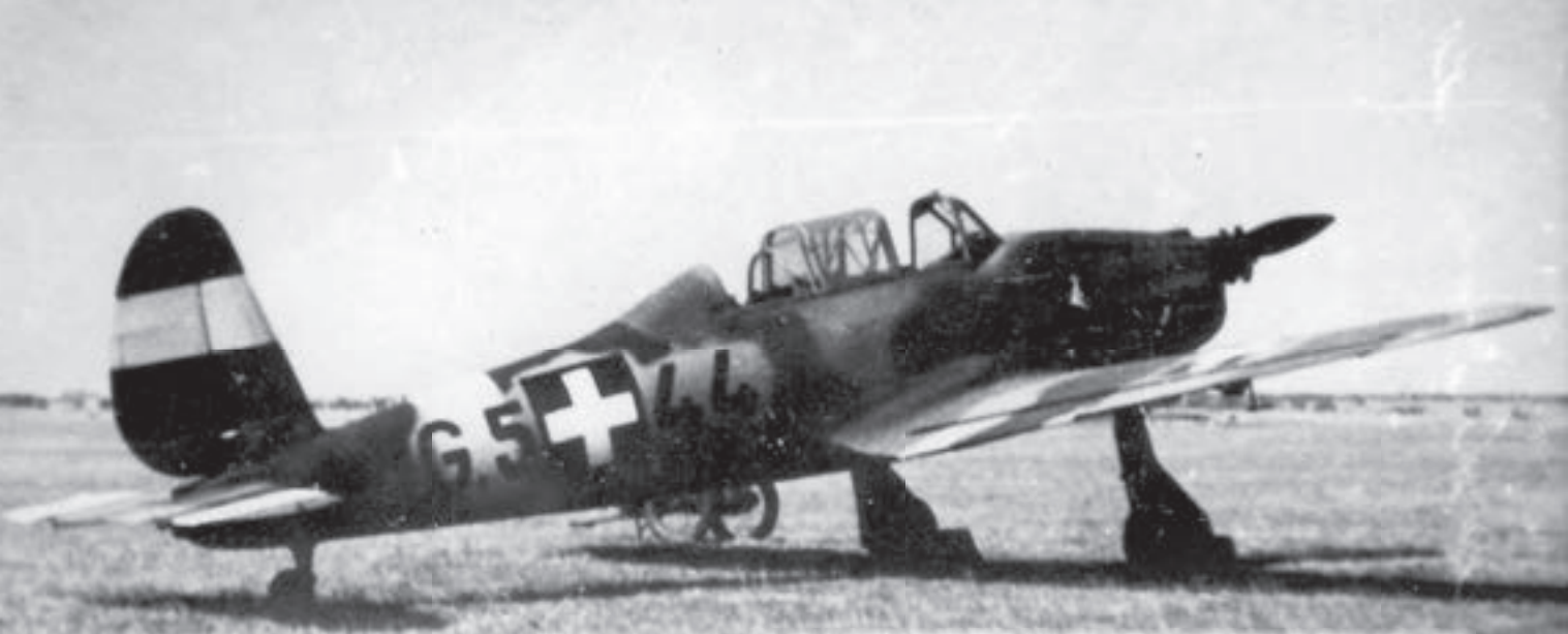
1. ábra. Arado Ar 96B kiképző és gyakorló repülőgép, amely a vadászpilóta előképzésben jutott jelentős szerephez
