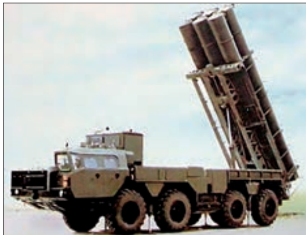
30. ábra. Reljeft partvédelmi rendszer, robotrepülőgép 9V2413 szállító-indító járműve
