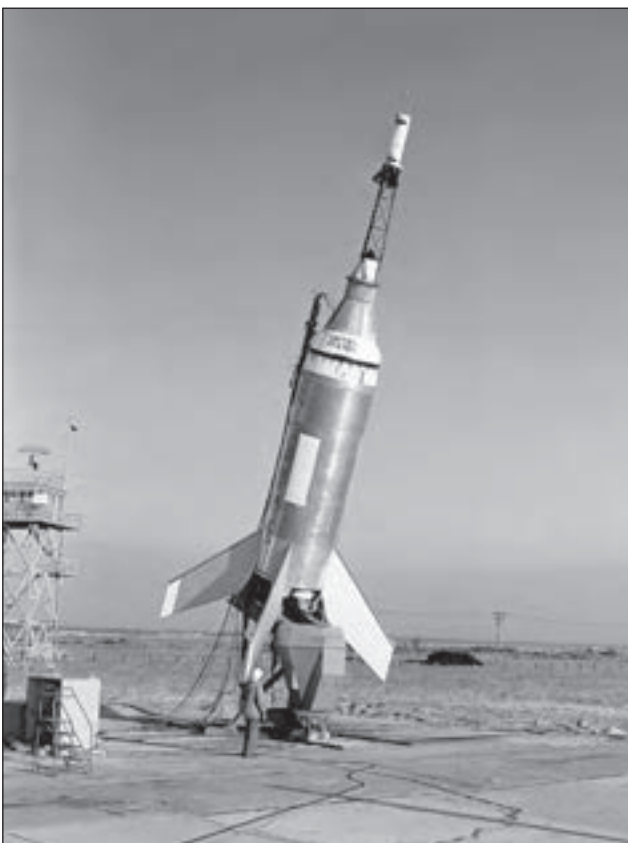
3. ábra. A fejlesztési kísérletekhez használt Little Joe-1 rakéta, tetején egy Mercury BP (boilerplate) űrkabinnal
