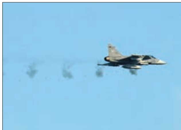
19. ábra. Magyar Gripen harci repülőgép 27 mm-es Mauser géppályáját működteti (B.L.)
