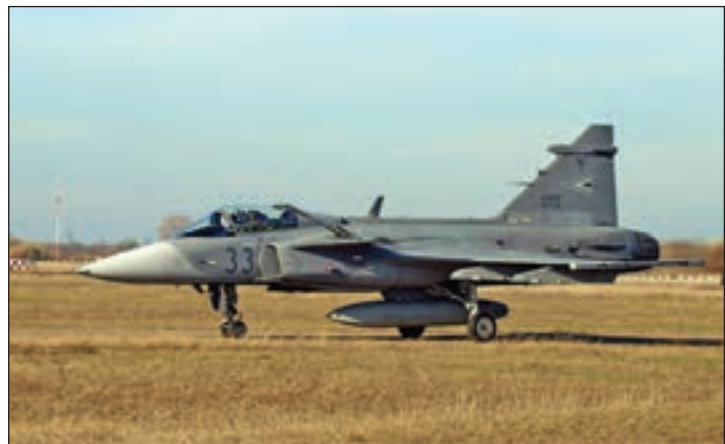
20. ábra. A szárnytőben jól látszik a Gripen kinti helyzetben lévő üzemenyag utántöltő csonkja (B.L.)
