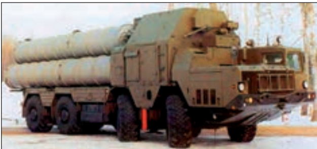
19. ábra. Sz-300PMU légvédelmi rakétarendszer 5P85 szállító-indító jármű
