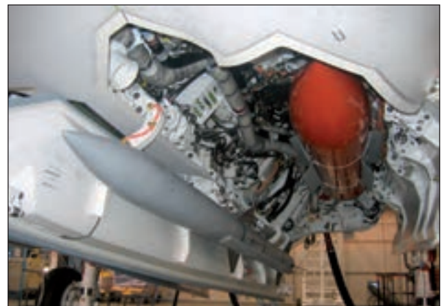
27. ábra. Az F-35A bombatere, az 5. függesztési ponton egy AIM-120, a 6-dikon pedig egy 2000 fontos légibomba
