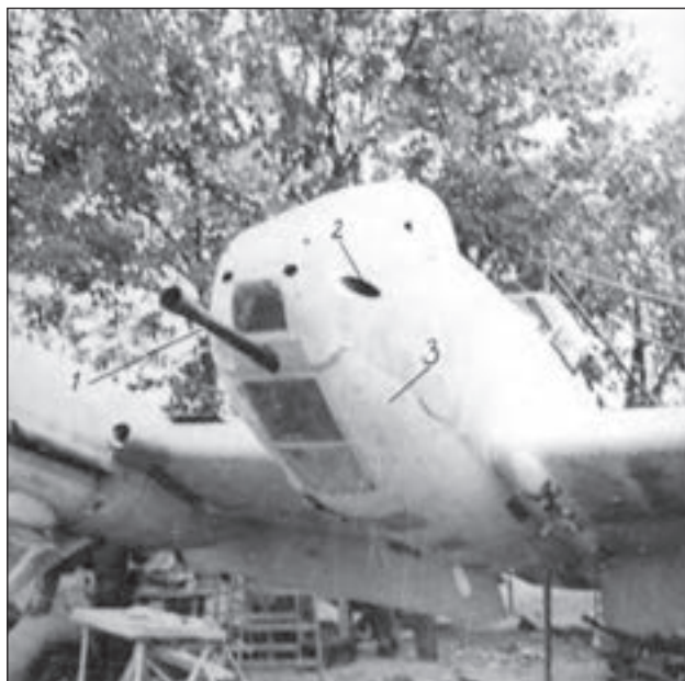
9. ábra. A 40 mm-es Bofors gépágyú beépítése az orrban előlről a kísérleti Me 210-esen. Jelmagyarázat: 1. 40 mm-es gépágyú; 2. a bal oldali 20 mm-es gépágyú; 3. átalakított lövésztekő a közelfelderítő változathoz (S.Gy.)
