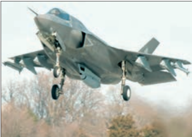
24. ábra. Egy F-35B a törzse alatt a GAU-22/A gépágyúkonténerrel és két AIM-9X makettel a szárnyai alatt (LM)
