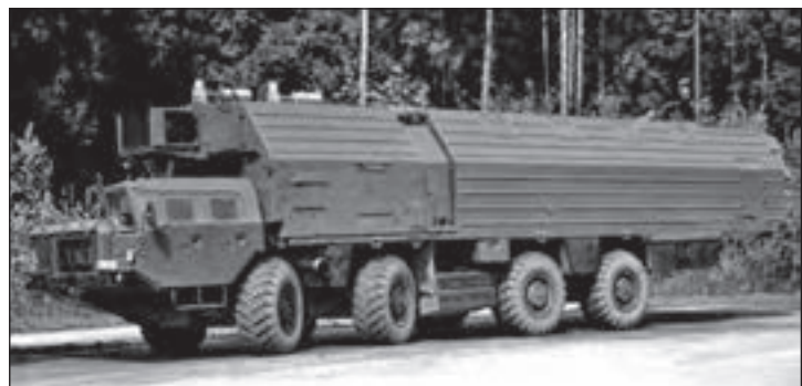
13. ábra. MAZ–543M jármű 7903 típusú zárt felépítménnyel a hadászati rakétaerők (RVSzN) számára
