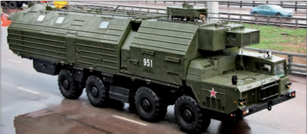
18. ábra. 15Ja55 őrző-védő szakasz ügyeleti jármű MAZ-543M alvázon
