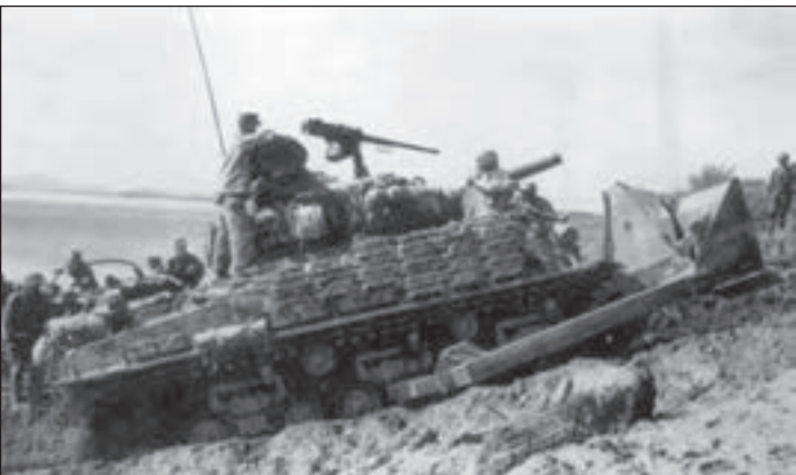
17. ábra. Tolólapal ellátott harckocsi, a koreai harcok fontos eszköze
