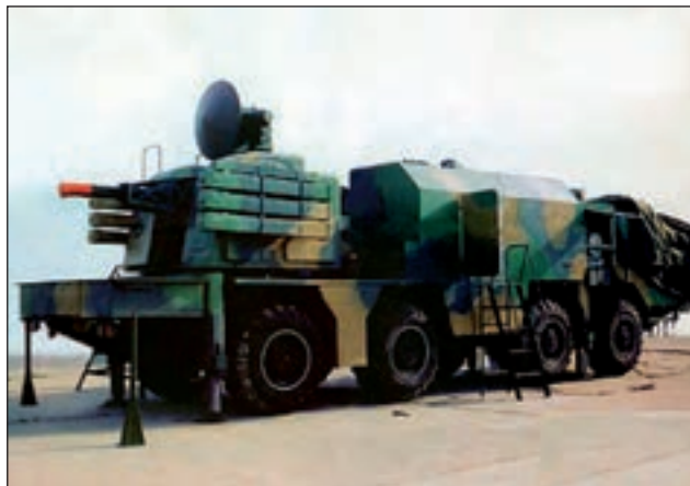
32. ábra. LD–2000-es pontlégvédelmi rendszer, WS–2400-es járműre telepítve
