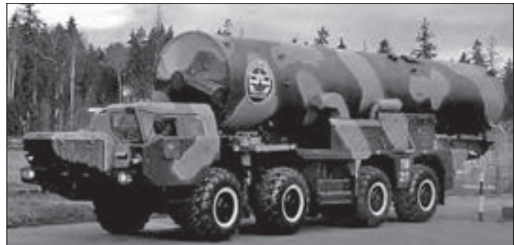
21. ábra. A-135 ellenrakéta-rendszer, 5T93 rakéta konténerszállító jármű
