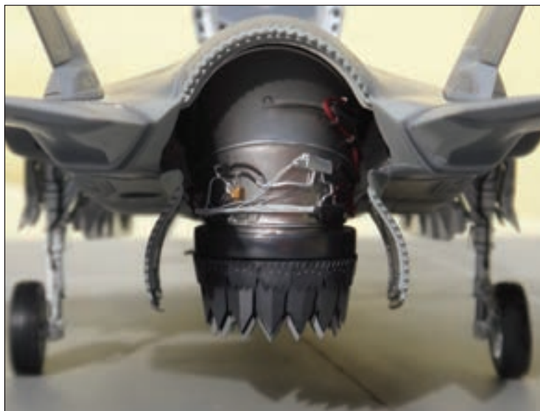
32. ábra. Az F-35 B farokrésze és felszálló helyzetbe állított fúvócsőve (Makett: Szrna István)
