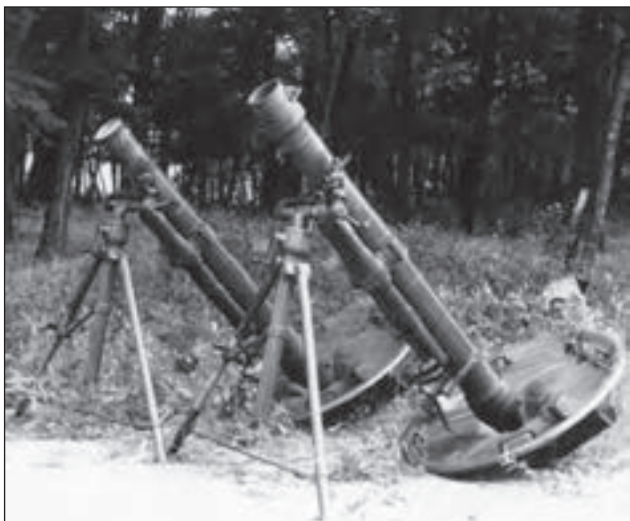
9. ábra. 120 mm-es 43M aknavető
