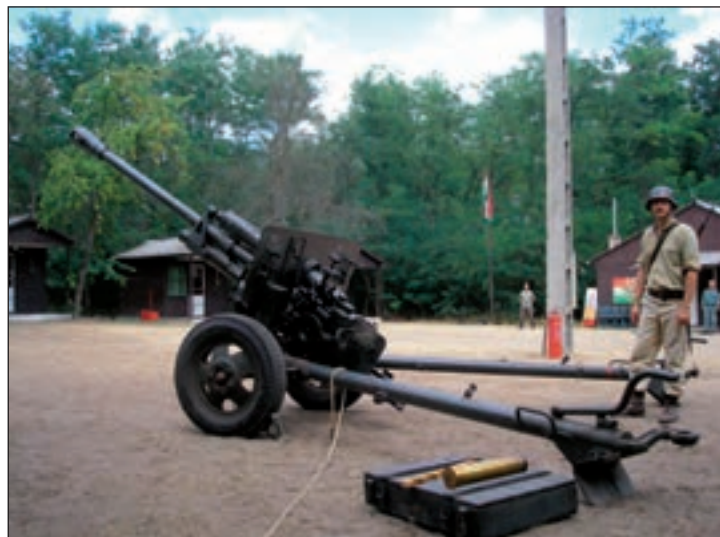
4. ábra. 76 mm-es 42M ZiS-3 páncéltörő ágyú. Maximális lőtávolság 12 200 m, löszere egyesített, egy javadalmazás 140 db. Páncél átütőképessége 90°-on 500 m-ig 75 mm, 1000 m-ig 67 mm. Önsúlya 1160 kg. Vontatása gépjárművel, vagy 6 lovas lövegmozdonnyal. Hazánkban a DIMÁVAG 48M jelzéssel gyártotta. Rendszerben 1948-tól
