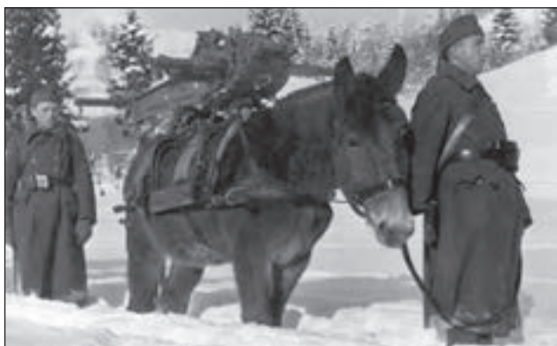
4. ábra. 15M 7,5 cm-es hegyiágyú elülső lövegtalpa öszvérré málházva
