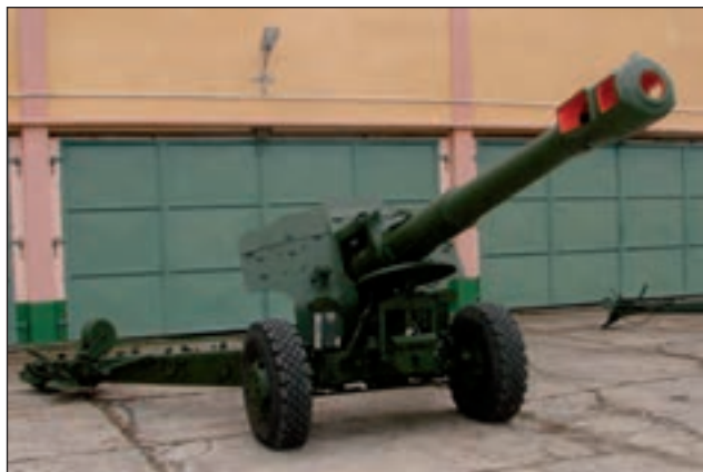
9. ábra. 152 mm-es D-20 ágyútarack. Maximális lőtávolsága 17 400 m. Lőszere osztott, egy javadalmazás 60 db. Önsúlya 5650 kg, menete lánctalpas gépjárművel vontatva. Rendszerben 1974-től
