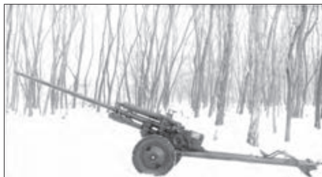
2. ábra. 57 mm-es 43M páncéltörő ágyú
