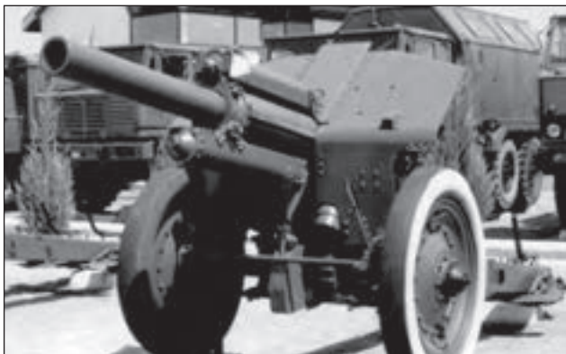
5. ábra. 122 mm-es 38M tarack. Maximális lőtávolsága 11 800 m. Lőszere osztott, egy javadalmazás 80 db. Önsúlya 2450 kg, vontatása gépjárművel történt. Hazánkban a DIMÁVAG 48M jelzéssel gyártotta. Rendszerben: 1948-tól
