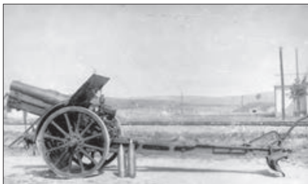
3. ábra. 1914M 15 cm-es fogatolt közepes tarack, az 1930-as évek elején korszerűsített repesz- és rombológránátokkal
