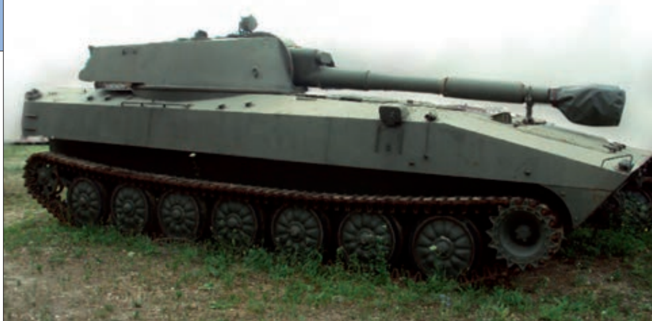
10. ábra. 122 mm-es 2S21 Gvozdika önjárá tarack. Maximális lőtávolsága 15 300 m. Lőszere osztott, egy javadalmazás 40 db. Önsúlya 15 650 kg. Rendszerben 1971-től, 1980-tól kiegészítve az 1V12 „MASINA” tűzvezetési komplexummal
