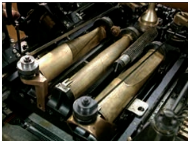
5. ábra. A három ballisztikai test, és azok mozgató szerkezete
