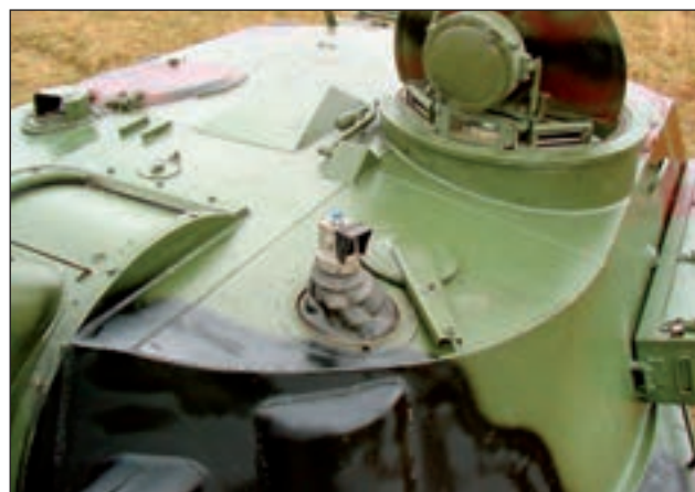
3. ábra. A forgatható torony a forgózsámollyal és a farrész a löszertartóval alkotja a küzdőteret
