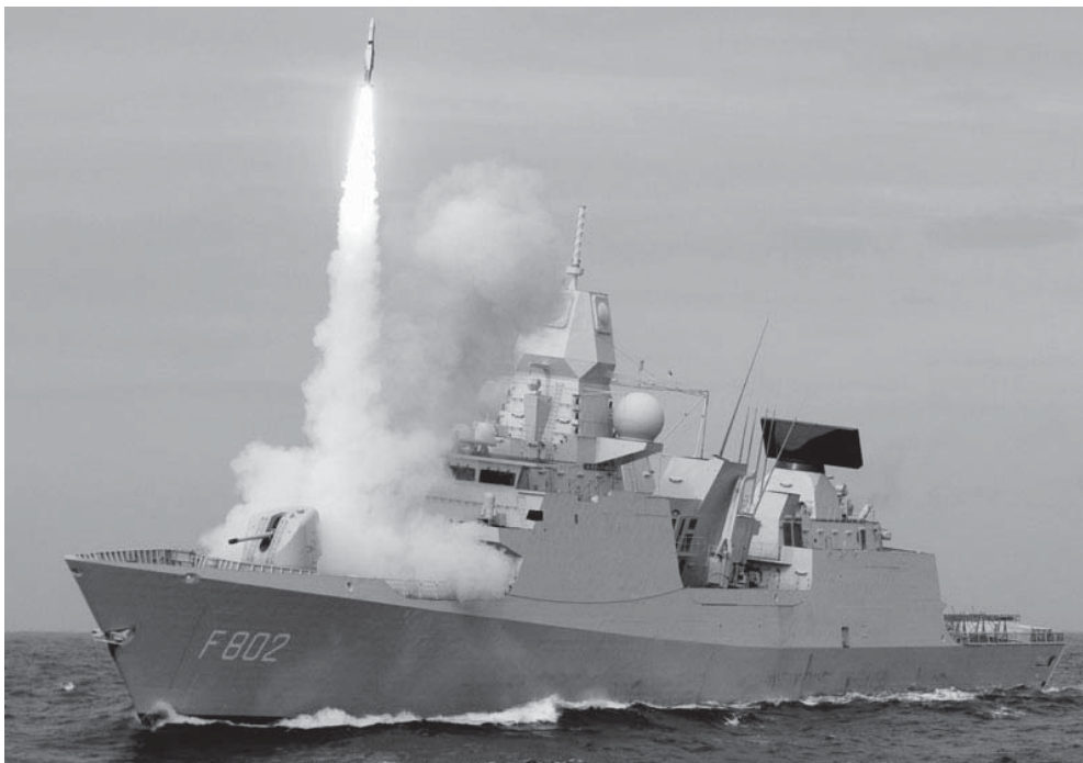
A holland De Zeven Provinciën (F 802) fregatt légvédelmi lövészetet. A felvételen jól kivehető a hátul elhelyezkedő SMART-L, míg a hajó tetején található APAR radar-berendezés
