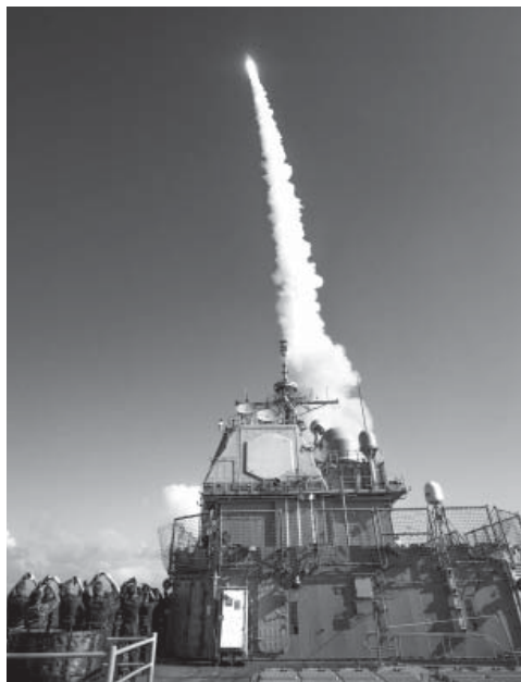
SM-3 Block IA elfogórakétát indít a USS Lake Erie (CG-70). Az Aegis BMD rendszerrel felszerelt rakétacirkáló elejében jól látható a rendszer SPY-1 radarberendezésének antennája
