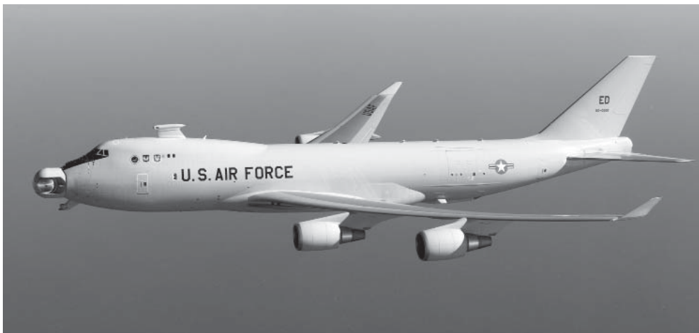
YAL-1 repülőgép fedélzetre telepített lézer. Az átalakított Boeing 747 orrkúpjában jól látható a kémiai lézerberendezés sugárvetítő egysége
