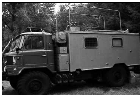
12. ábra. R-142 rádióállomás telepített zenit-antennával [20]
