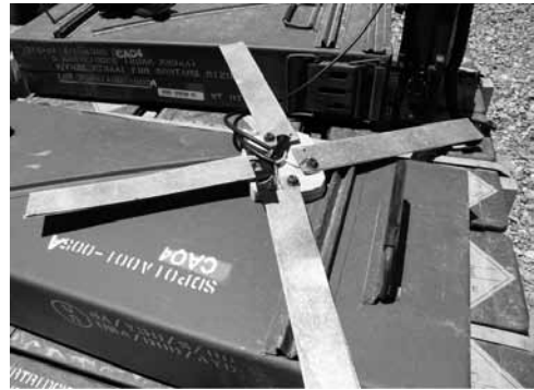
18. ábra. Az ad-hoc műholdas antenna reflektáló felület alkalmazásával 56
