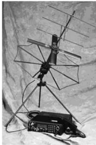
7. ábra. DAMA üzemmódra tervezett műholdas antenna AN/PSC-5 rádióterminállal [14]
