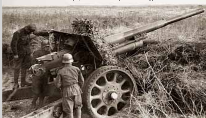
1931M 10,5 centiméteres, gépvontatású közepes tábori ágyú tüzelőállásban.
