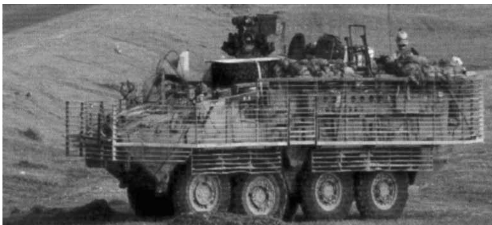
STRYKER pótlólagosan hozzáépített lécz-páncélzattal (lécz vértézettel)
