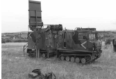
13. ábra. „ARTHUR” tűzeszköz felderítő lokátor digitális rádióval továbbította a felderítési adatokat a Műveleti Reagáló Központba
